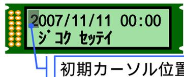
変更したい日時にカーソル位置を合わせます。カーソル移動はSW2, SW3の押下で移動します。カーソル位置を合わせたらSW4, SW5で数字を上下させます。時間は24時間制で設定してください。
