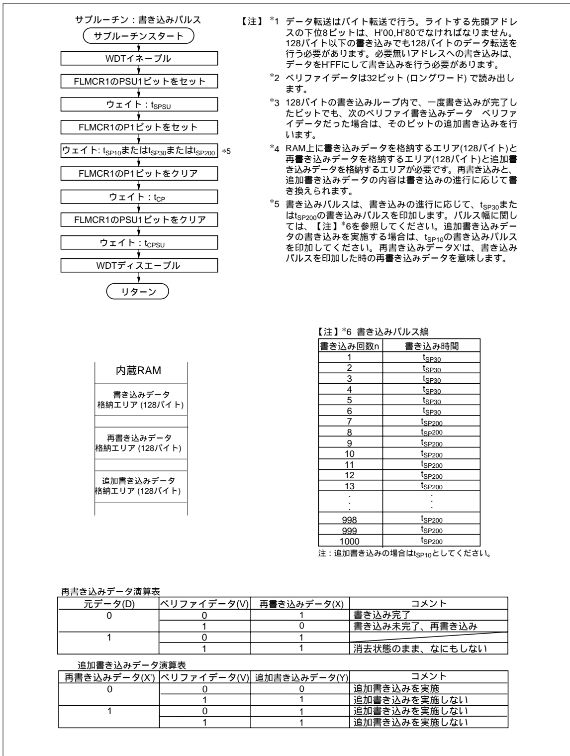
図 20.14 プログラム / プログラムベリファイフロー ( 2 )
