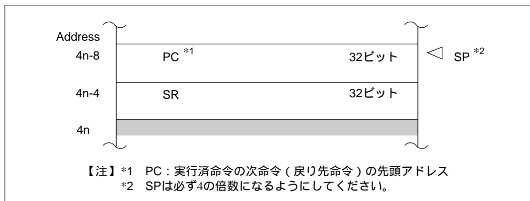
図 6.3 割り込み例外処理終了後のスタック状態
