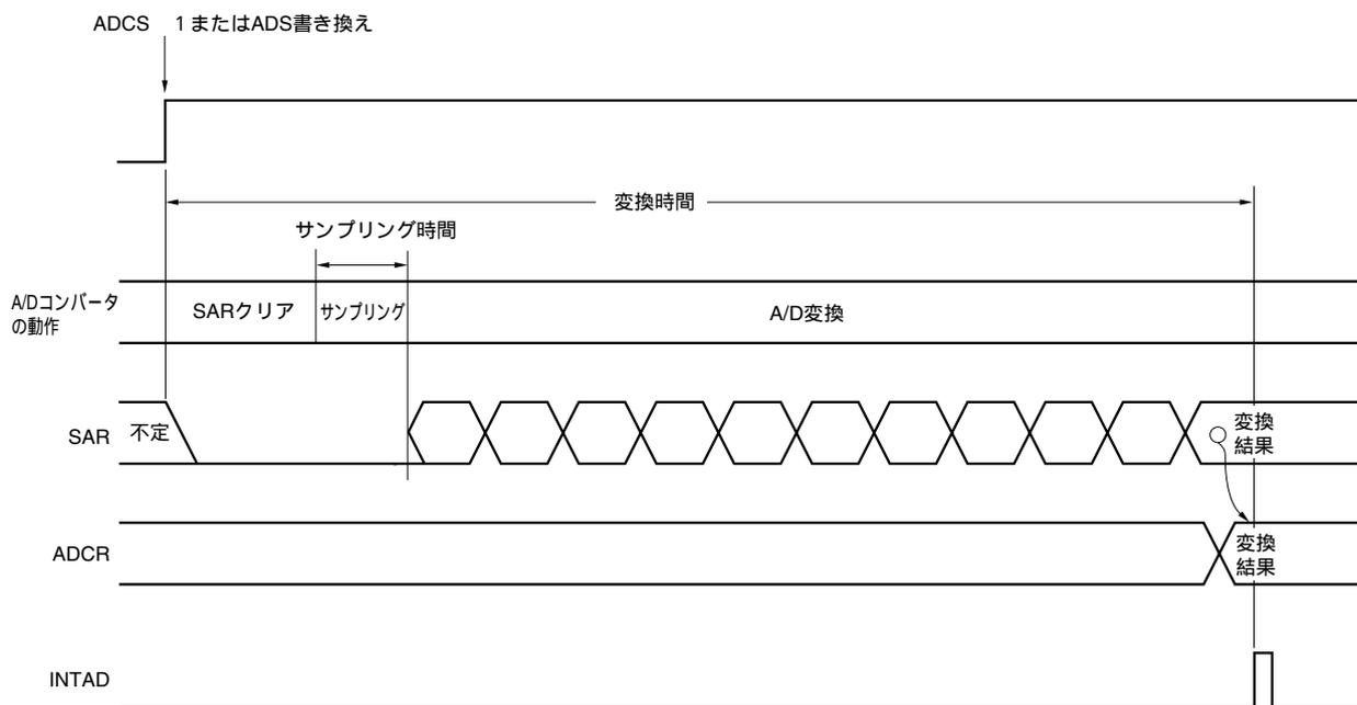
A/D変換動作は、ソフトウェアによりA/Dコンバータ・モード・レジスタ (ADM) のビット7 (ADCS) をリセット (0) するまで連続的に行われます。
