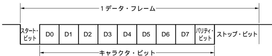
1データ・フレームは次に示すビットで構成されています。
