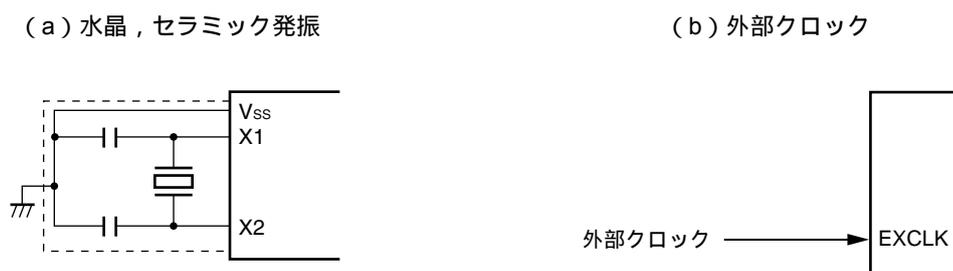
**注意** X1発振回路を使用する場合は、配線容量などの影響を避けるために、図6-9の破線の部分を次のように配線してください。
