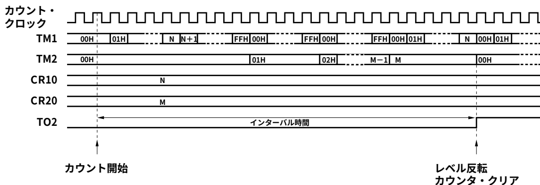
★ 図7-13 方形波出力動作のタイミング
