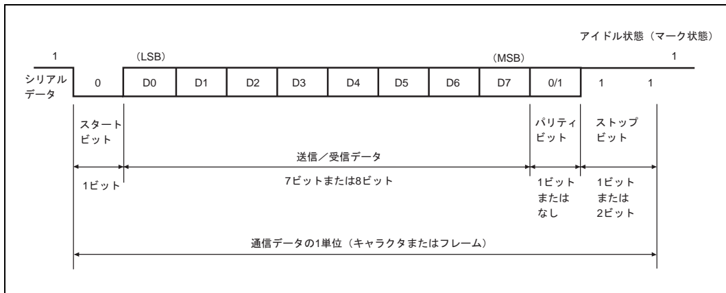
図 14.3 調歩同期式通信のデータフォーマット (8 ビットデータ / パリティあり / 2 ストップビット / LSB ファーストの例)
