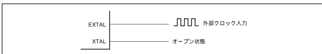
図 5.4 外部クロックの接続例
