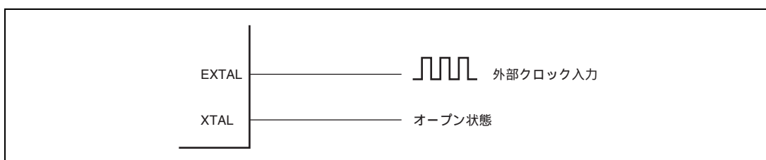
図 4.4 外部クロックの接続例
