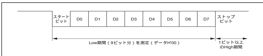
図 17.7 SCI ビットレートの自動合わせ込み動作
