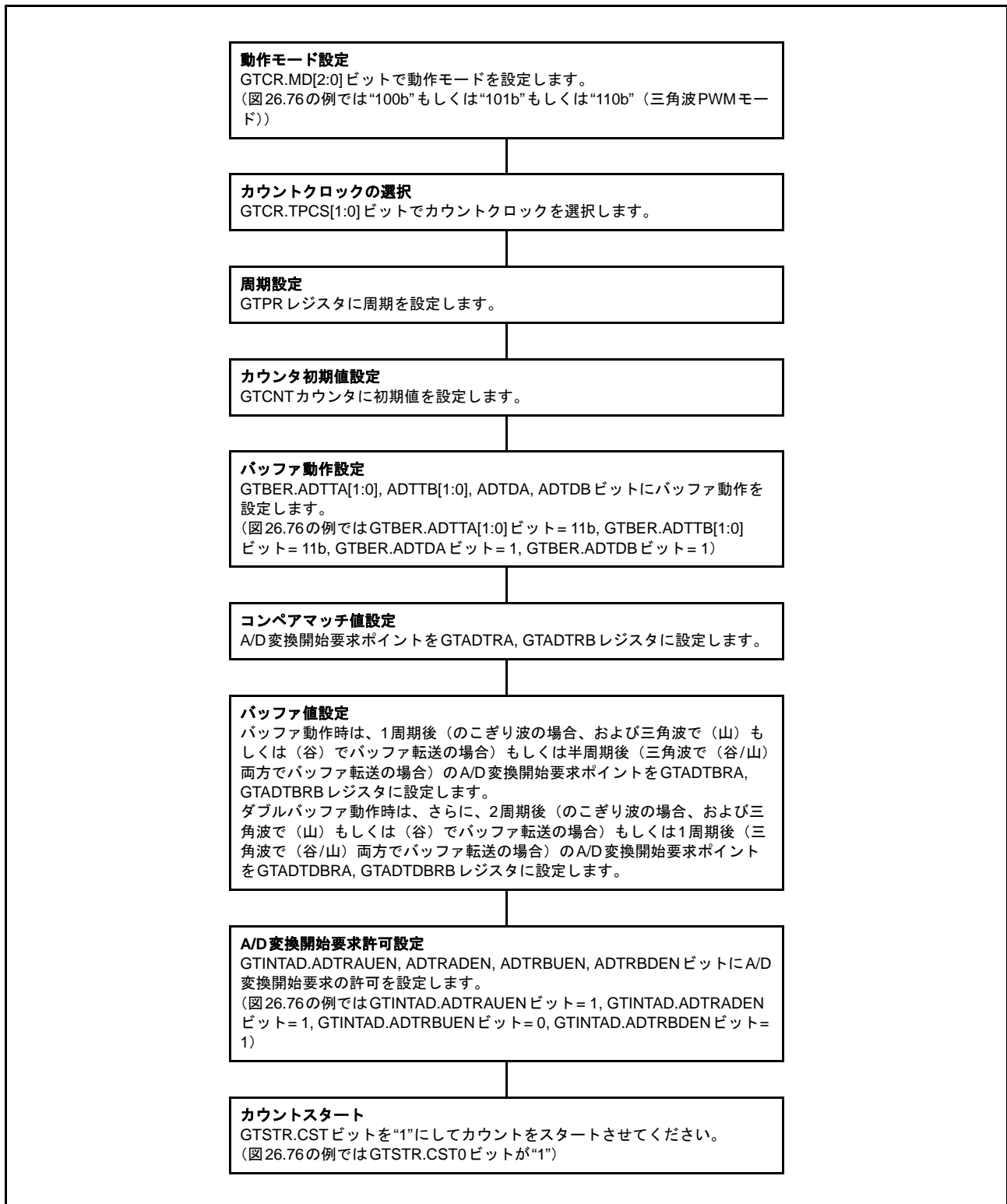
図 26.77 A/D 変換開始要求タイミング動作設定例
