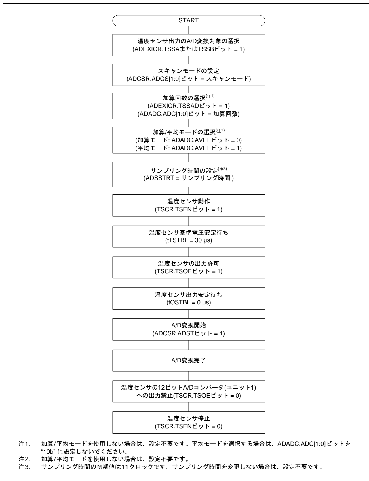
図 51.3 温度センサの使用手順フロー
