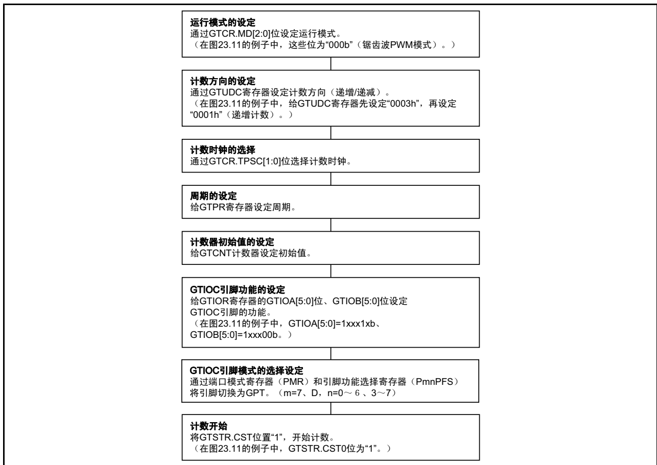
图 23.12 输入捕捉运行的设定例子
