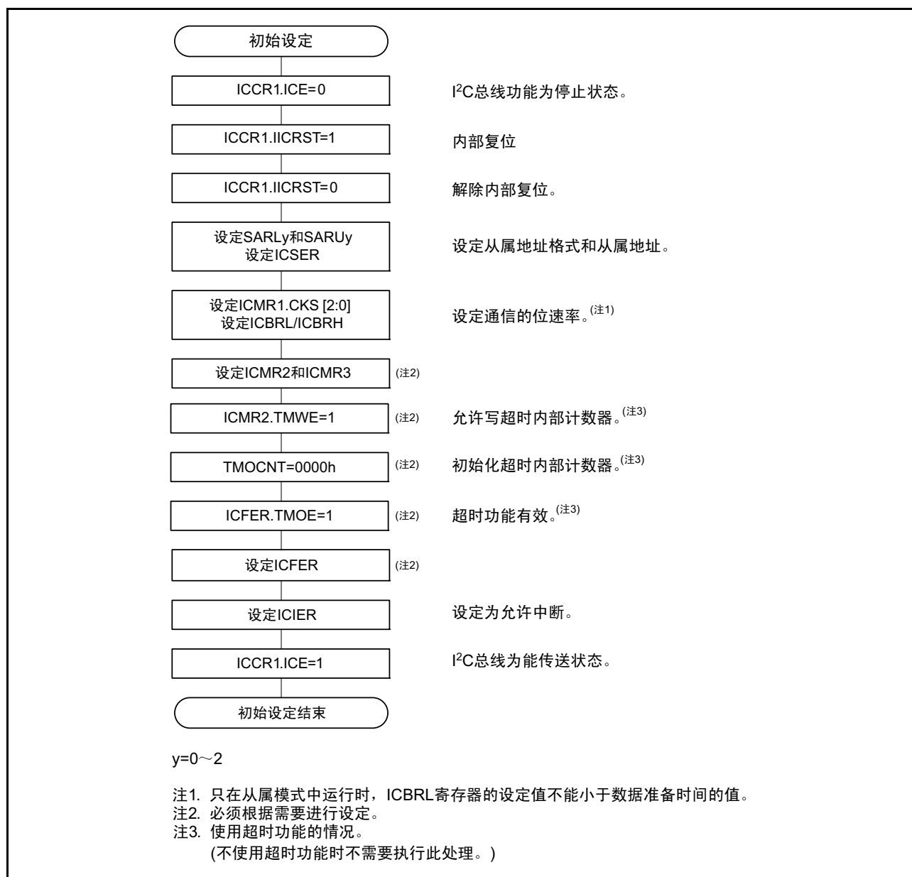
图 28.5 RIIC 的初始化流程图例子
