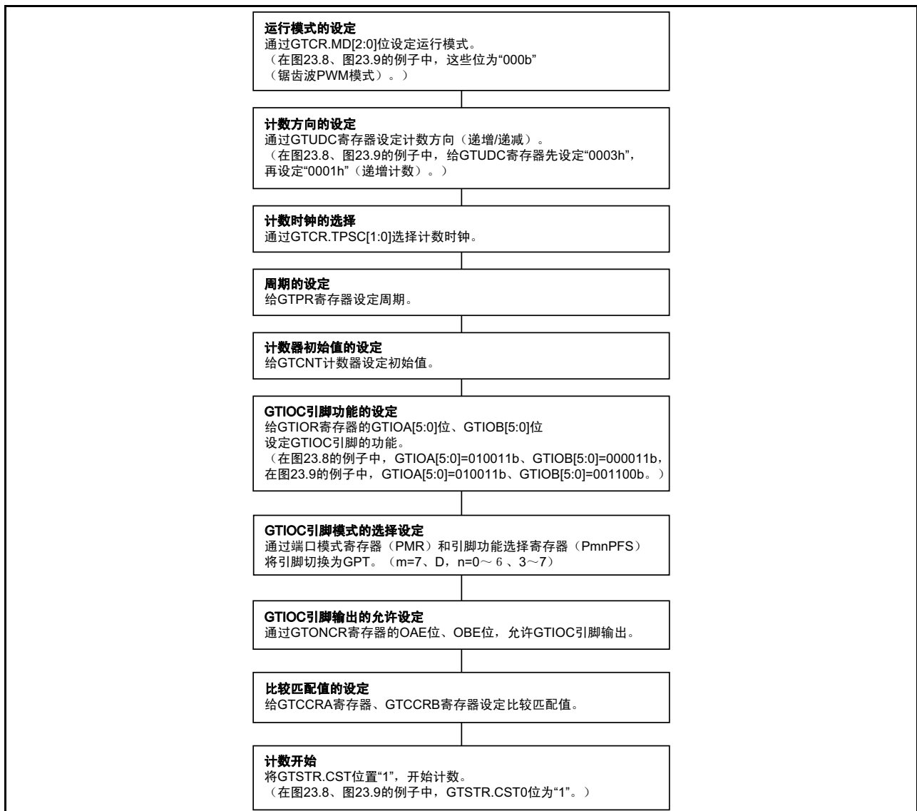
图 23.10 交替输出运行的设定例子
