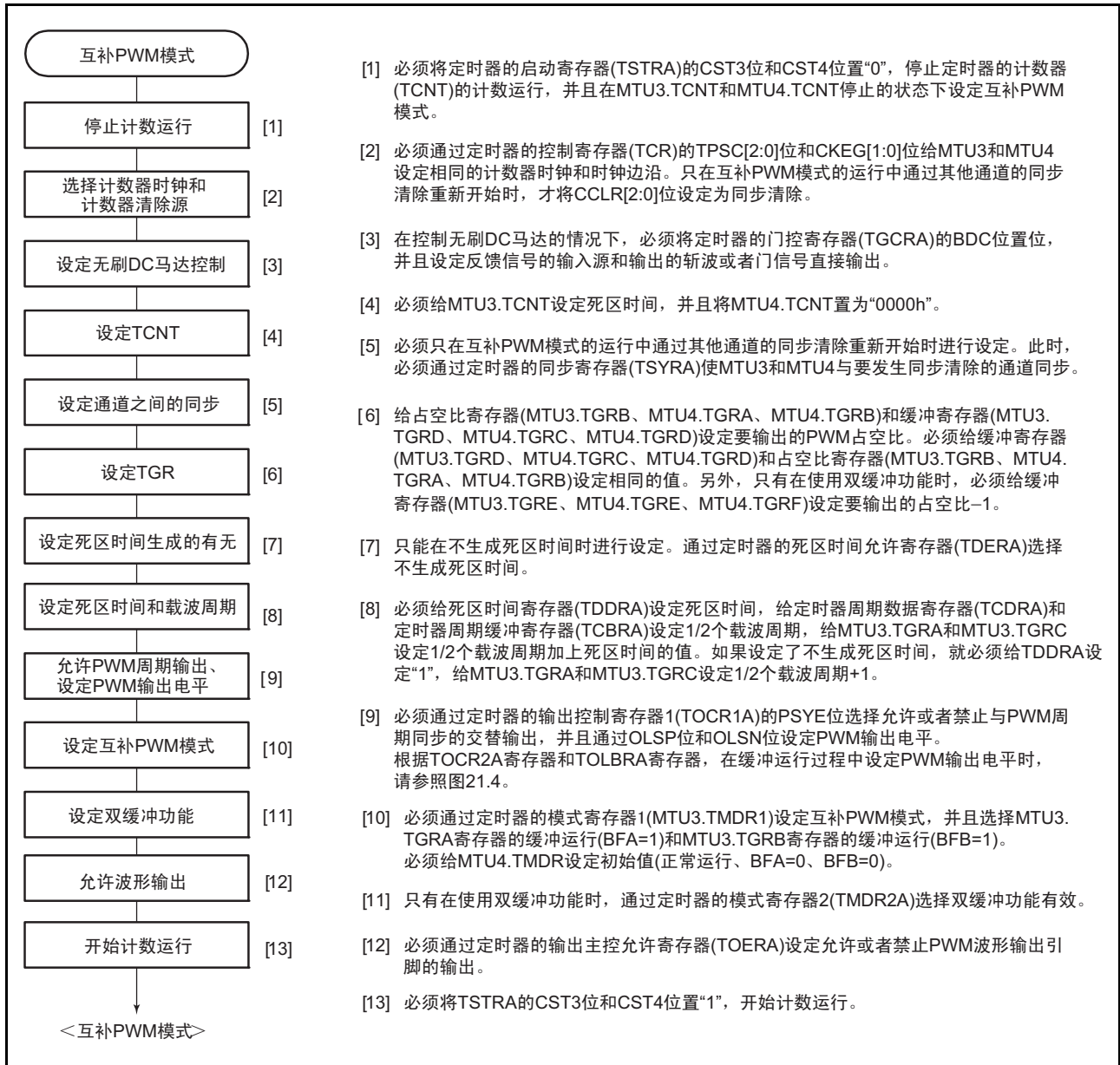
图 21.39 互补 PWM 模式的设定步骤例子
