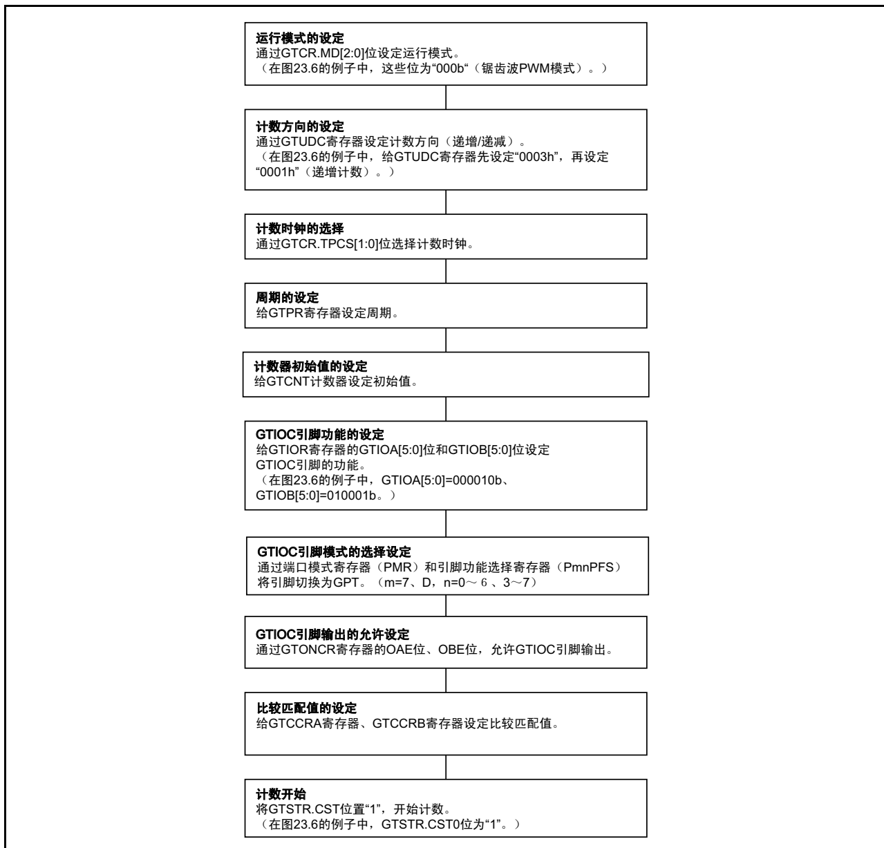
图 23.7 Low 电平输出 /High 电平输出运行的设定例子
