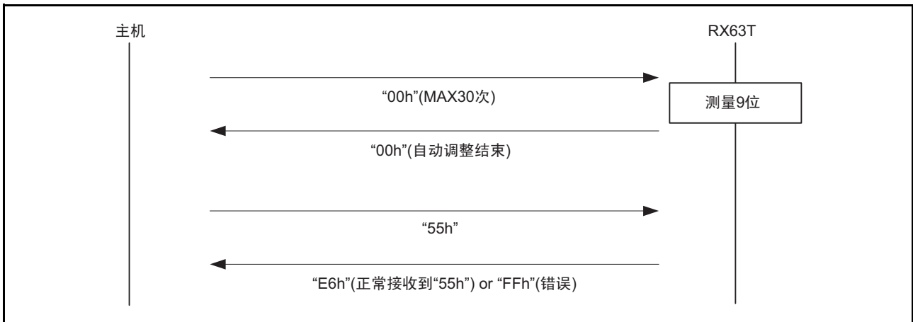
图 34.26 主机和 RX63T 之间的通信顺序
