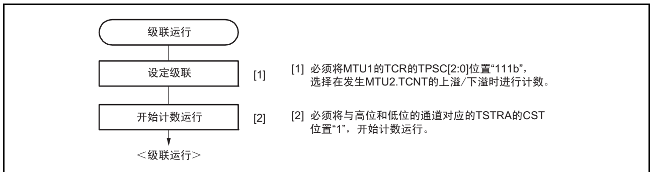
图 21.21 级联运行的设定步骤例子
