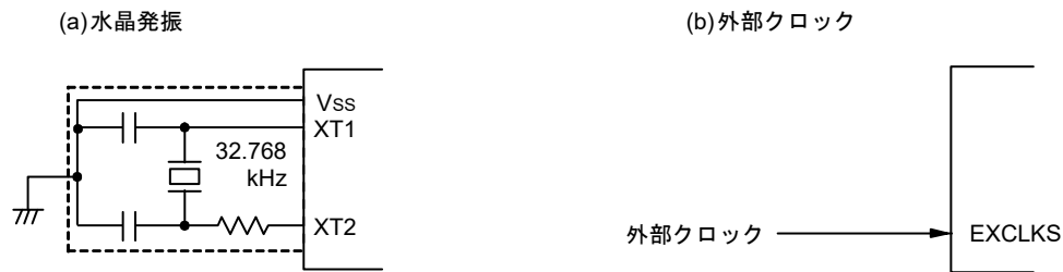
図5 - 17 XT1発振回路の外付け回路例
