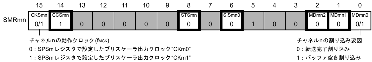
図 19 - 81 スレーブセレクト入力機能(CSI00)のスレーブ送信時のレジスタ設定内容例(1/2)
