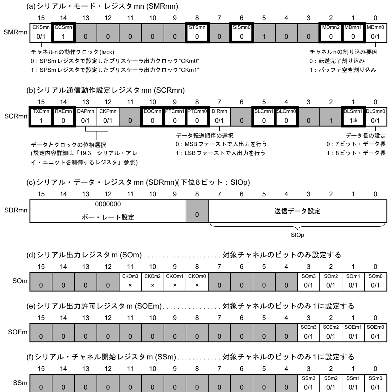
図19 - 52 簡易SPI (CSI00, CSI01, CSI10, CSI11, CSI20, CSI21)のスレーブ送信時のレジスタ設定内容例
