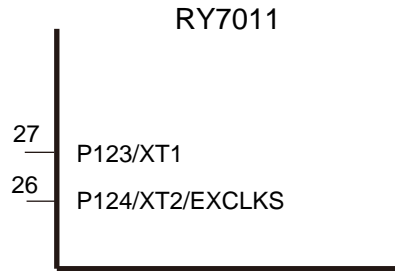
図6-5 オンチップ・オシレータを使用する場合のXT1, XT2/EXCLKS端子の処理 ※
