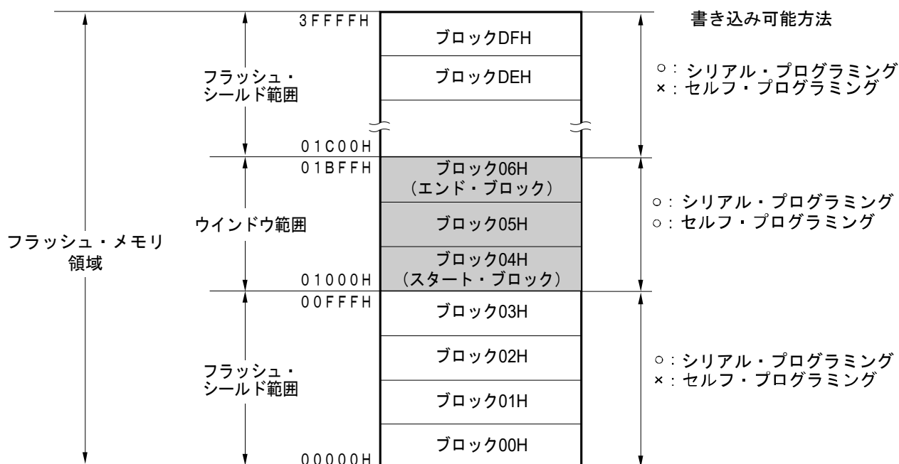
図3-11 フラッシュ・シールド・ウィンドウの設定例 (スタート・ブロック : 04H、エンド・ブロック : 06Hの場合)
