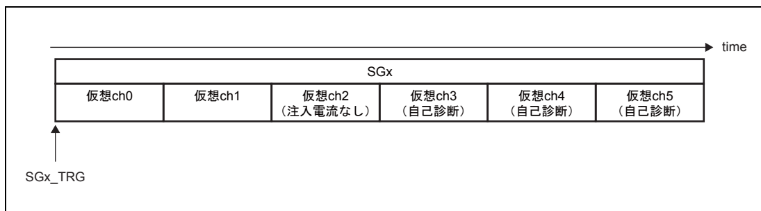
図 26.16 同 SG 内で A/D 変換と A/D 変換回路自己診断を行う場合の設定例
