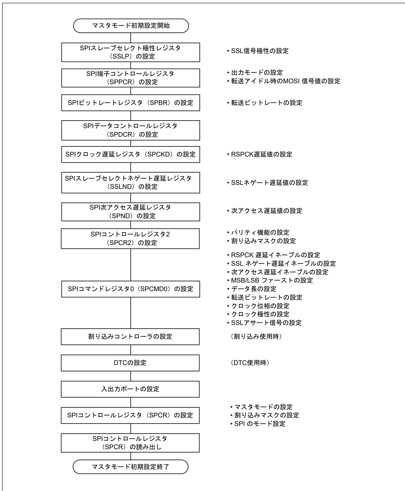
図 26.30 マスタモード時の SPI 動作の初期化フロー例
