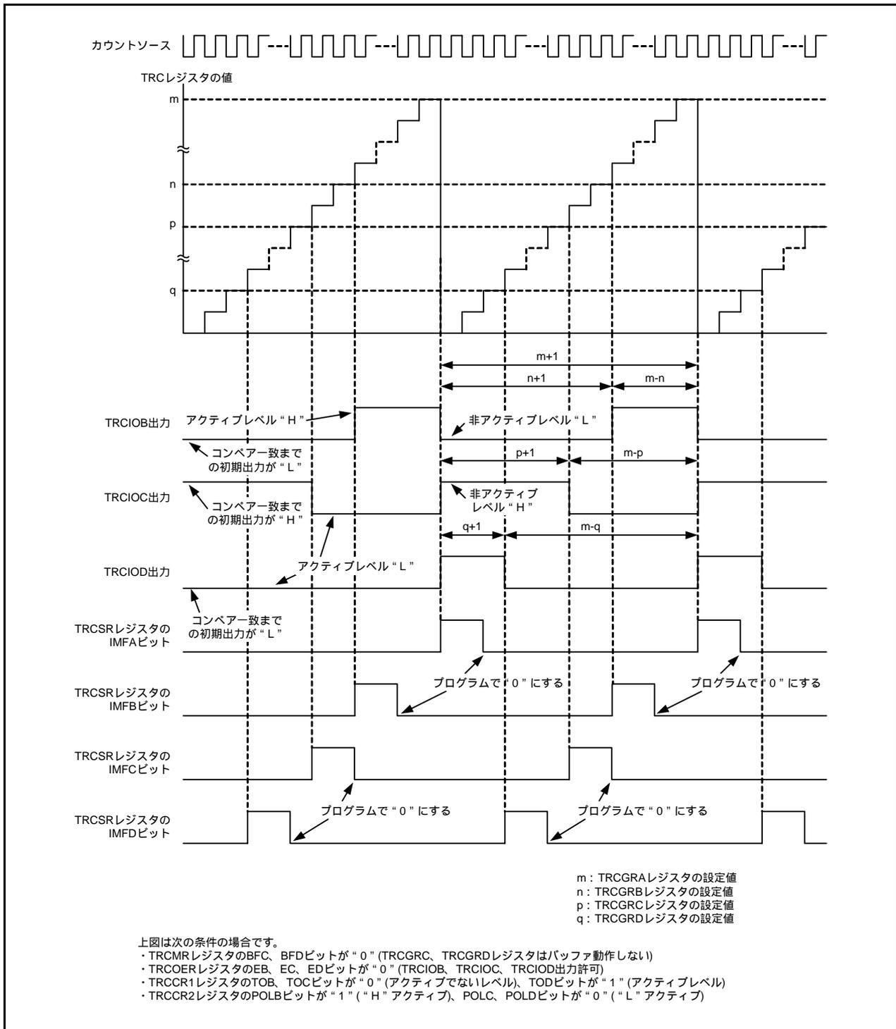
図 18.14 PWMモードの動作例
