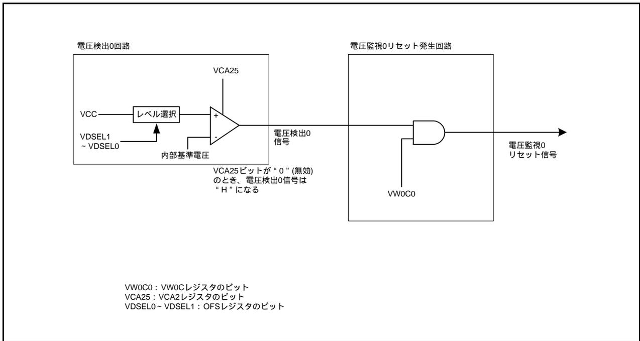
図6.2 電圧監視0リセット発生回路のブロック図
