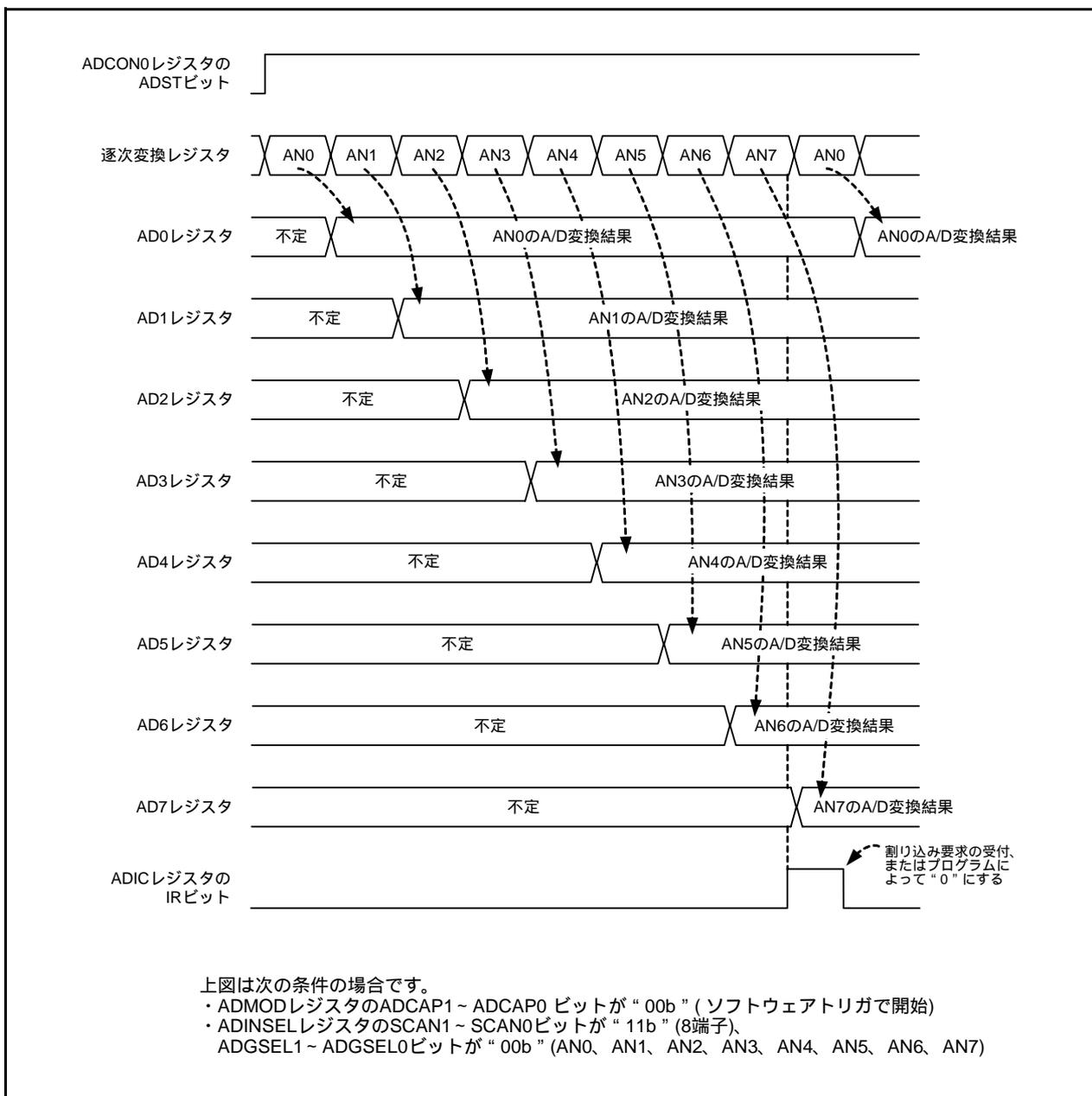
図22.9 繰り返し掃引モード時の動作例
