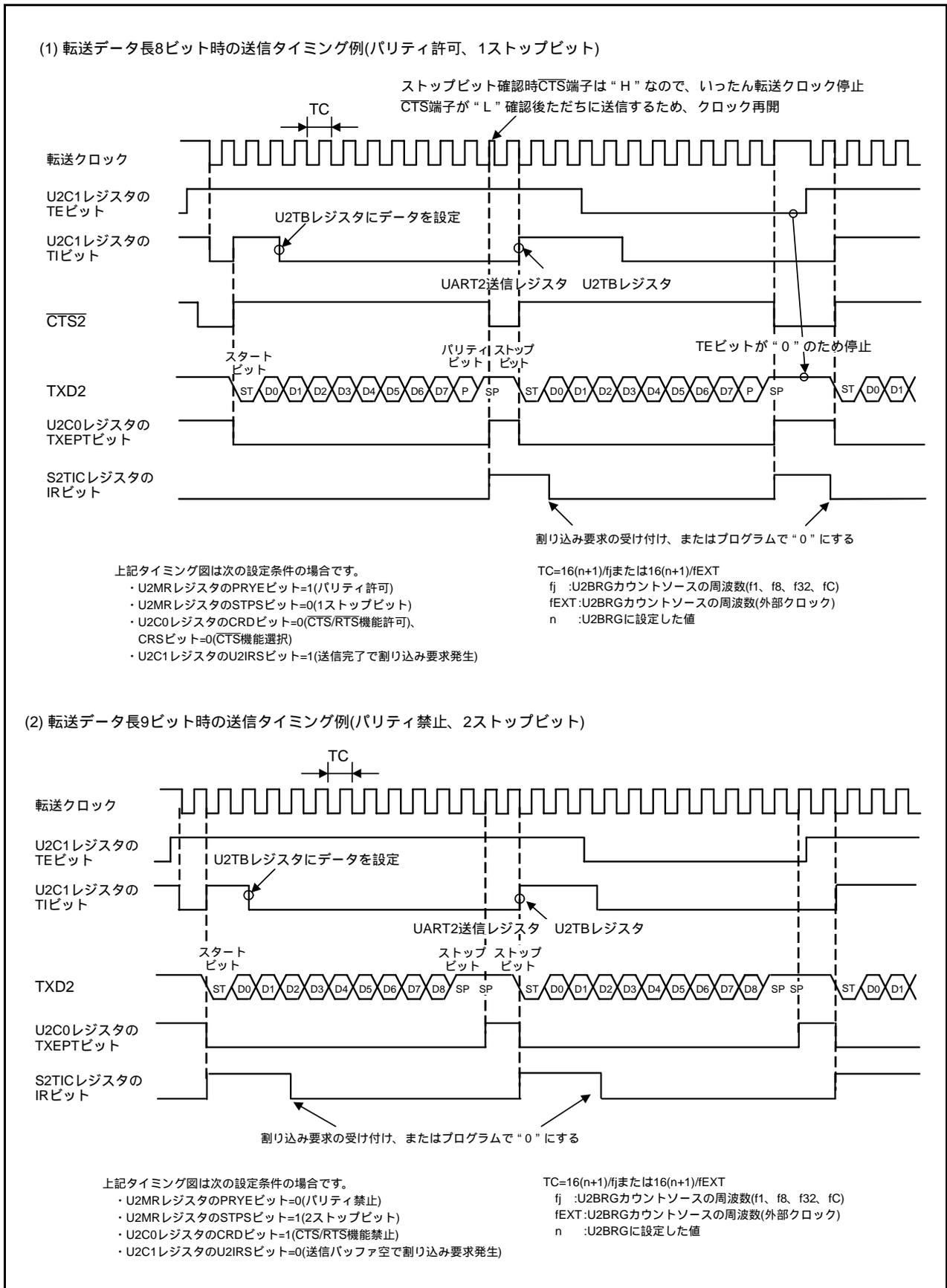
図21.7 UARTモード時の送信タイミング例
