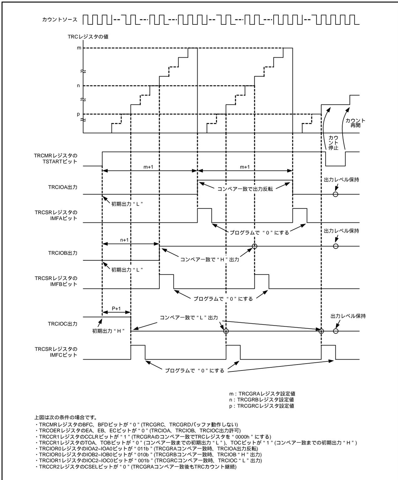
図 18.10 アウトプットコンパレー機能の動作例
