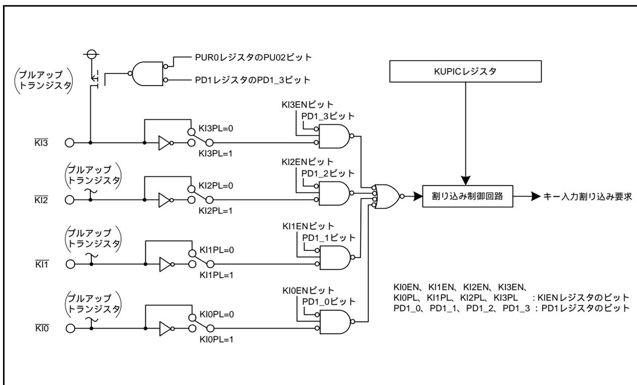
図11.11 キー入力割り込みのブロック図
