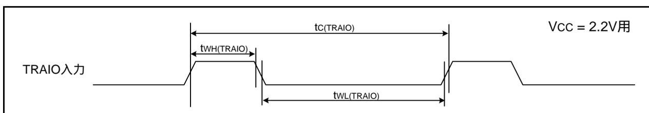
図26.13  $V_{CC} = 2.2V$ 時のTRAIO入力タイミング
