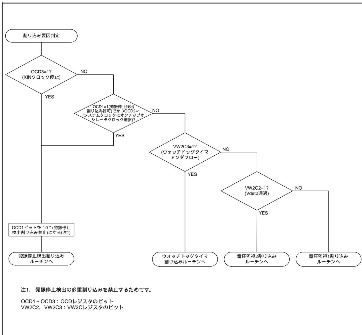
図9.11 発振停止検出割り込み、ウォッチドッグタイマ割り込み、電圧監視1割り込みまたは電圧監視2割り込みの割り込み要因判別方法例
