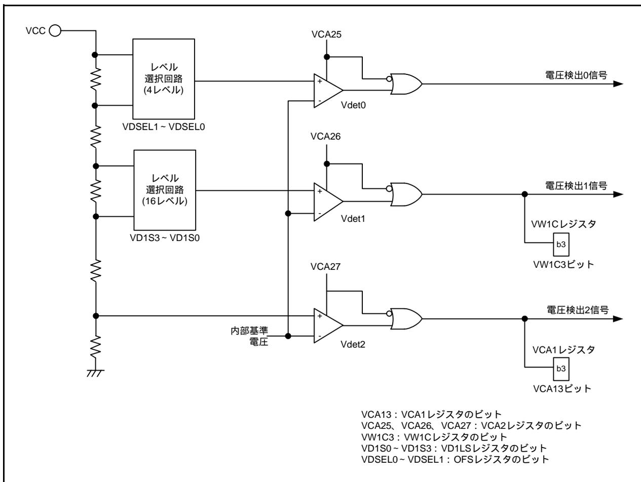
図6.1 電圧検出回路ブロック図
