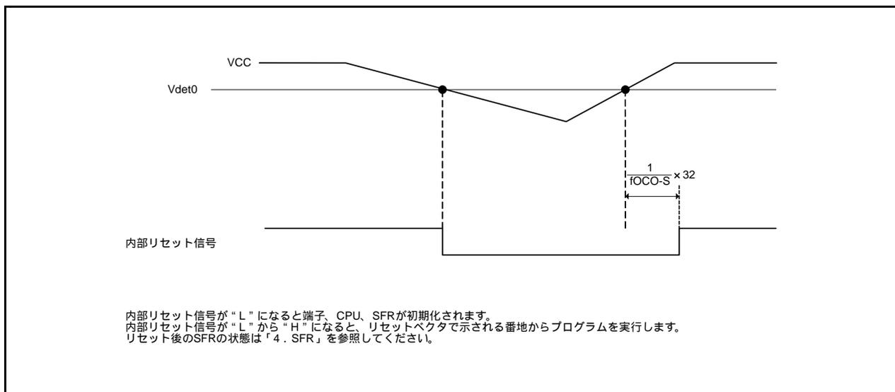
図6.5 電圧監視0リセット動作例
