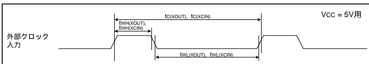
図26.4  $V_{CC} = 5V$ 時の外部クロック入力タイミング
