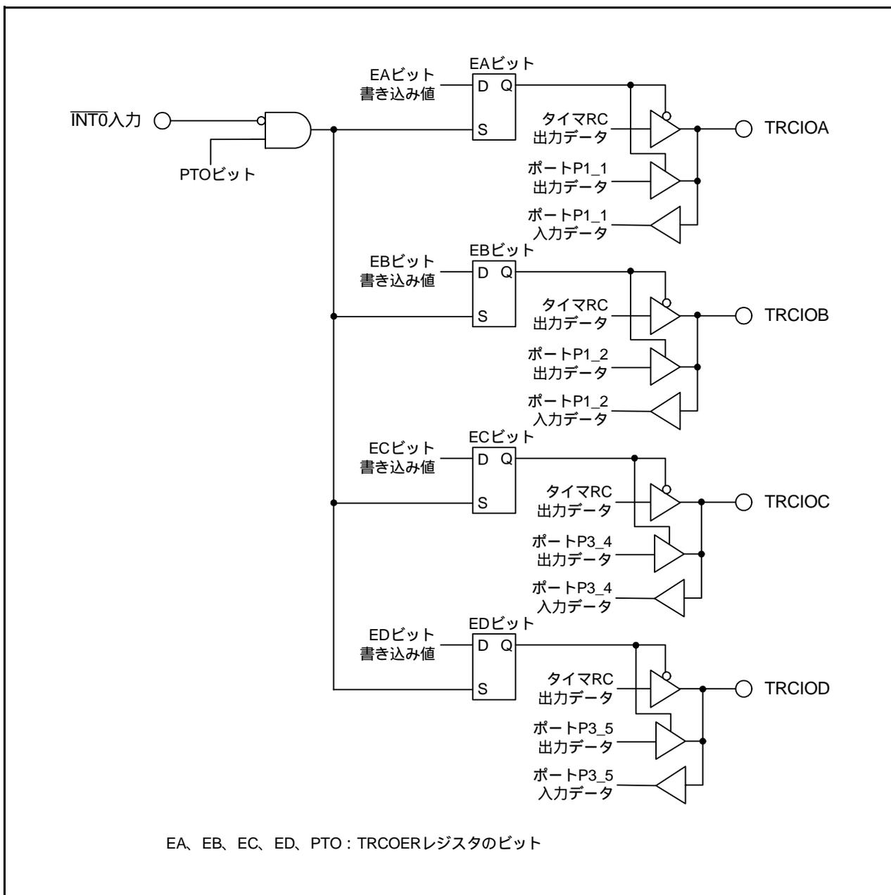
図 18.6 パルス出力強制遮断
