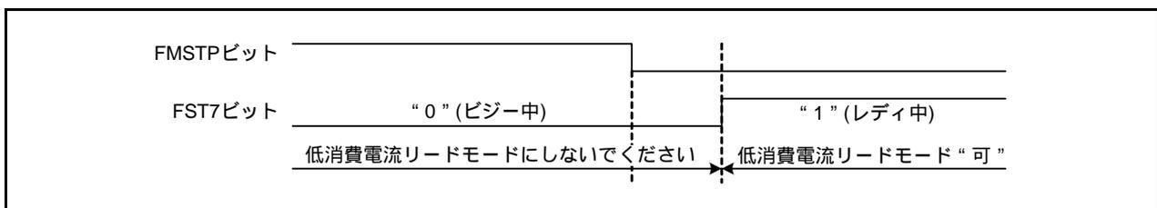
図24.2 低消費電流リードモードへの移行
