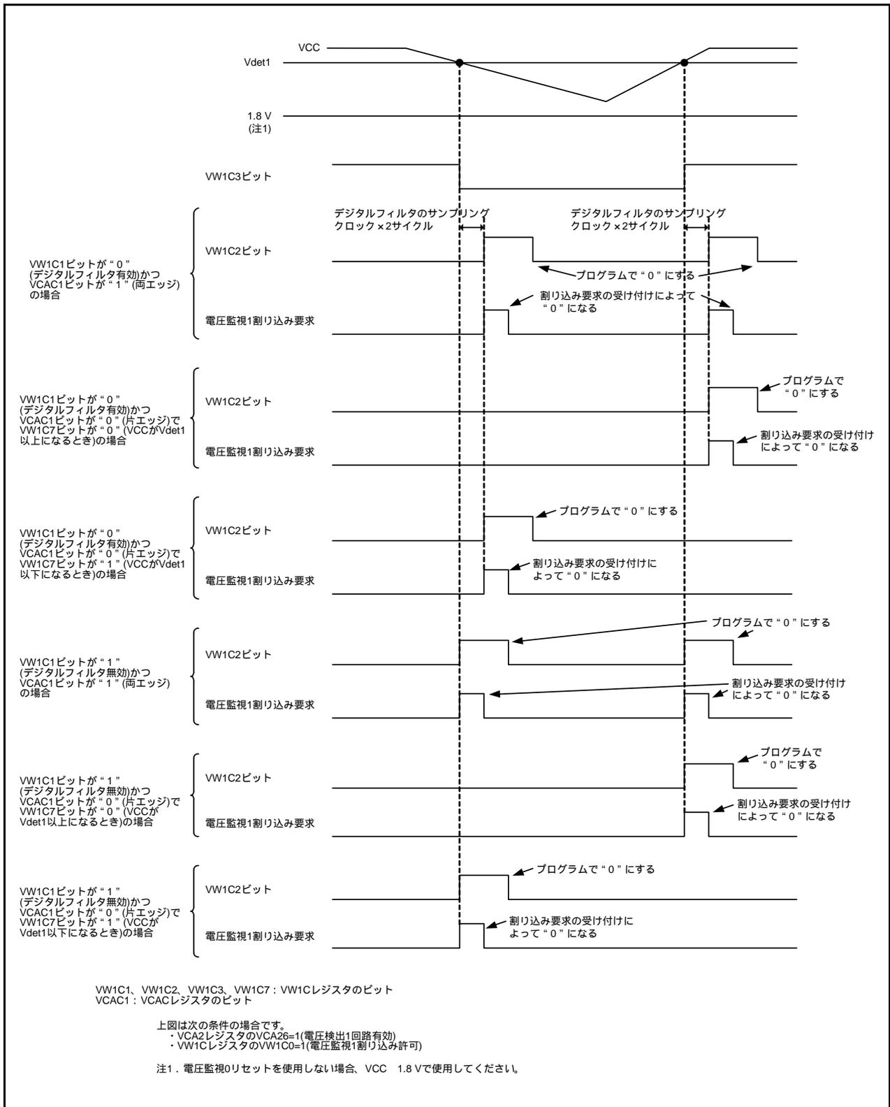
図6.6 電圧監視1割り込み動作例
