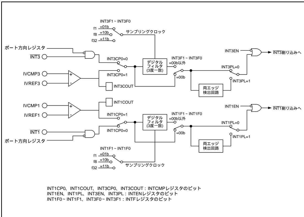
図23.1 コンパレータBのブロック図
