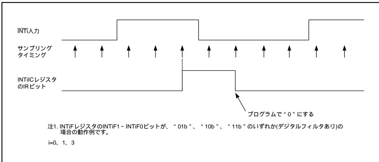
図 11.10  $\overline{\text{INTi}}$ 入力フィルタ動作例
