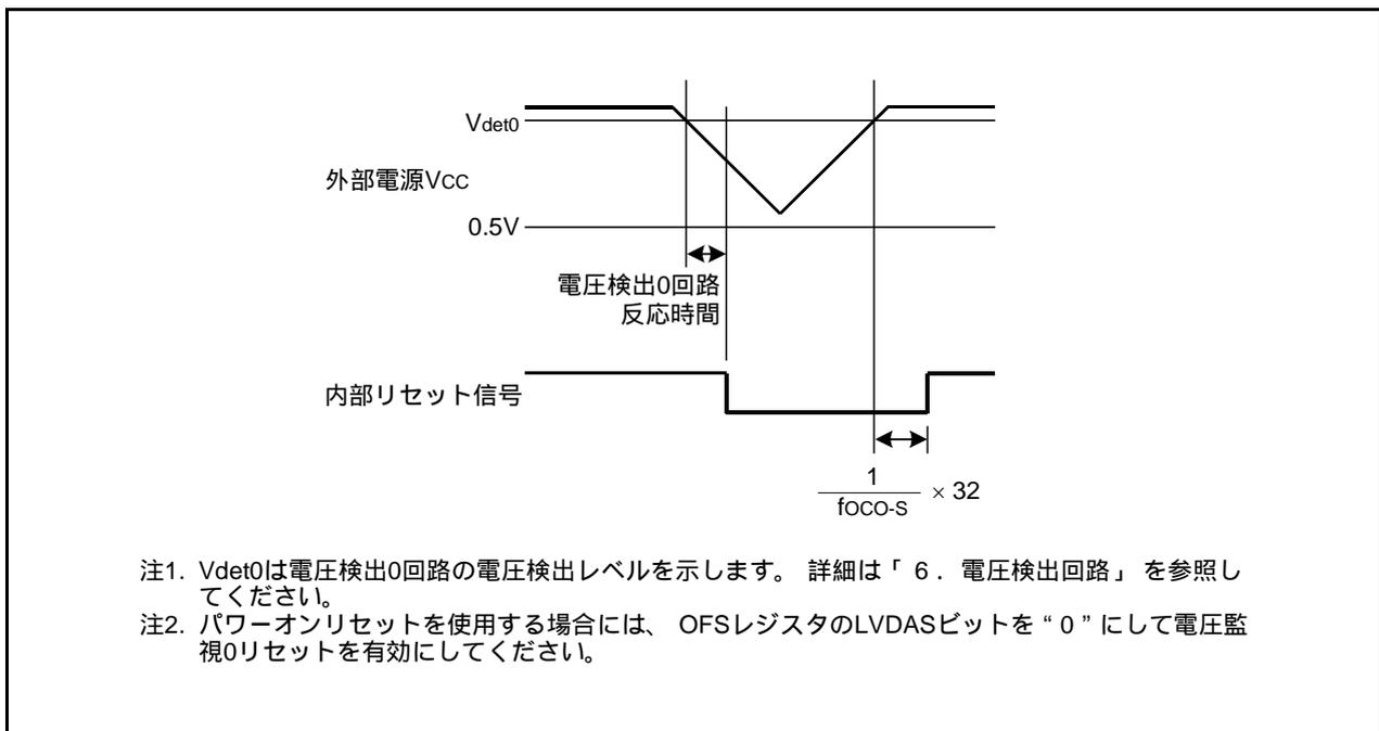
図5.7 電圧監視0リセット回路例と動作
