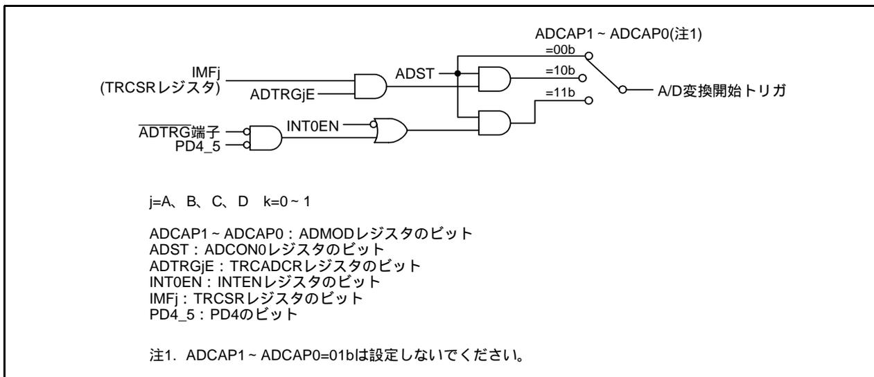
図22.4 A/D変換開始制御部のブロック図
