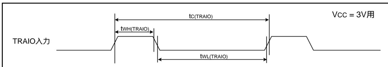
図26.9  $V_{CC} = 3V$ 時のTRAIO入力タイミング
