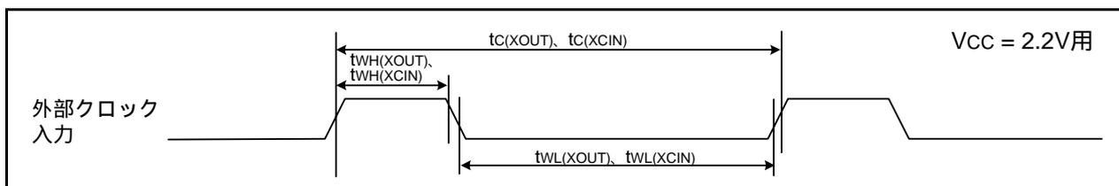
図26.12  $V_{CC} = 2.2V$ 時の外部クロック入力タイミング
