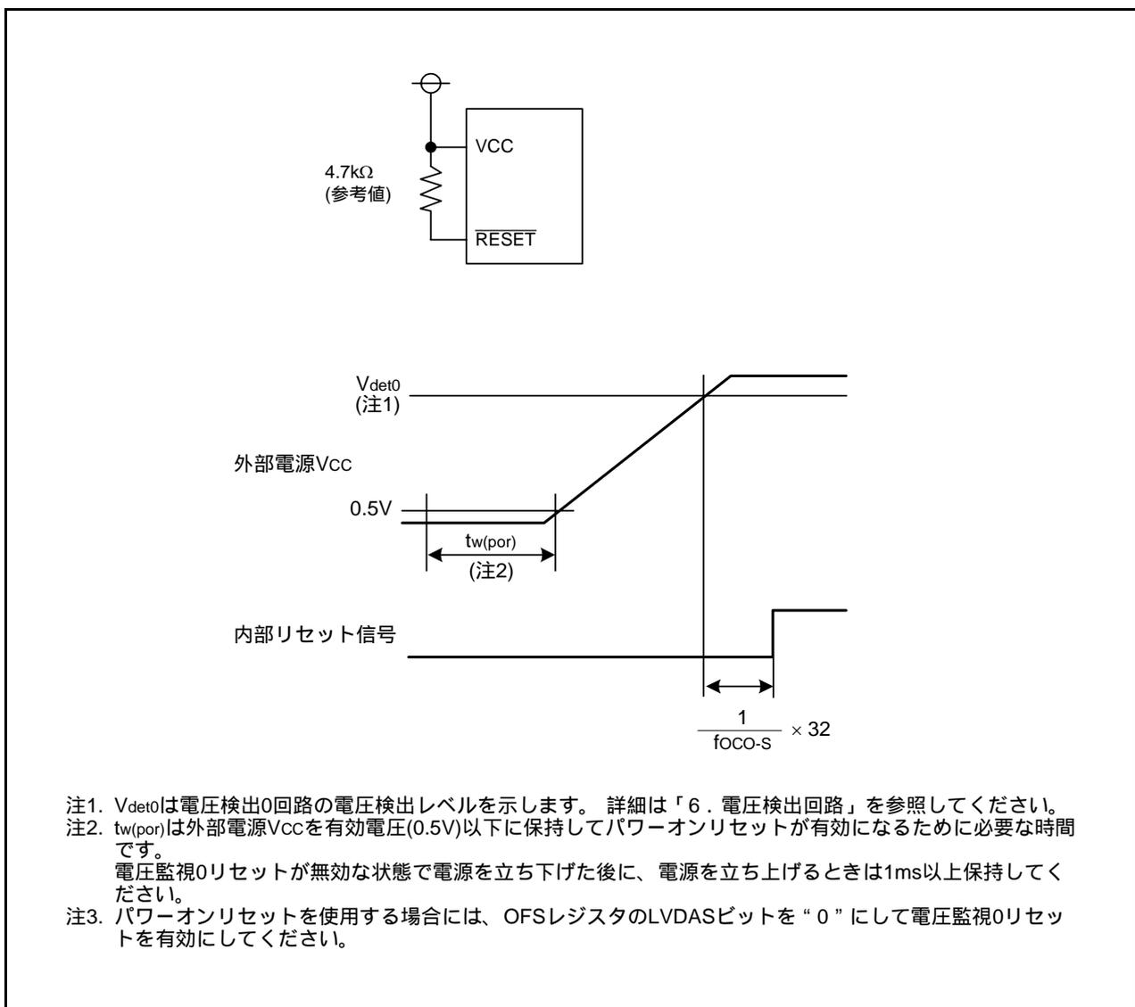
図5.6 パワーオンリセット回路例と動作
