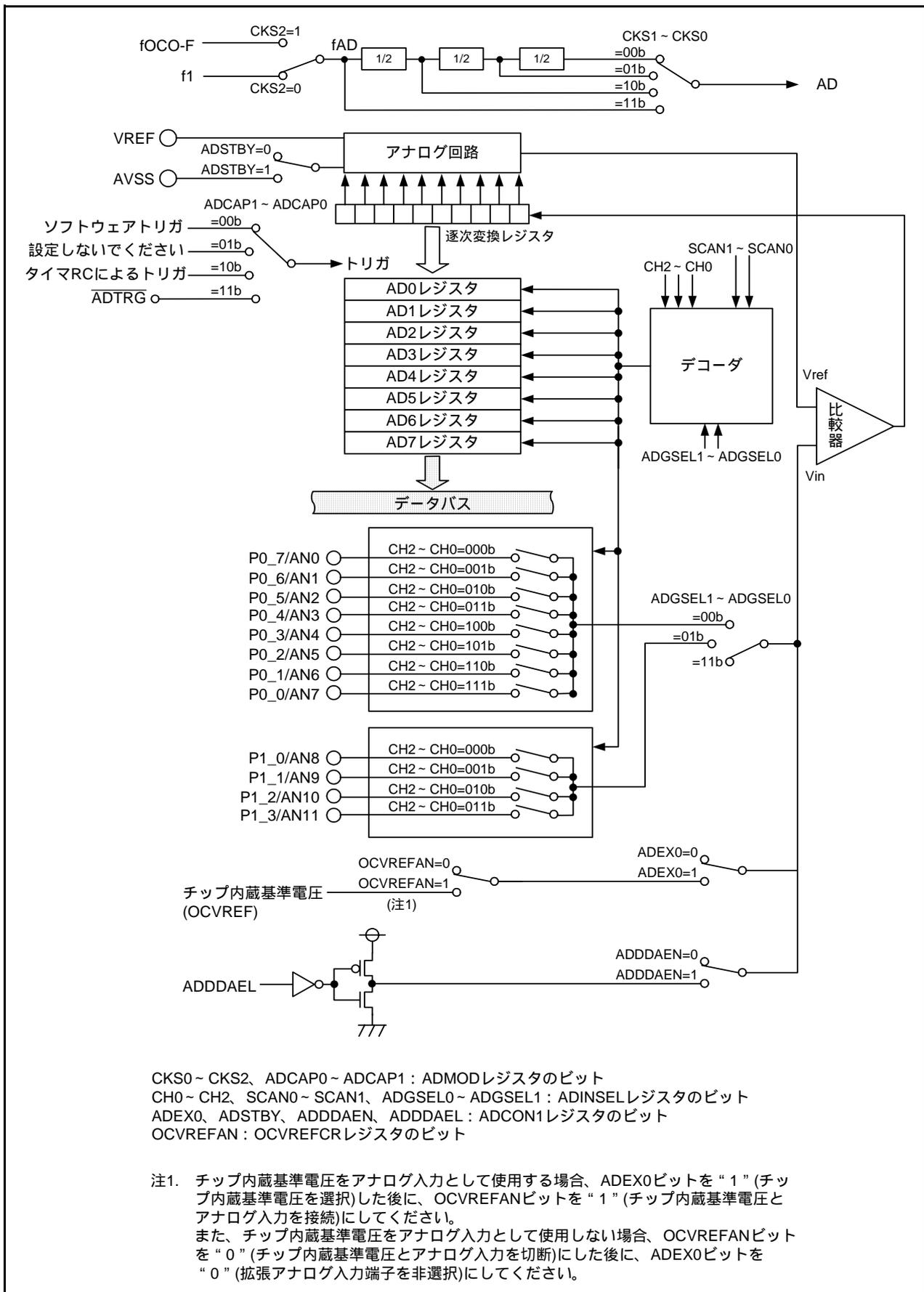
図22.1 A/Dコンバータのブロック図
