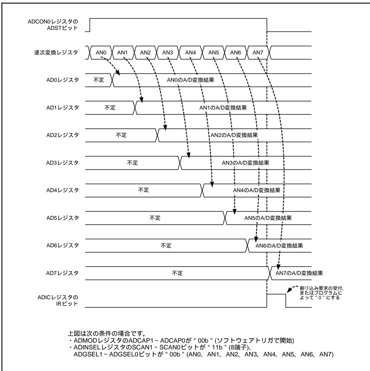
図22.8 単掃引モード時の動作例
