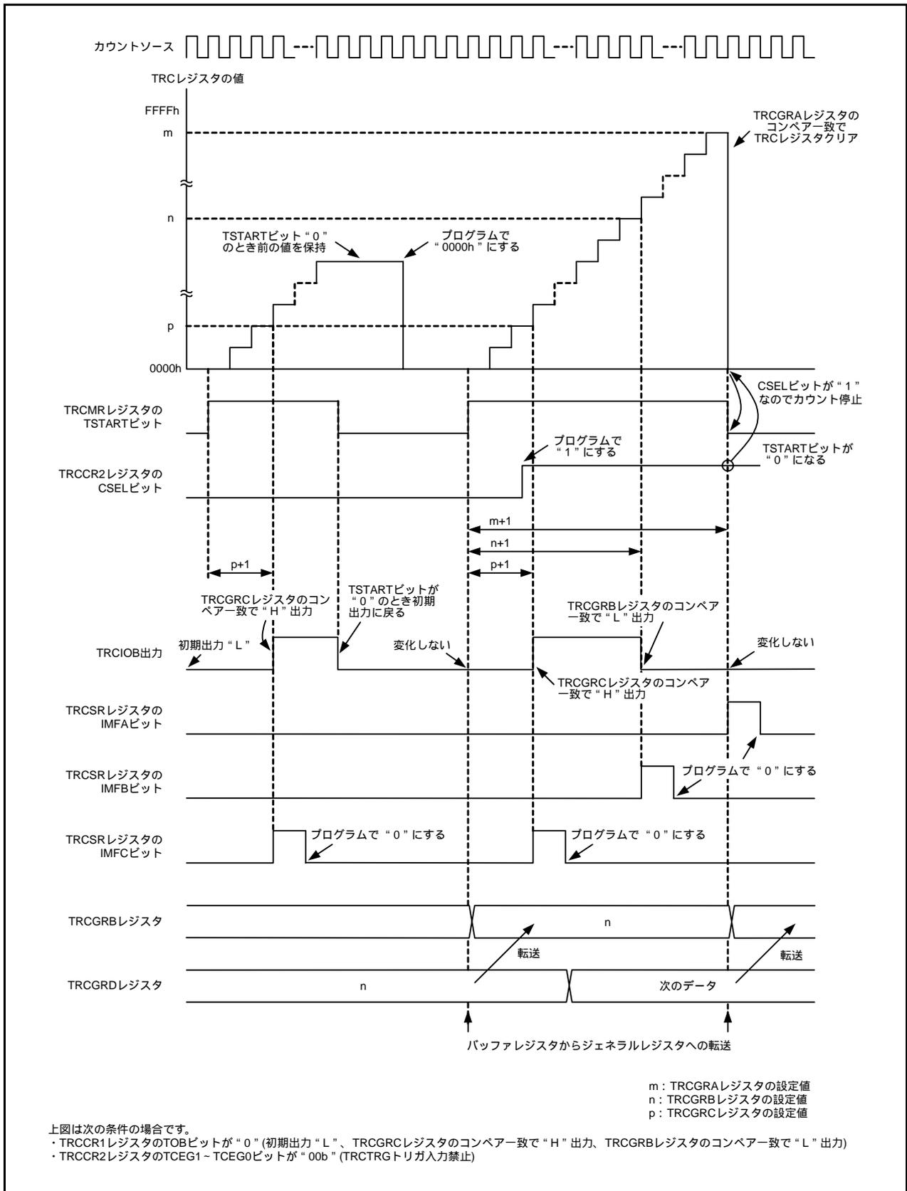
図 18.17 PWM2モードの動作例 (TRCTRGトリガ入力禁止の場合)
