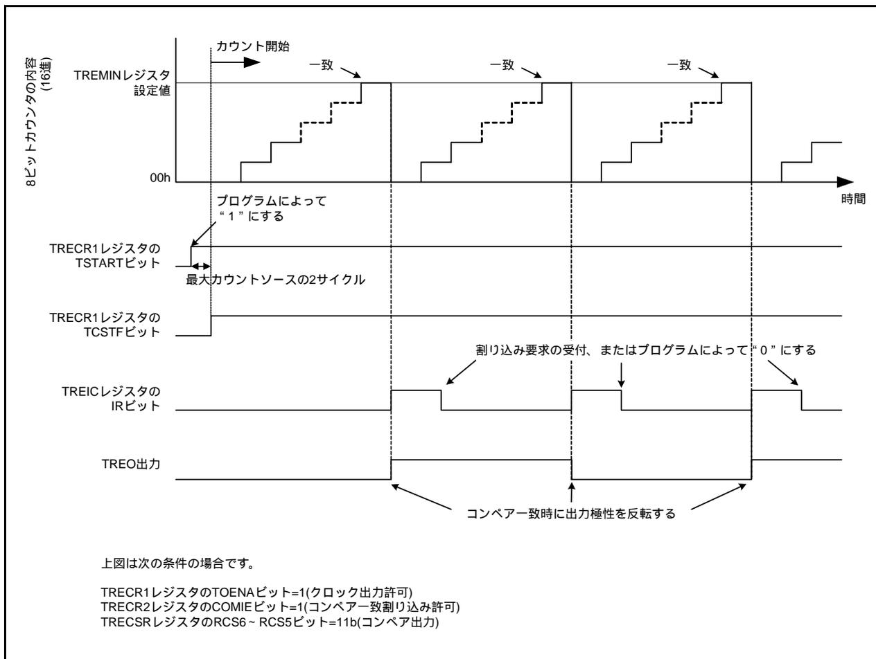
図19.5 アウトプットコンパレーモードの動作例
