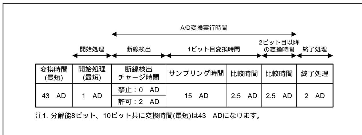
図22.3 A/D変換サイクル数(AD = fADのとき)
