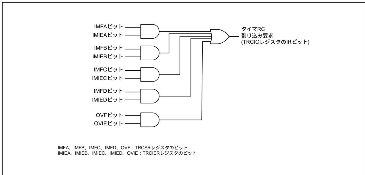
図18.20 タイマRC割り込みのブロック図
