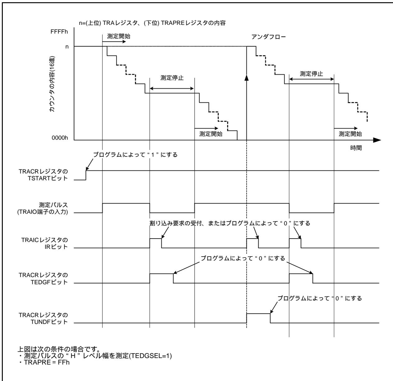
図 16.3 パルス幅測定モード時の動作例
