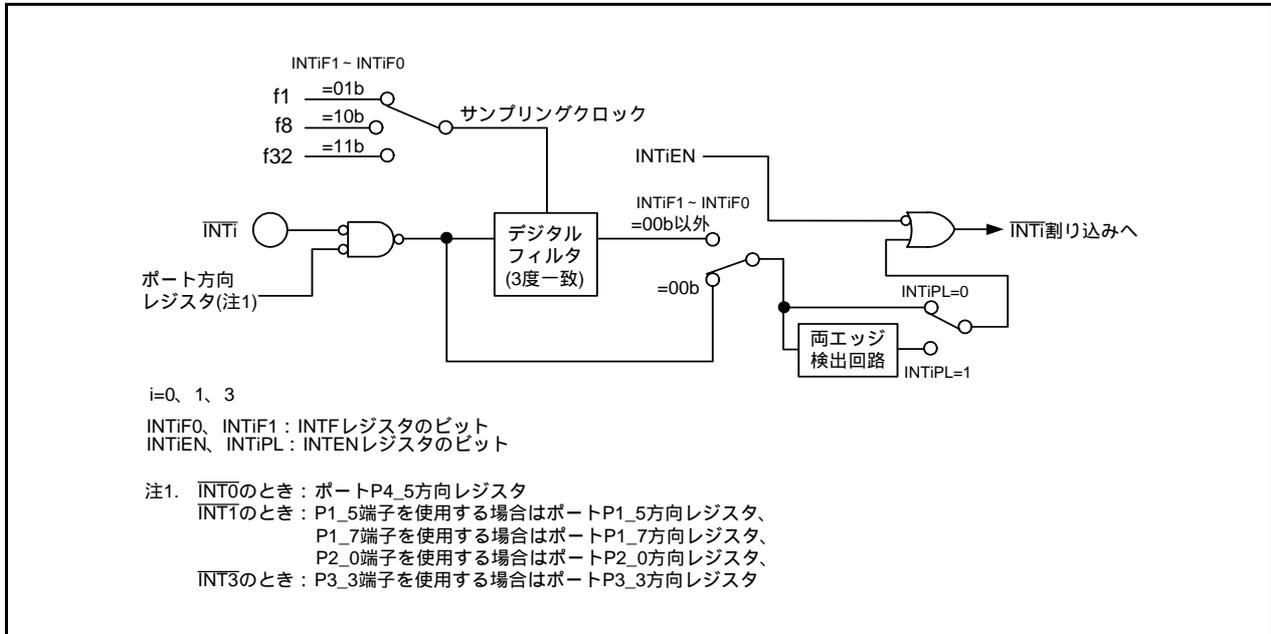
図 11.9  $\overline{\text{INTi}}$ 入力フィルタの構成
