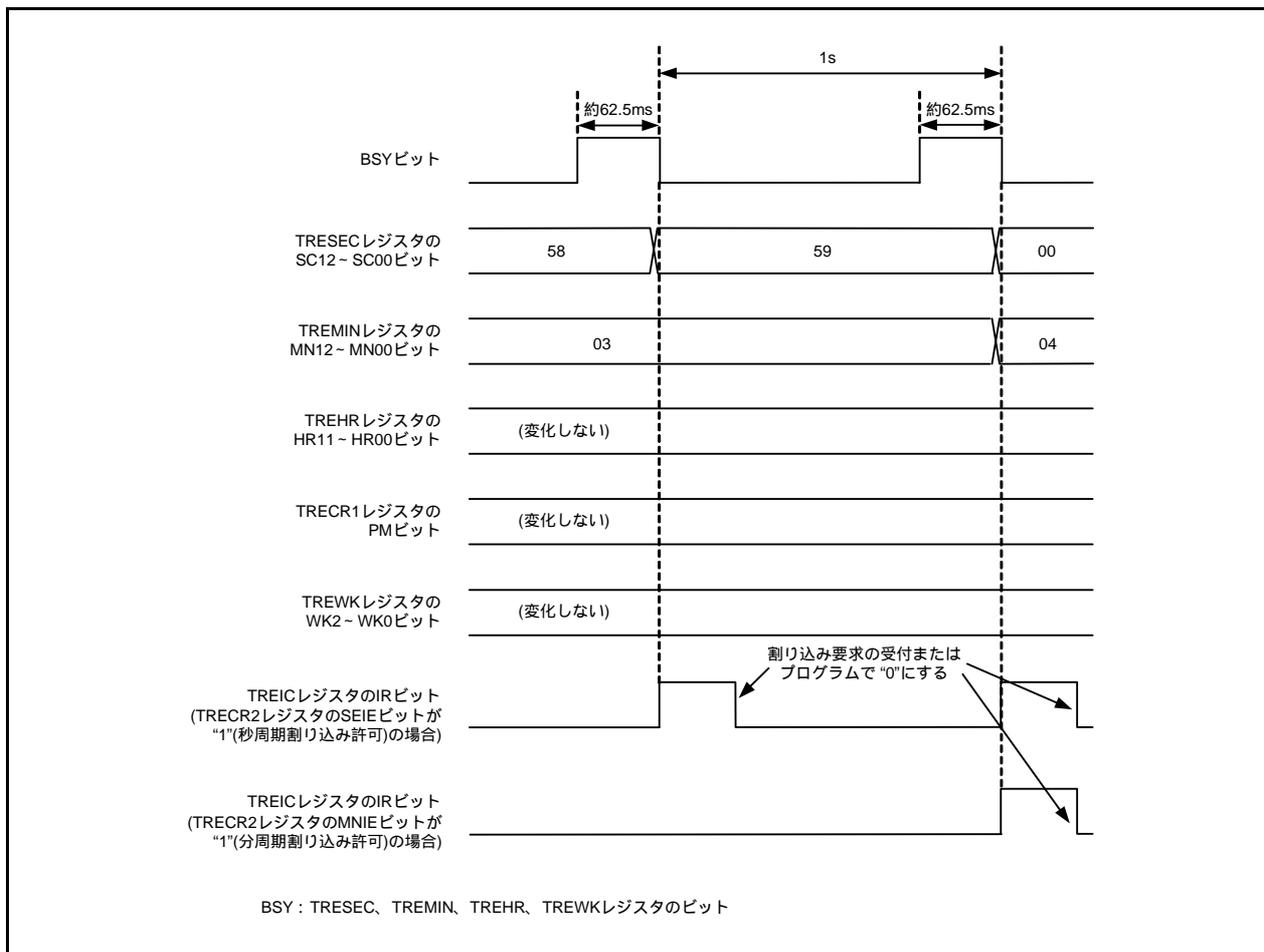
図19.3 リアルタイムクロックモードの動作例
