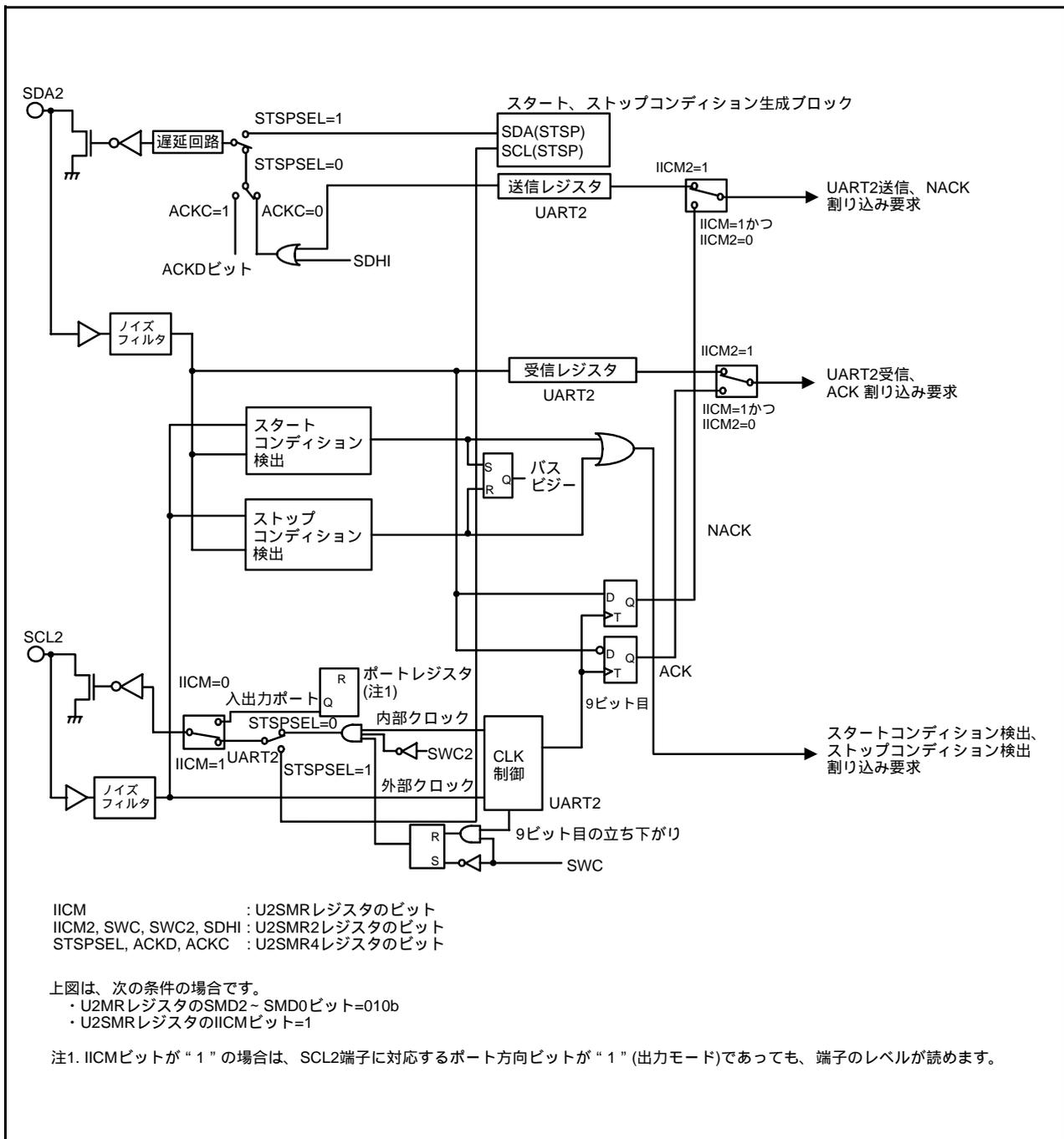
図21.13 I<sup>2</sup>Cモードのブロック図
