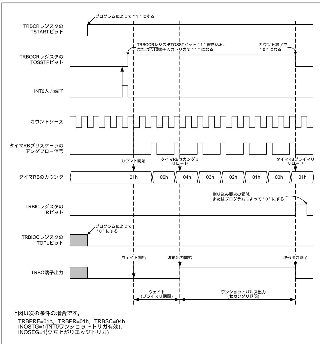
図17.5 プログラマブルウェイトワンショット発生モードの動作例
