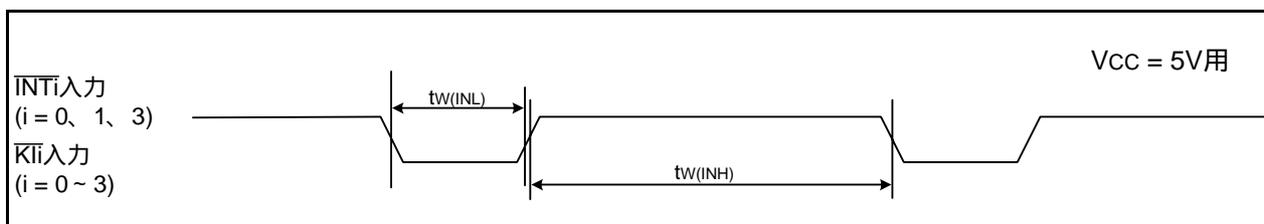
図26.7 Vcc = 5V時の外部割り込み $\overline{INTi}$ およびキー入力割り込み $\overline{Kli}$ 入力タイミング
