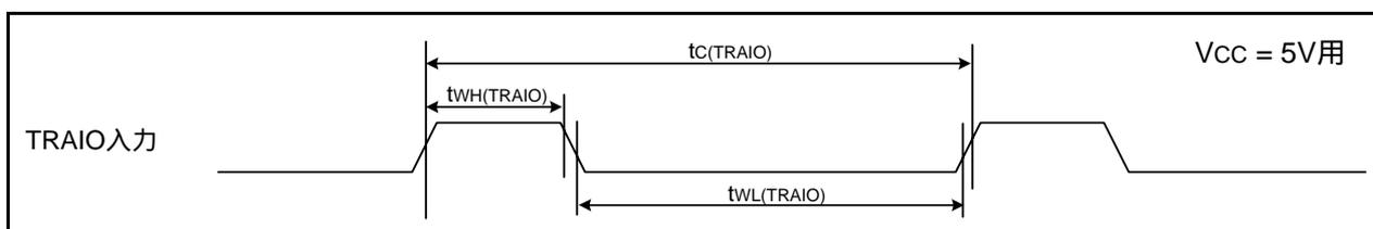
図26.5  $V_{CC} = 5V$ 時のTRAIO入力タイミング
