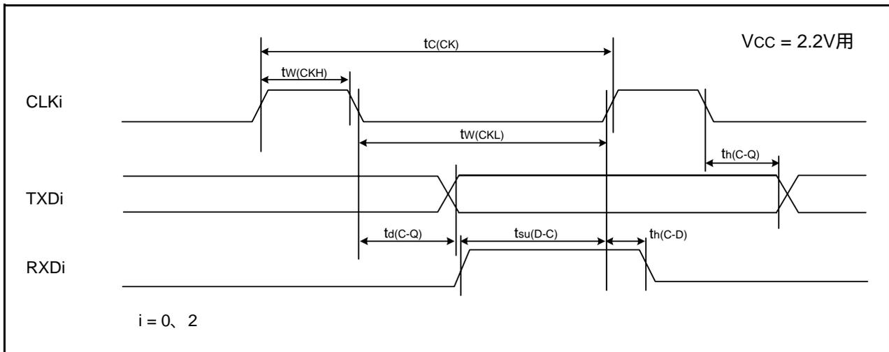
図26.14 Vcc = 2.2V時のシリアルインタフェースのタイミング
