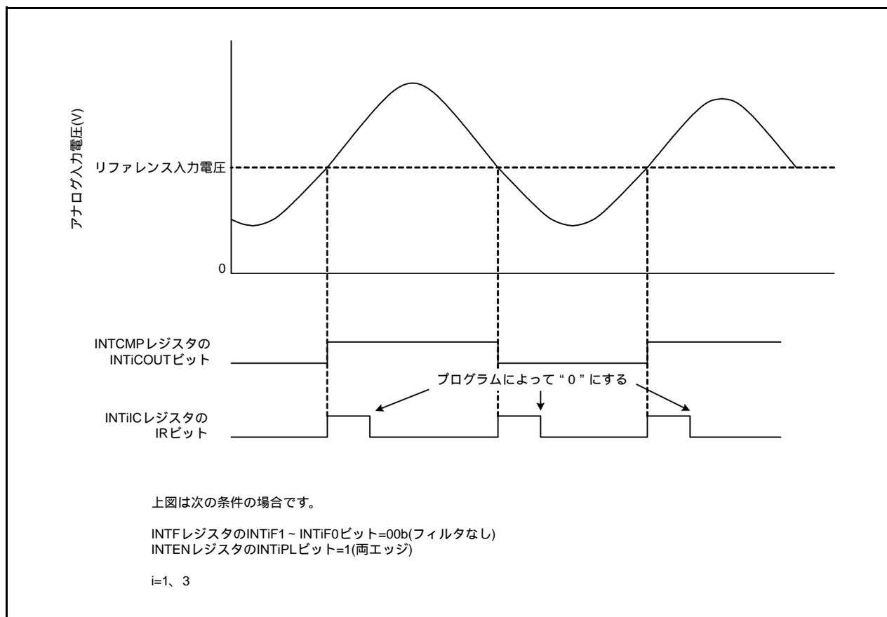
図23.2 コンパレータBi(i = 1、3)の動作例
