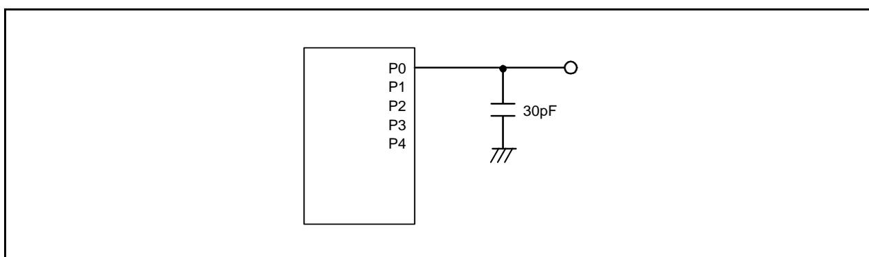
図26.1 ポートP0～P4のタイミング測定回路
