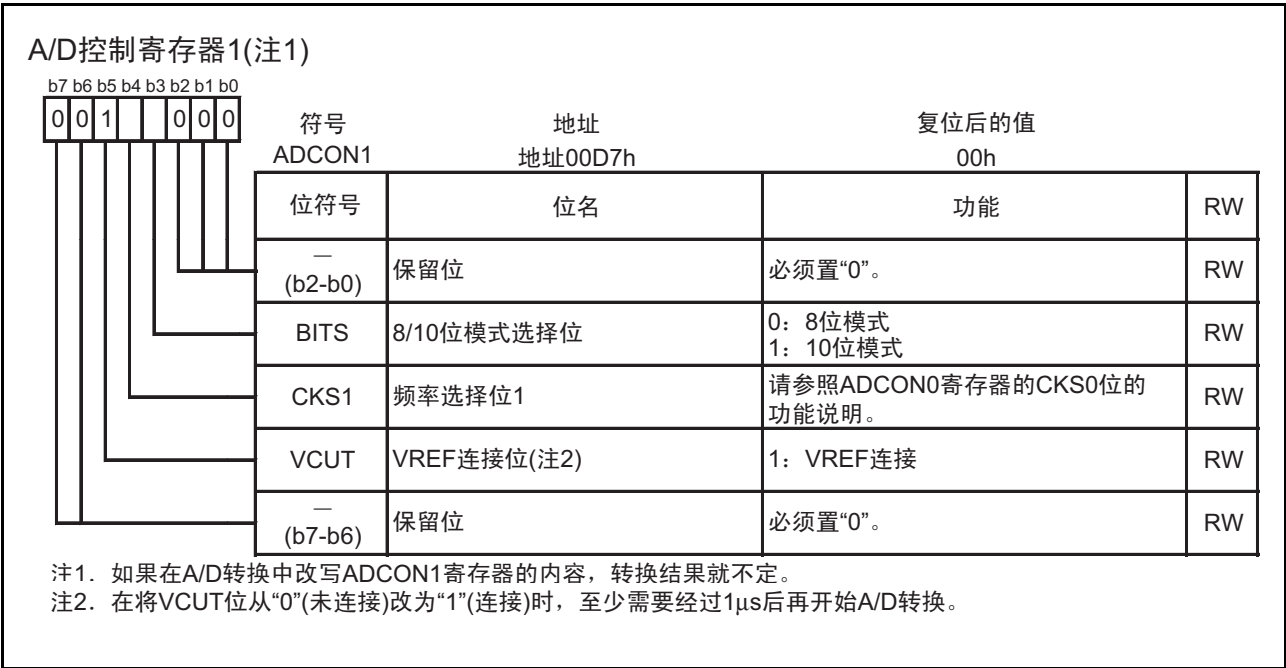
图 18.5 单次模式时的 ADCON1 寄存器
