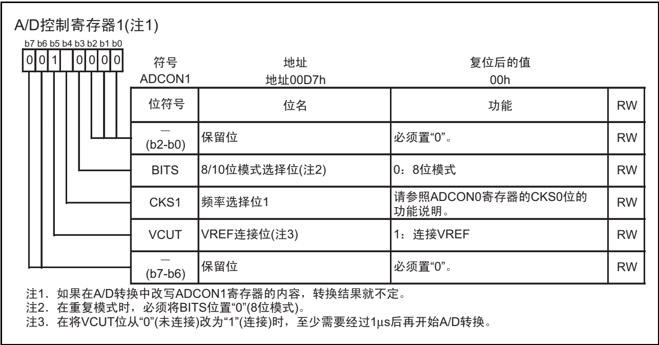
图 18.7 重复模式时的 ADCON1 寄存器
