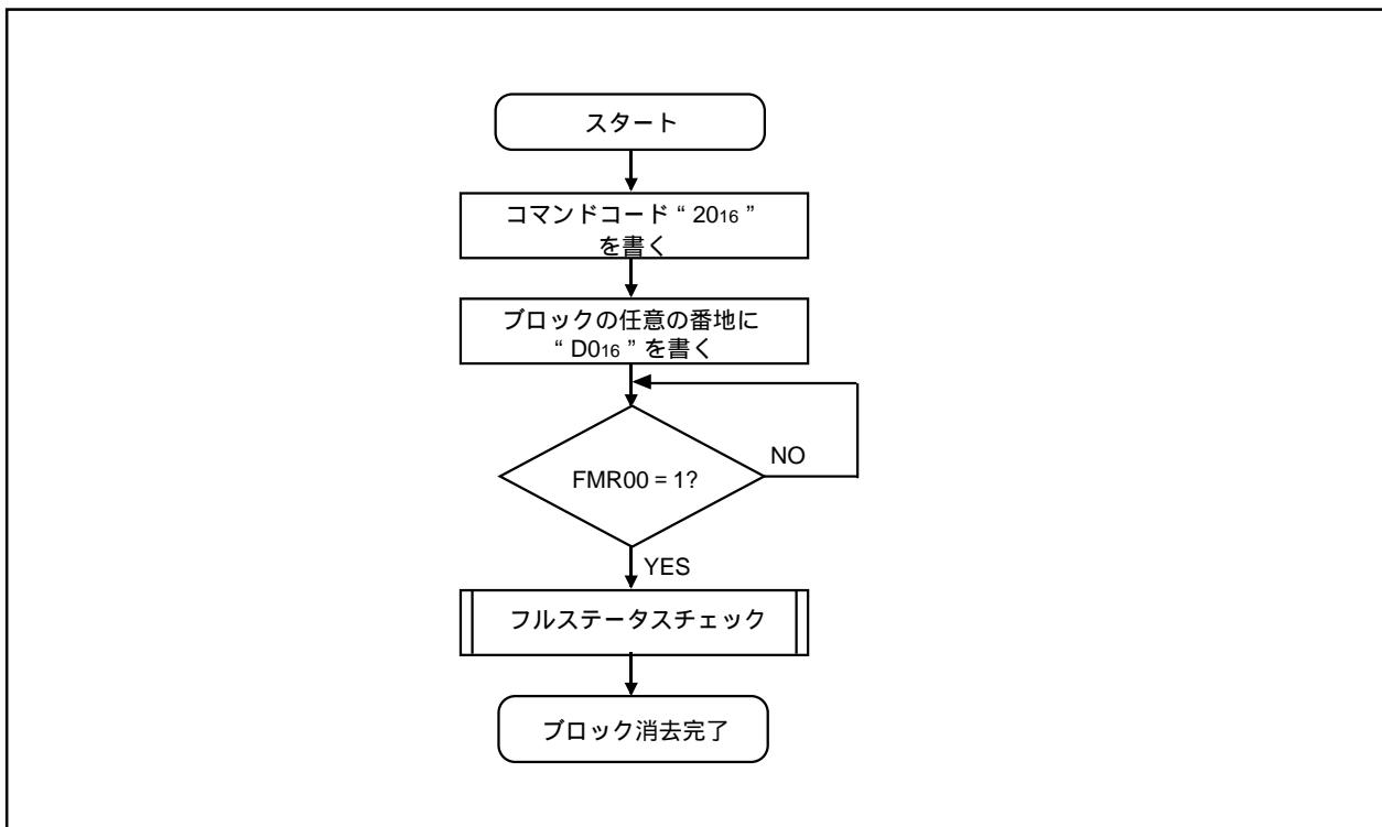
図17.9 ブロックイレーズフローチャート(イレーズサスペンド機能不使用時)
