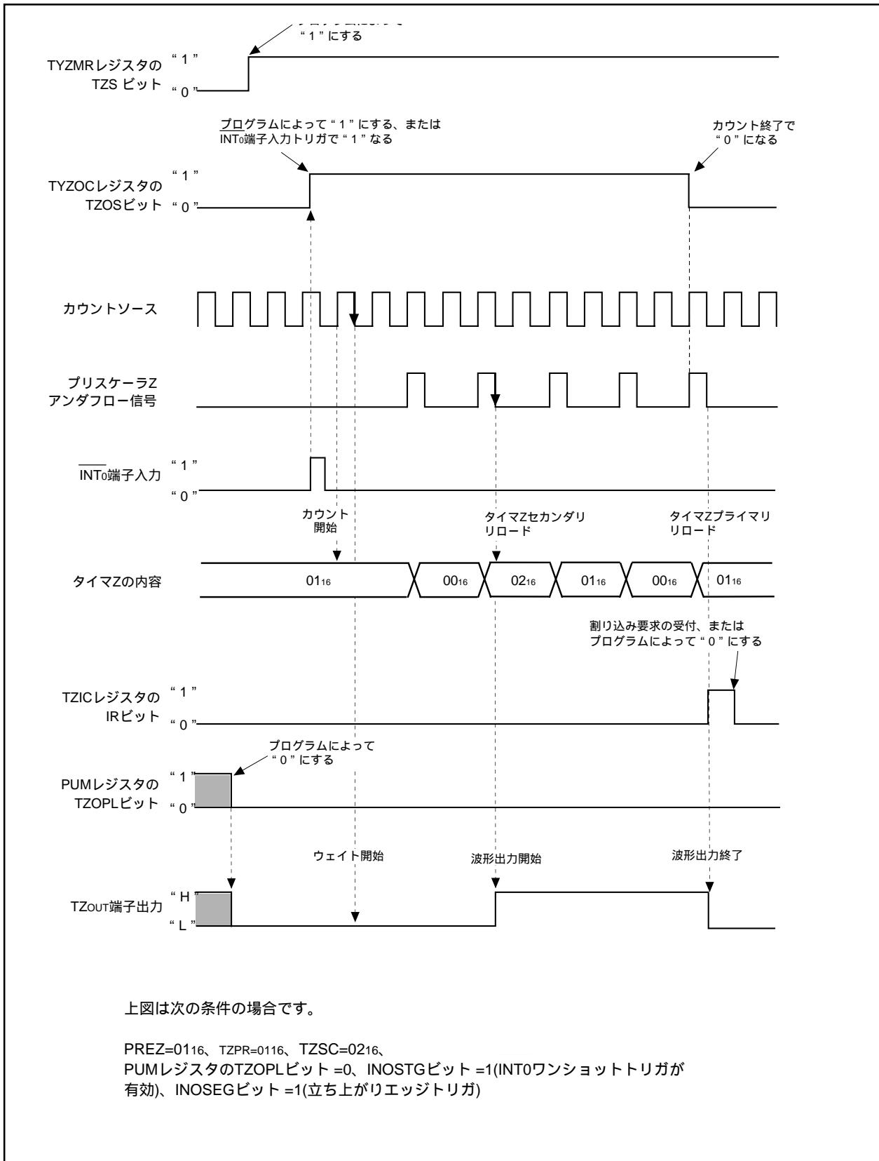
図12.27 プログラマブルウェイトワンショット発生モード時の動作例
