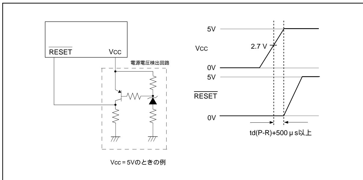
図5.4 リセット回路例(電圧監視回路例)
