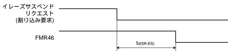
図16.2 消去動作からイレーズサスペンドへの遷移時間
