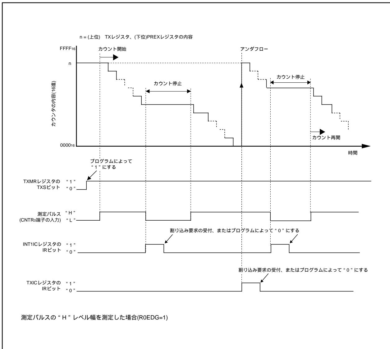
図12.8 パルス幅測定モード時の動作例
