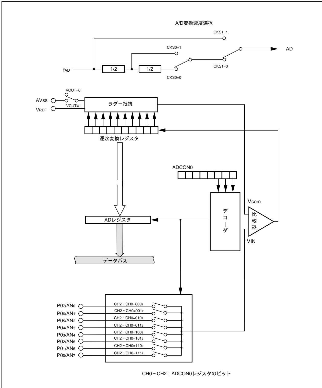
図14.1 A/Dコンバータのブロック図
