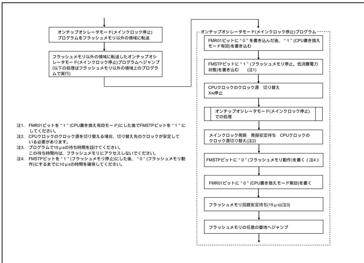
図17.7 オンチップオシレータモード(メインクロック停止)でさらに低消費電力にする処理
