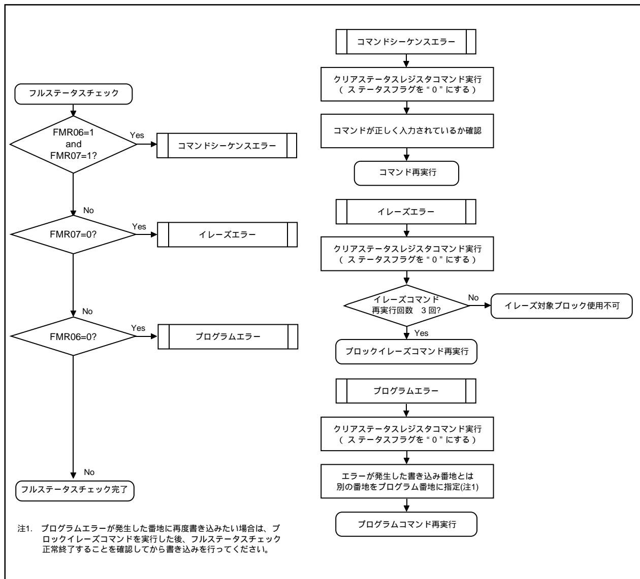
図17.11 フルステータスチェックフローチャート、各エラー発生時の対処方法
