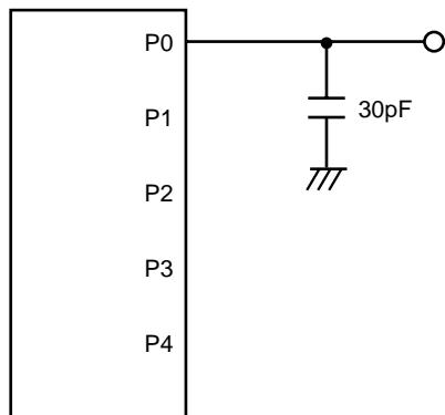
図16.1 ポートP0～P4の測定回路
