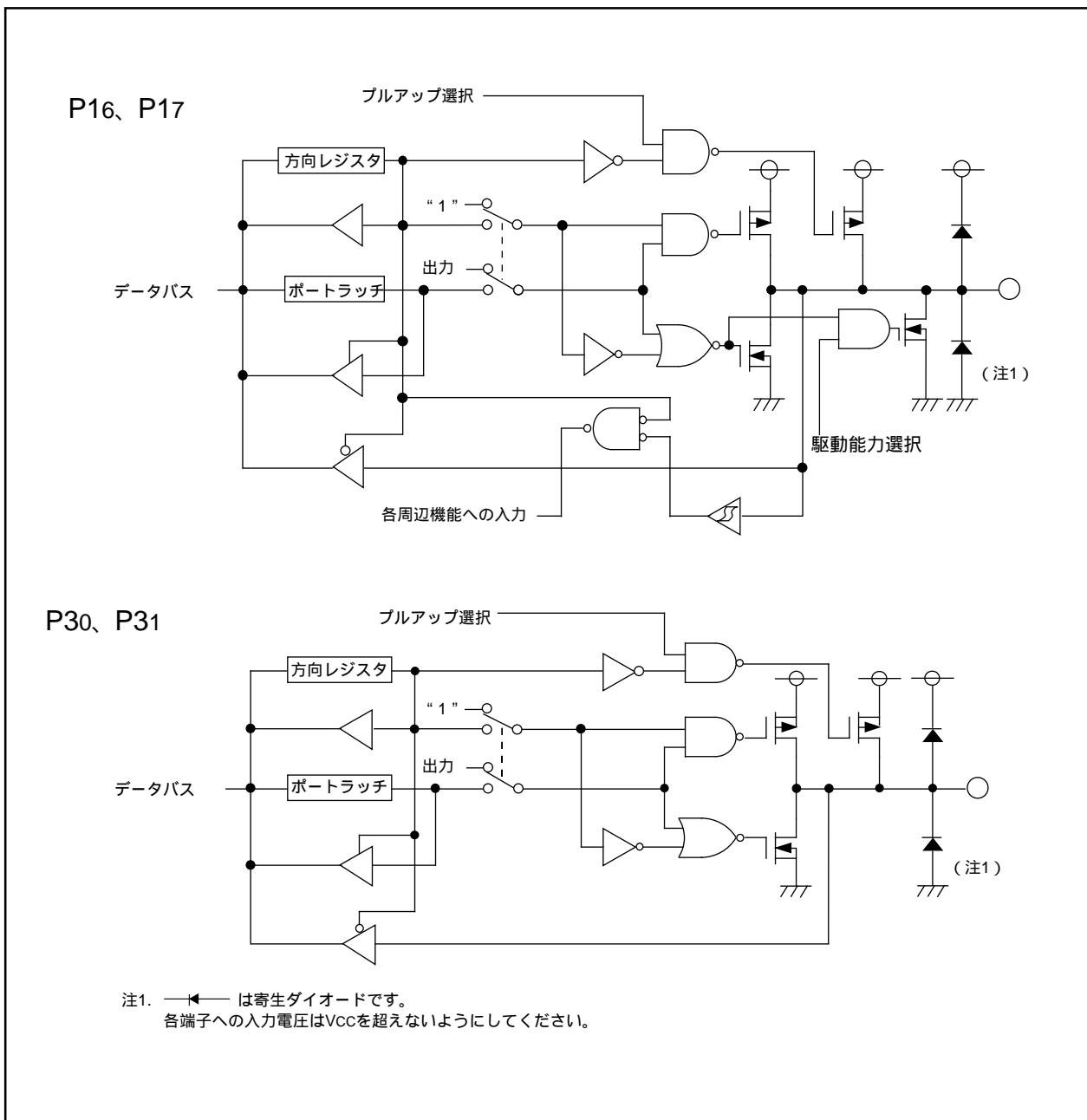
図15.2 プログラマブル入出力ポートの構成(2)
