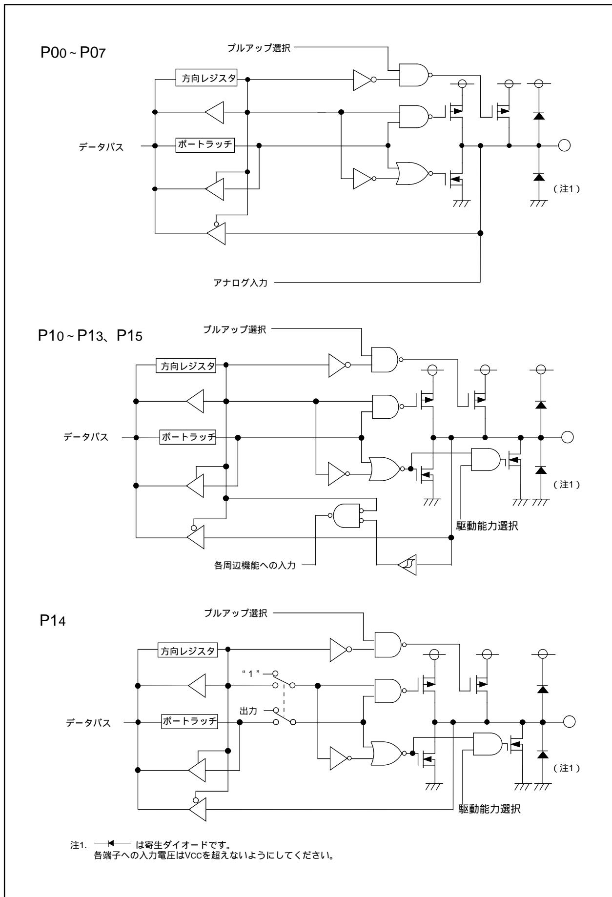
図15.1 プログラマブル入出力ポートの構成(1)
