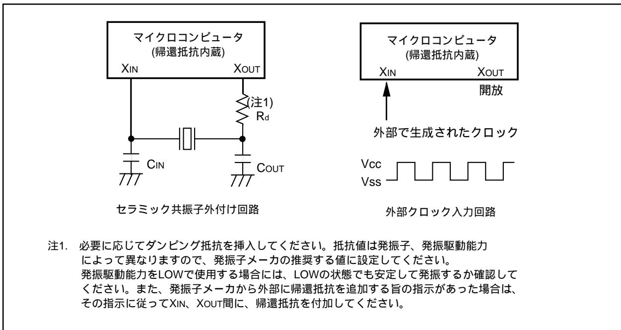
図6.4 メインクロックの接続回路例
