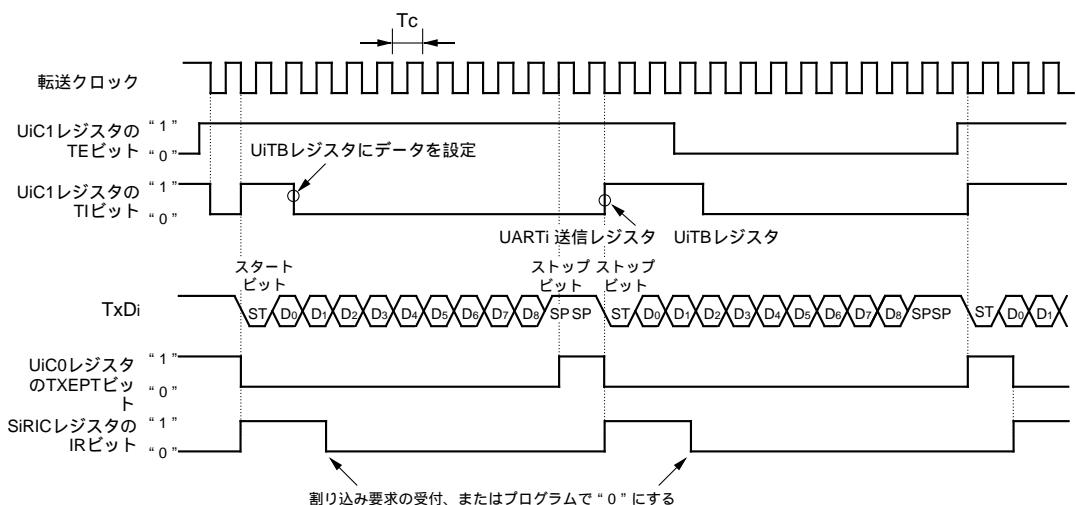
図13.9 UARTモード時の送信タイミング例
