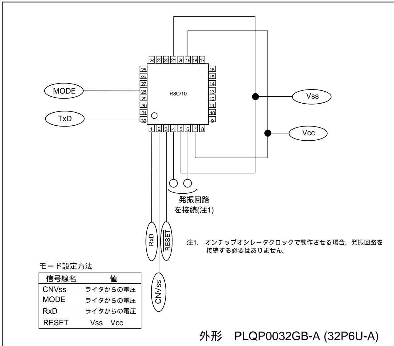
図17.12 標準シリアル入出力モード時の端子結線図
