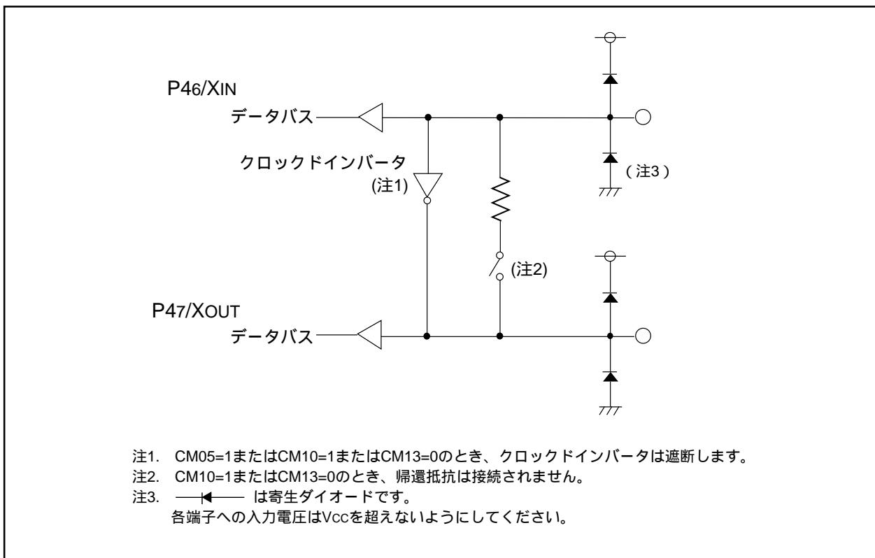
図15.4 プログラマブル入出力ポートの構成(4)
