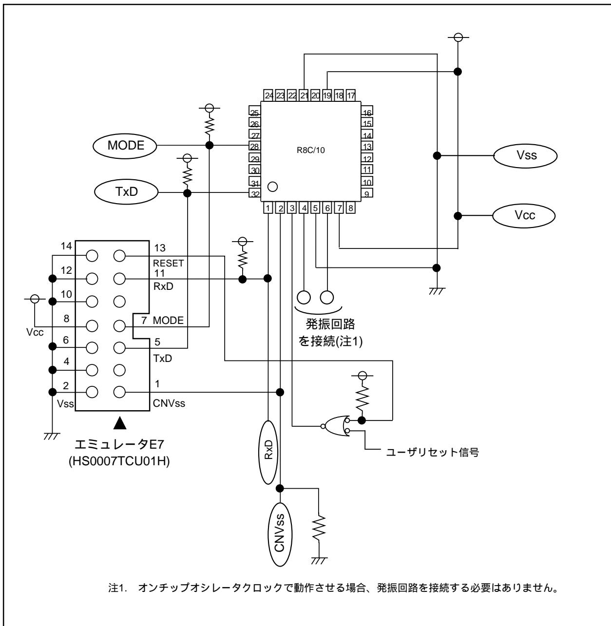
付図2.3 エミュレータE7 (HS0007TCU01H)との接続例
