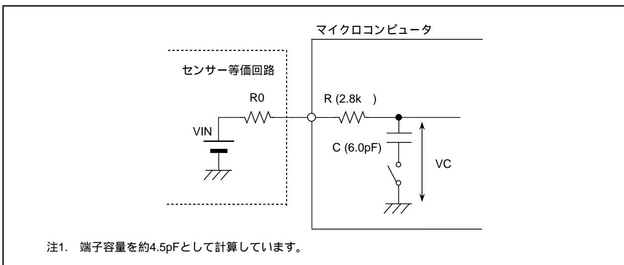
図14.11 アナログ入力端子と外部センサーの等価回路例
