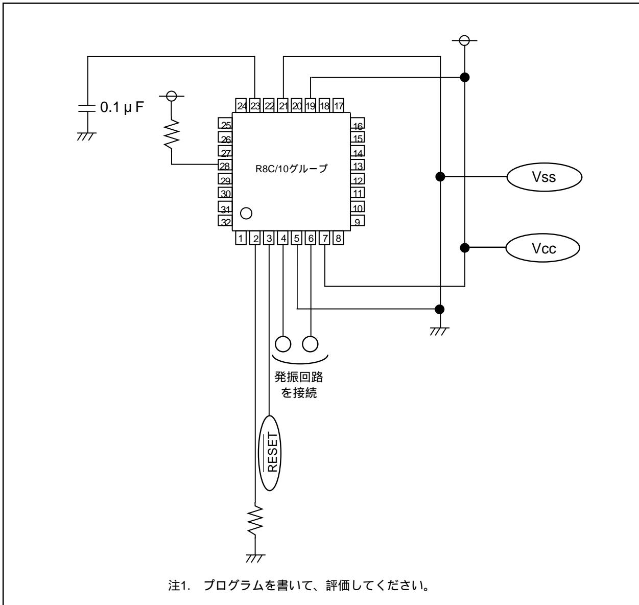
付図3.1 発振評価回路例
