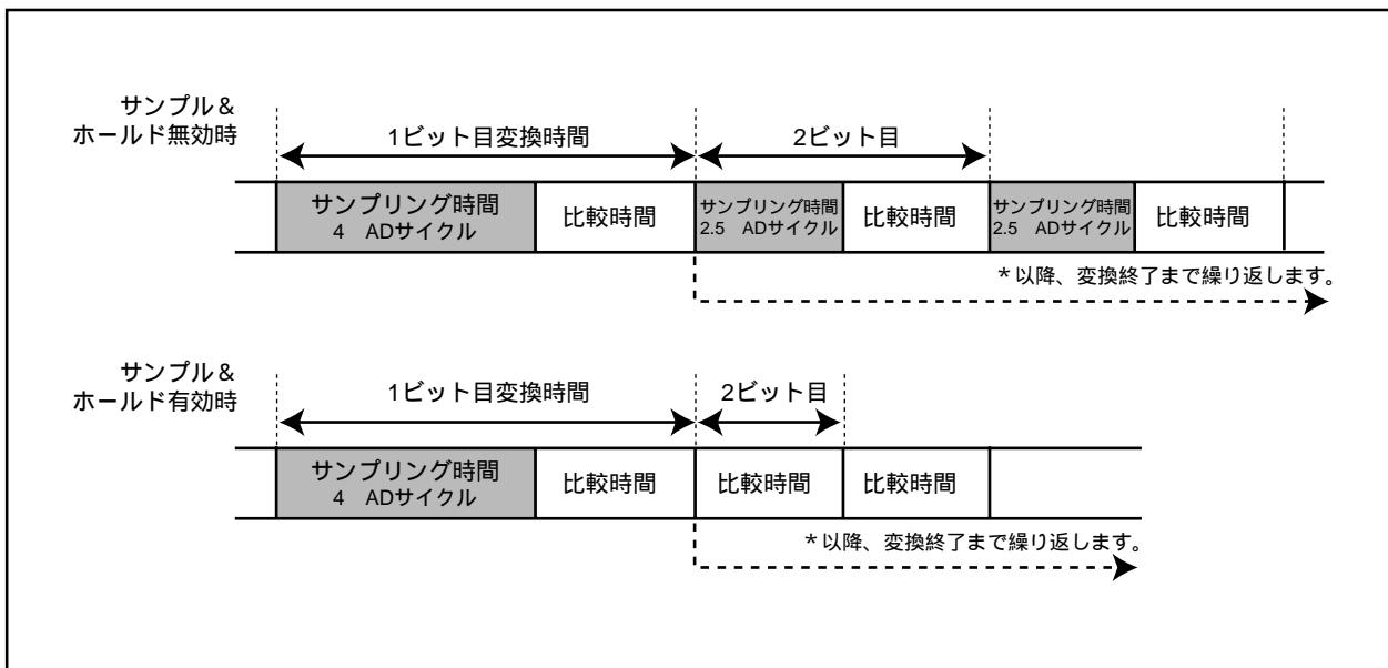
図14.6 A/D変換タイミング図
