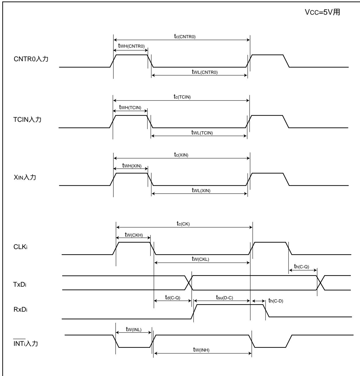
図16.3  $V_{CC}=5V$ 時のタイミング
