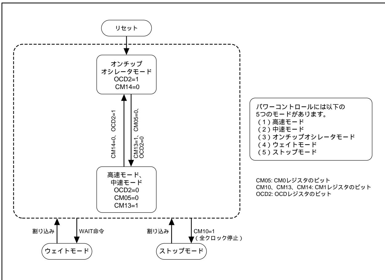
図6.5 パワーコントロールの状態遷移
