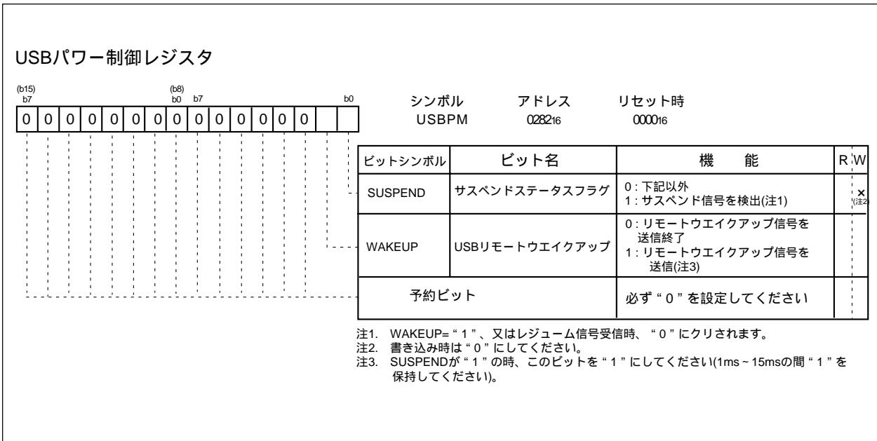
図2.8.27. USBパワー制御レジスタの構成
