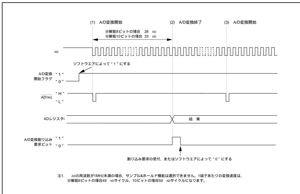
図2.9.6. 単発モード、外部トリガ選択時の動作タイミング図
