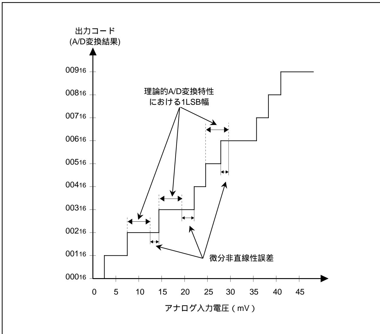
図2.9.22. 微分非直線性誤差(分解能10ビット時)
