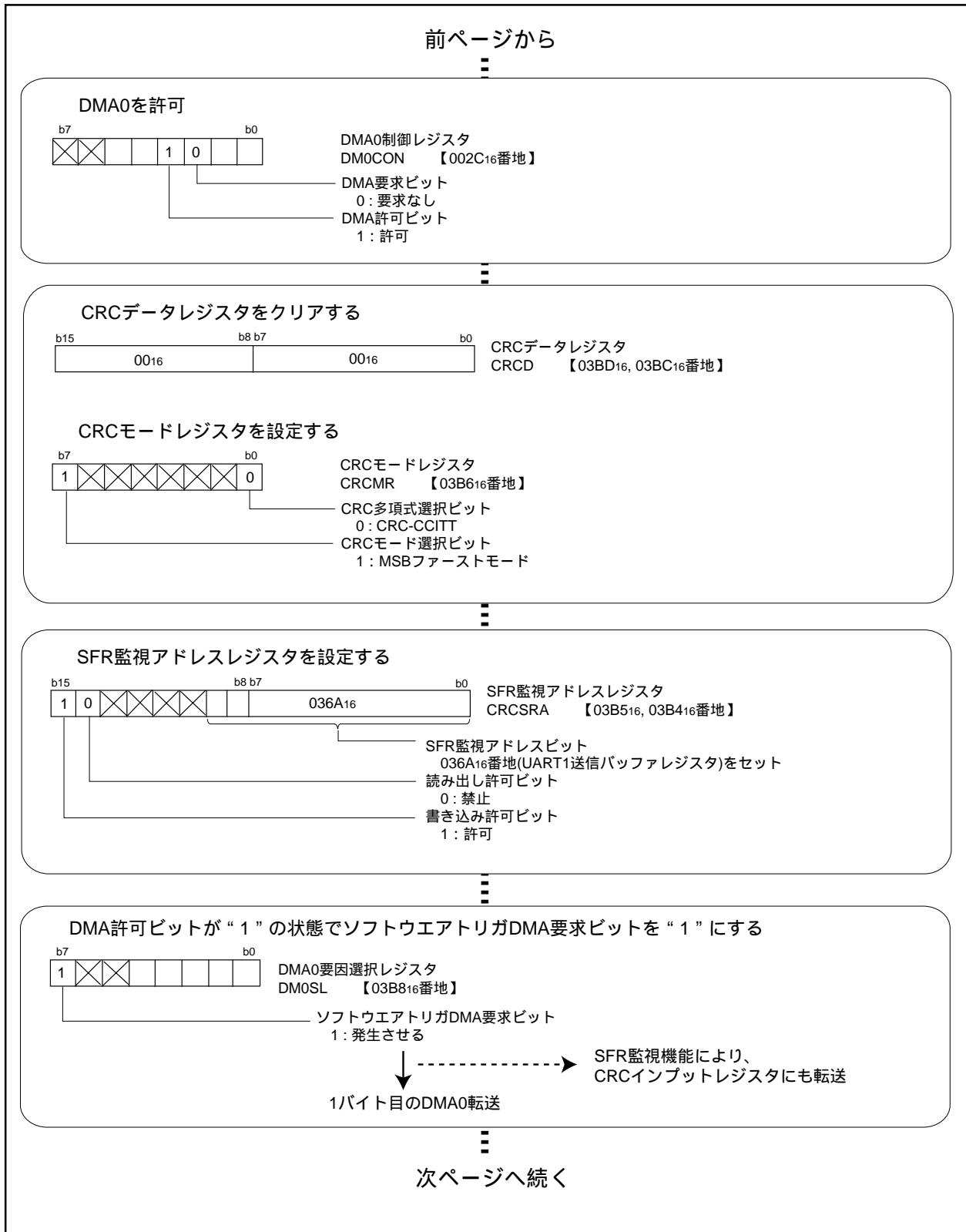
図3.6.3. SFR監視機能を使用したRAMからUARTへのDMA転送設定手順例(2)
