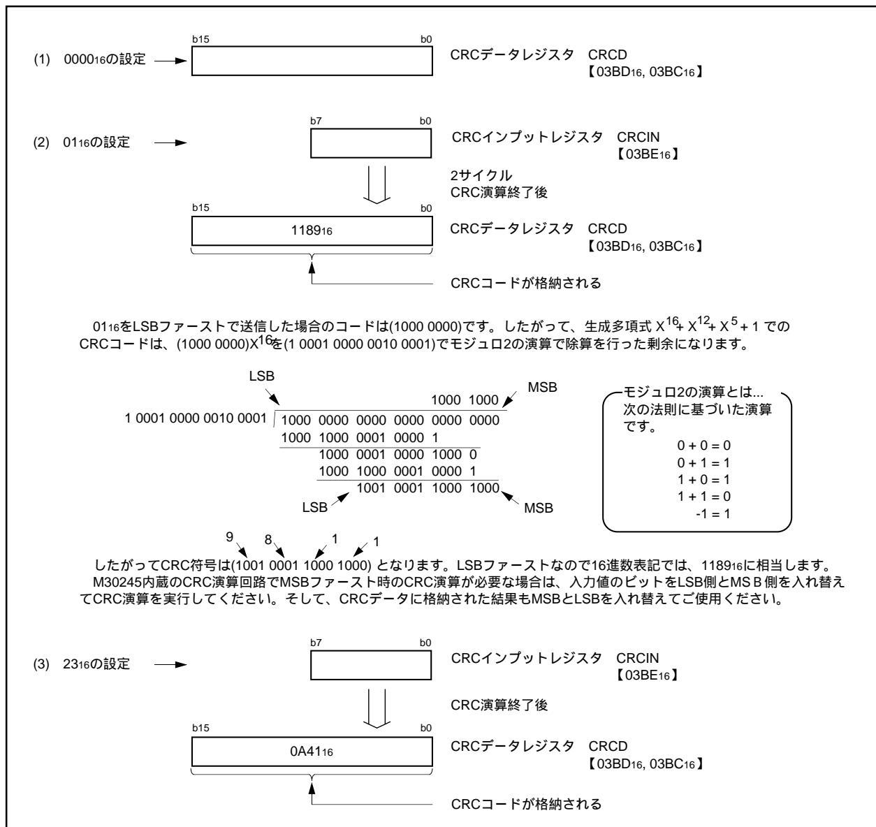
図2.11.3. データ012316でのCRC演算回路の演算例 (CRC-CCITT使用時)
