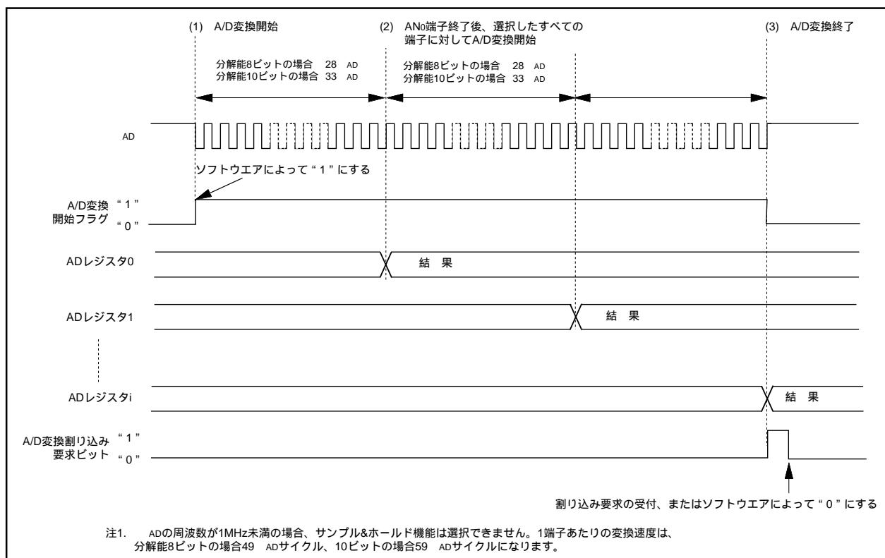
図2.9.10. 単掃引モード動作タイミング図
