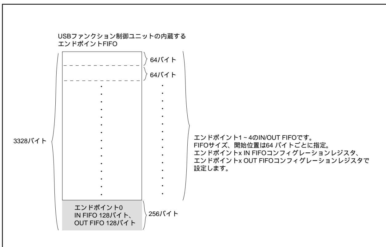
図2.8.14. エンドポイントx IN/OUT FIFOの配置
