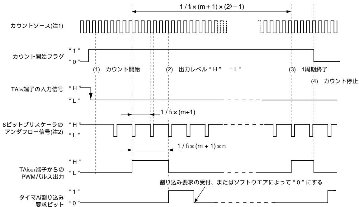
図2.2.25. パルス幅変調モード、8ビットPWMモード選択時の動作タイミング図
