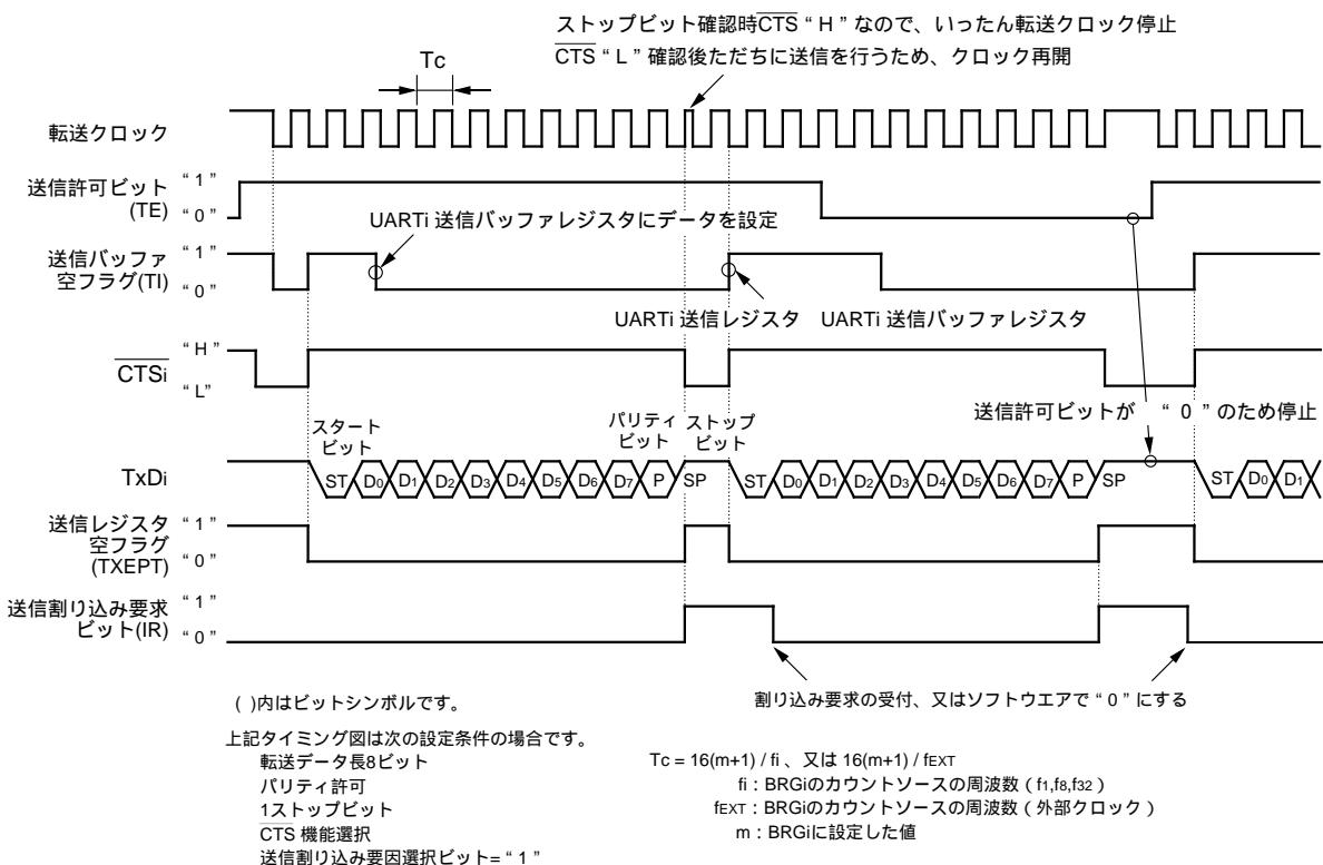
図2.4.7. クロック非同期形シリアルI/Oモードの送信動作タイミング図
