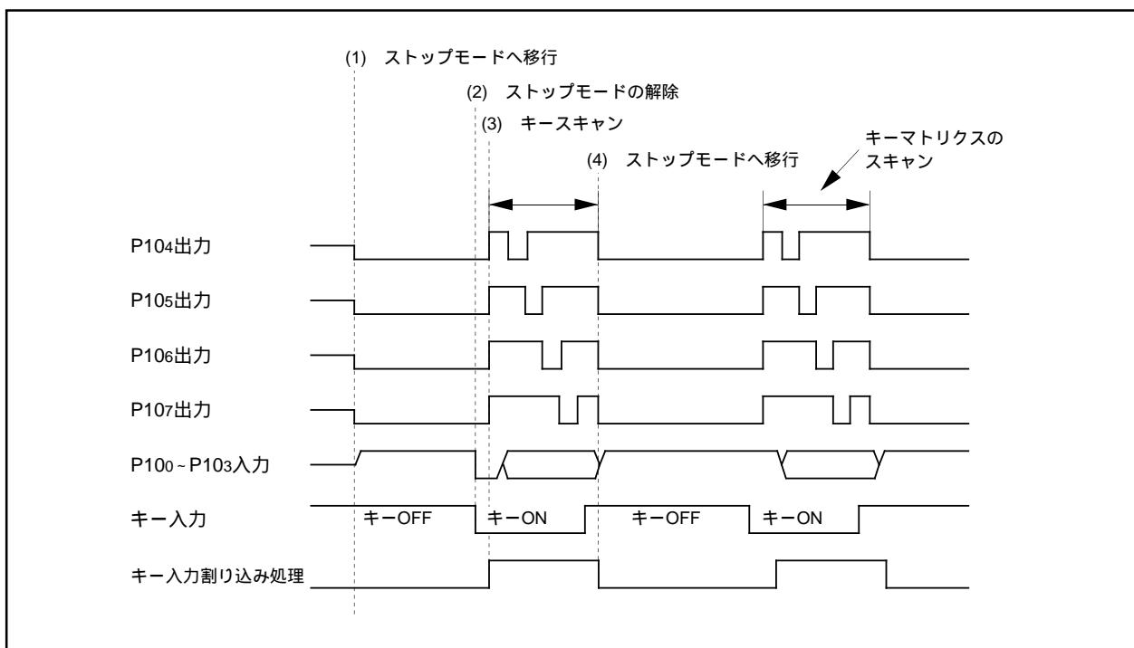
図2.14.5. キー入力割り込みの動作例
