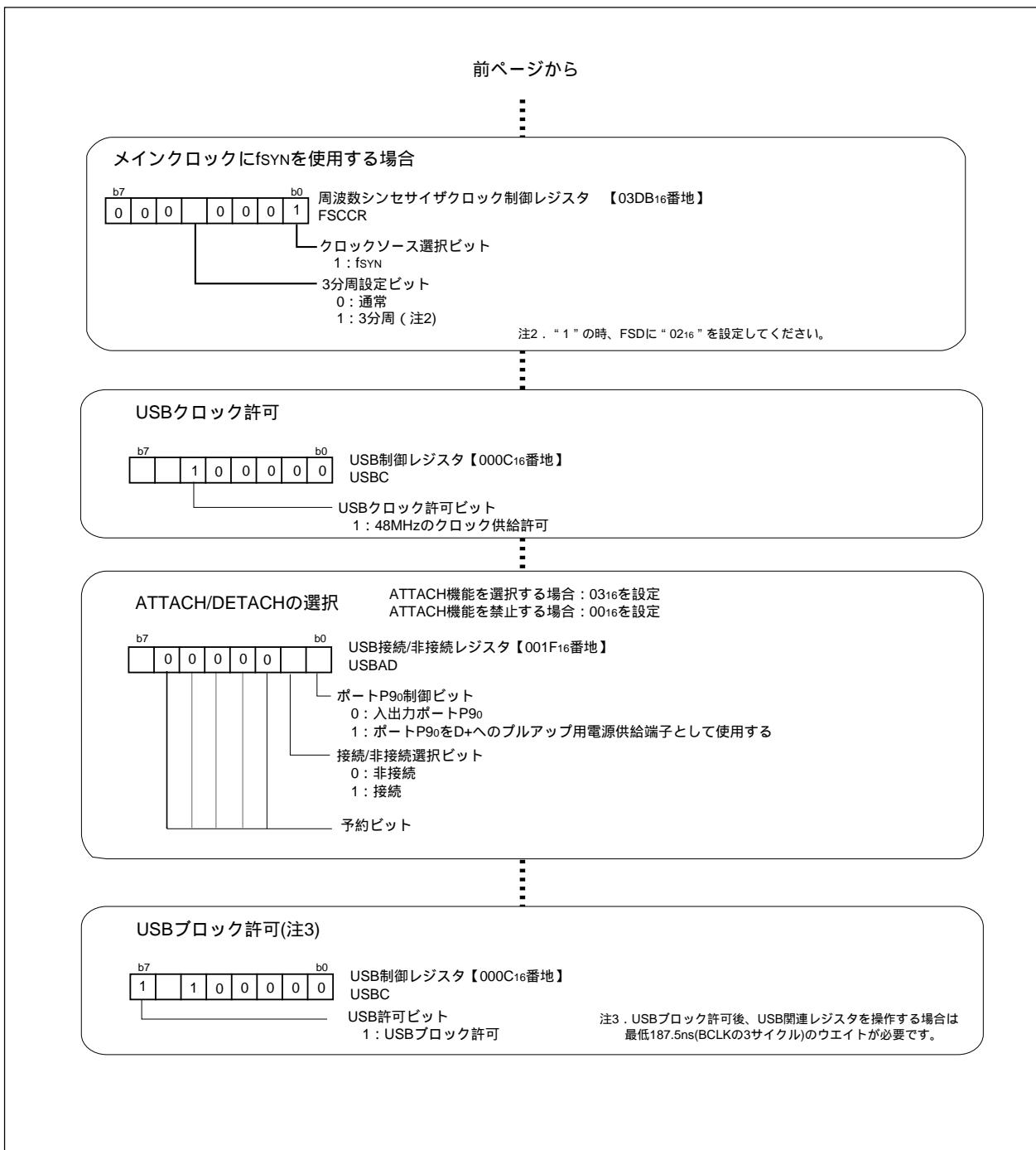
図2.8.18. 周波数シンセサイザとUSBファンクション制御ユニットの初期化手順例2
