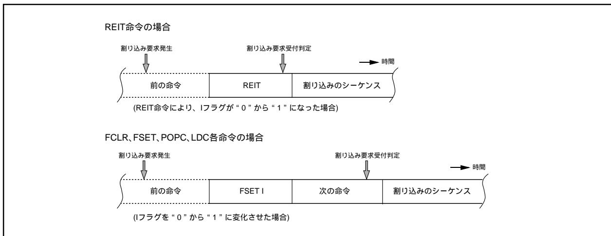
図2.15.3. Iフラグを変化させたときの割り込みへの反映のタイミング
