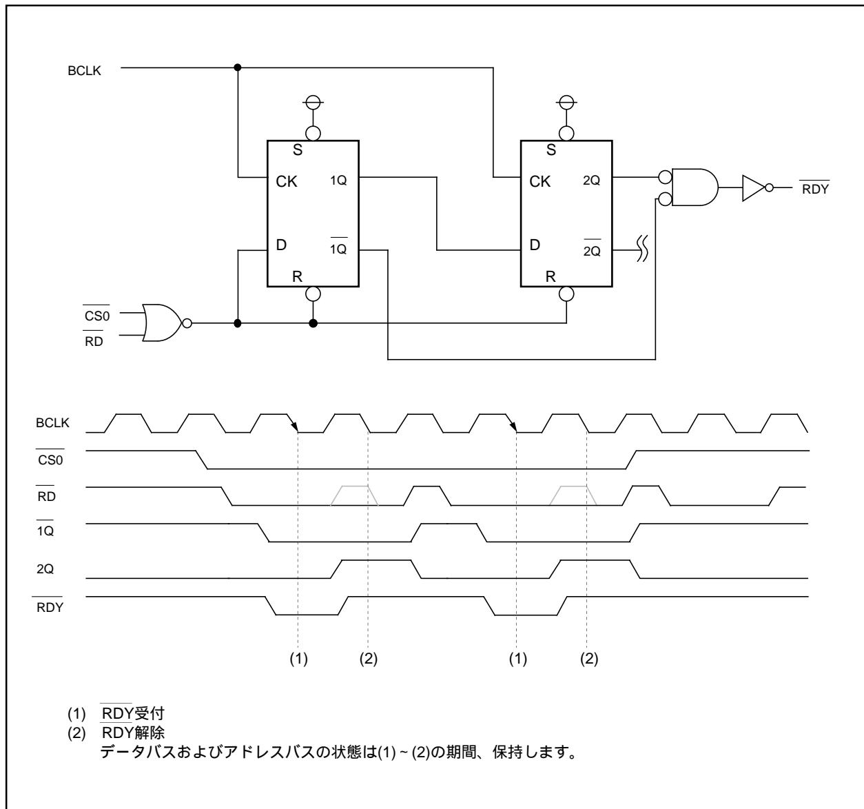
図4.4.4. 1BCLKの間バスを保持させるためのRDY回路例
