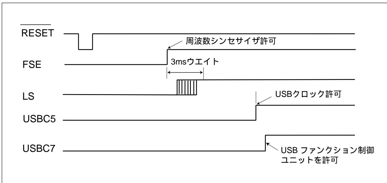
図2.8.16. ハードウェアリセット後の周波数シンセサイザのセットアップタイミング
