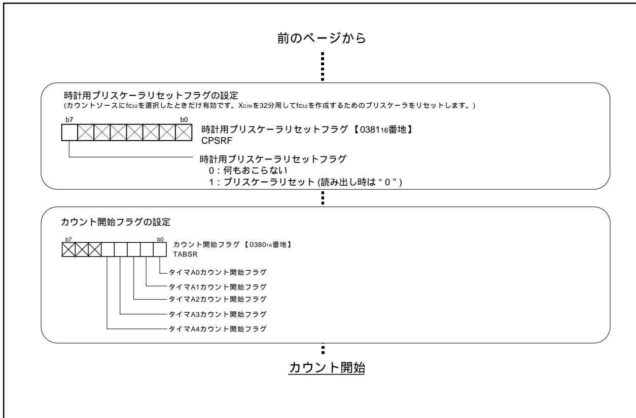
図2.2.24. パルス幅変調モード、16ビットPWMモード選択時のレジスタ設定手順(2)
