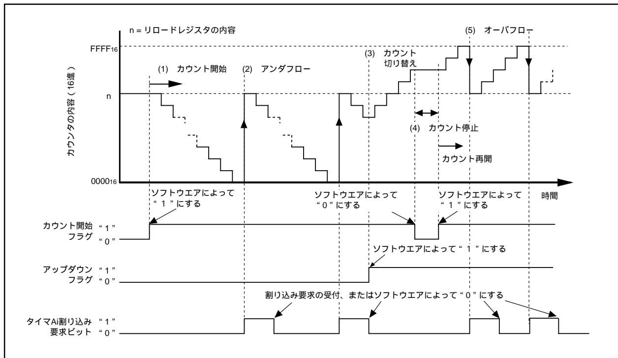
図2.2.12. イベントカウンタモード、リロードタイプ選択時の動作タイミング図
