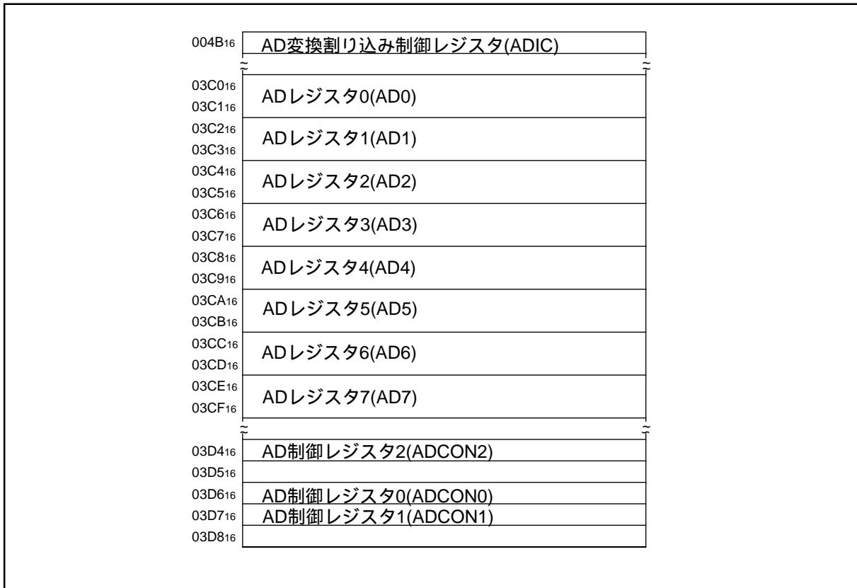
図2.9.1. A/D変換器関連レジスタのメモリ配置図
