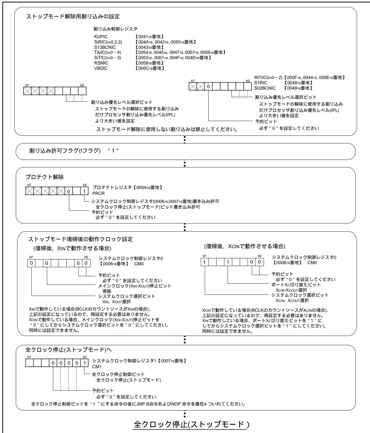
図2.16.5. ストップモードへ移行するための設定例
