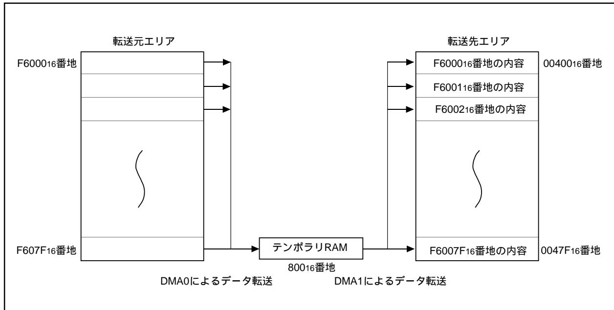
図3.5.2. メモリからメモリへのDMA転送のブロック図
