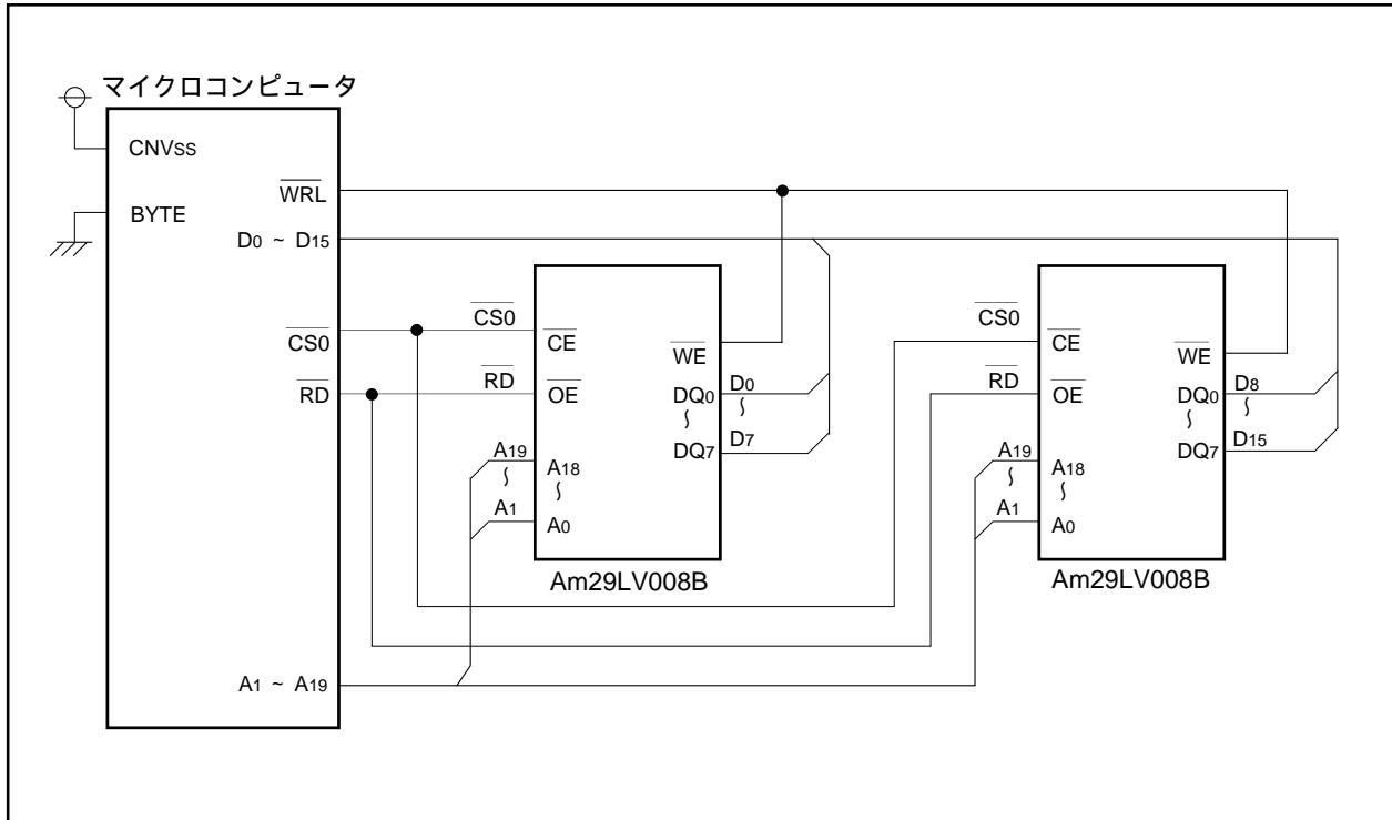
図4.3.3. Am29LV008B(1M × 8ビット)を2個、16ビットバス幅で使用する場合の接続例
