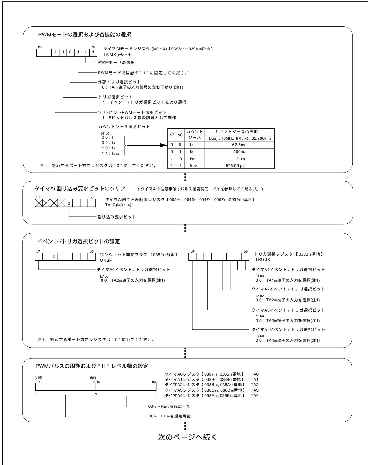
図2.2.26. パルス幅変調モード、8ビットPWMモード選択時のレジスタ設定手順(1)
