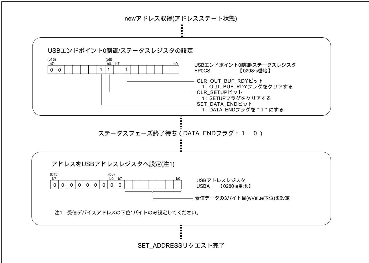
図2.8.37. SET\_ADDRESSリクエストのデバイスアドレス取得処理手順例2
