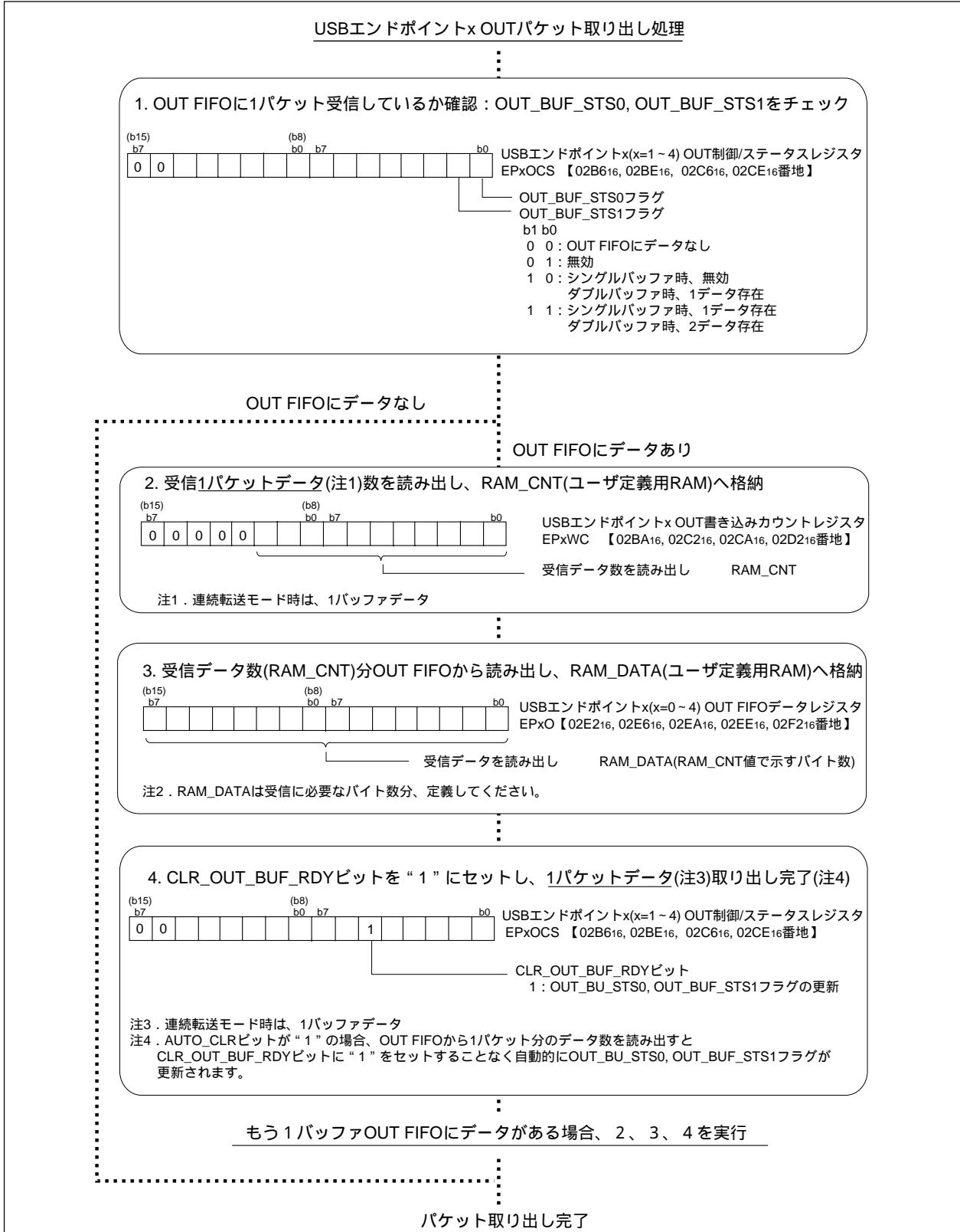
図2.8.44. エンドポイント1~4 OUTパケット取り出し手順例
