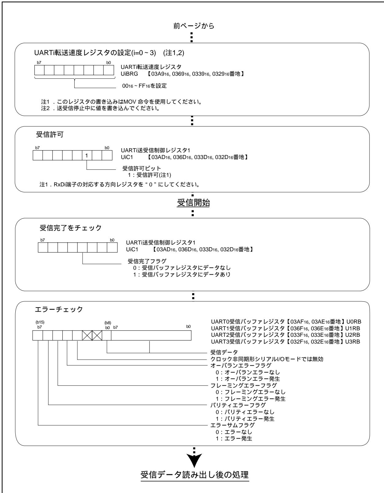
図2.4.12. クロック非同期形シリアルI/Oモードの受信時のレジスタ設定手順(2)
