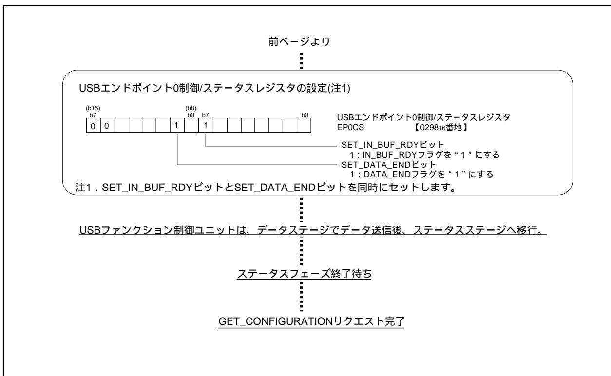
図2.8.39. GET\_CONFIGURATIONリクエストのデバイス構成値通知処理手順例2
