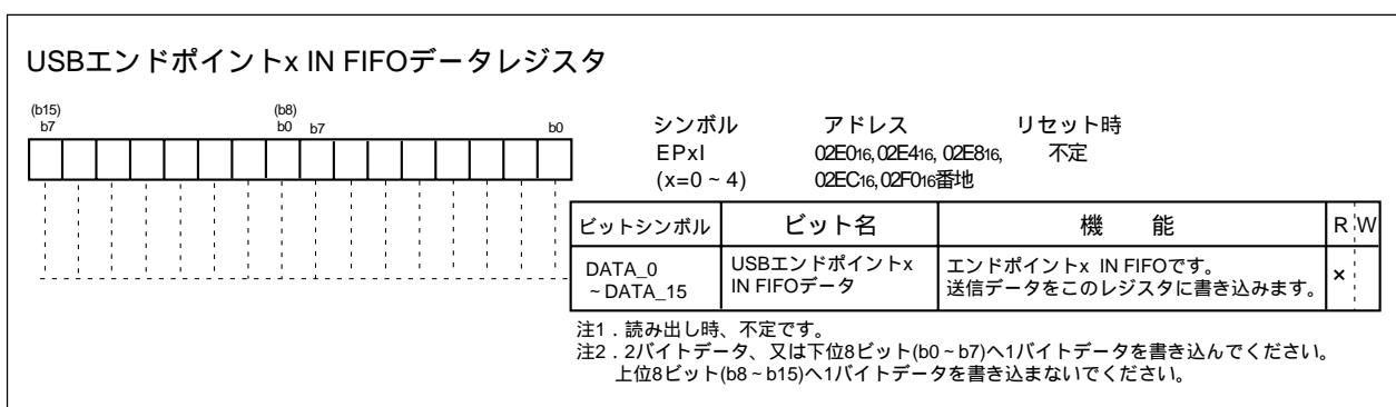
図2.8.12. USBエンドポイントx IN FIFOデータレジスタの構成
