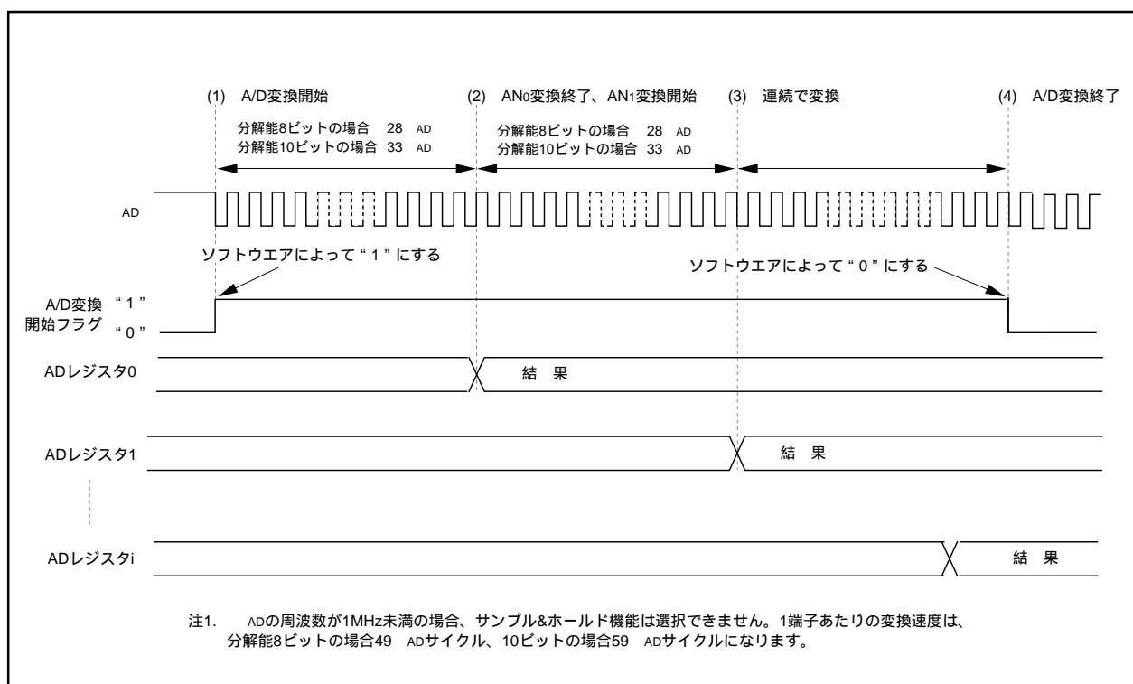
図2.9.12. 繰り返し掃引モード0動作タイミング図
