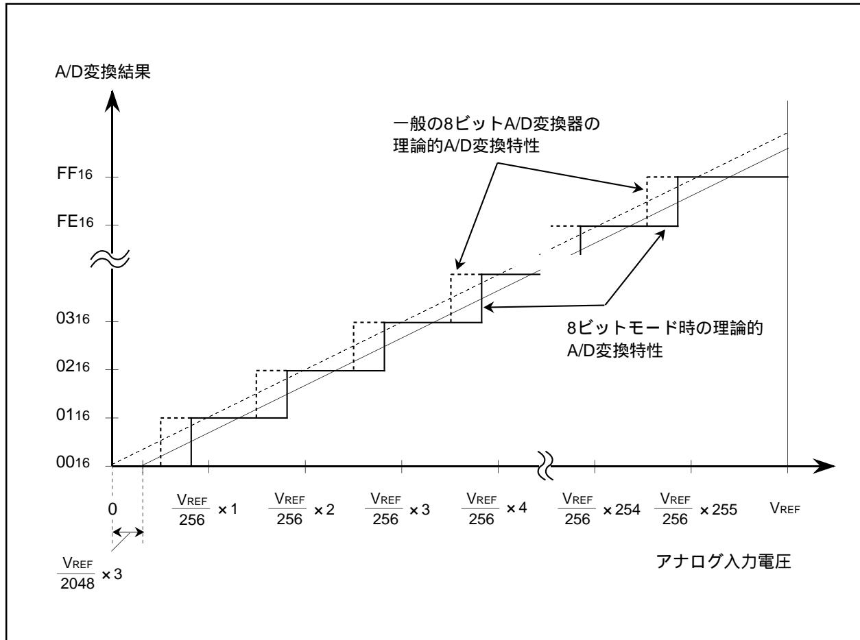
図2.9.20. 理論的A/D変換特性(8ビットモード時)
