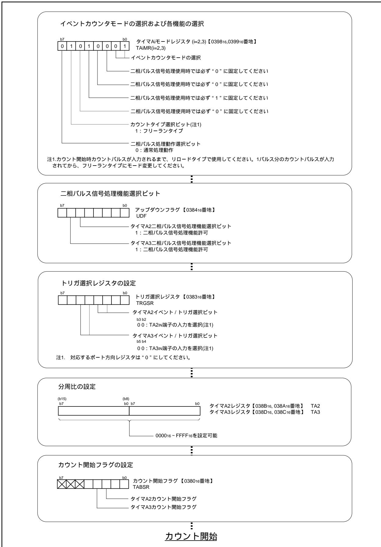
図2.2.17. イベントカウンタモード2相パルス信号処理、通常モード選択時のレジスタ設定手順
