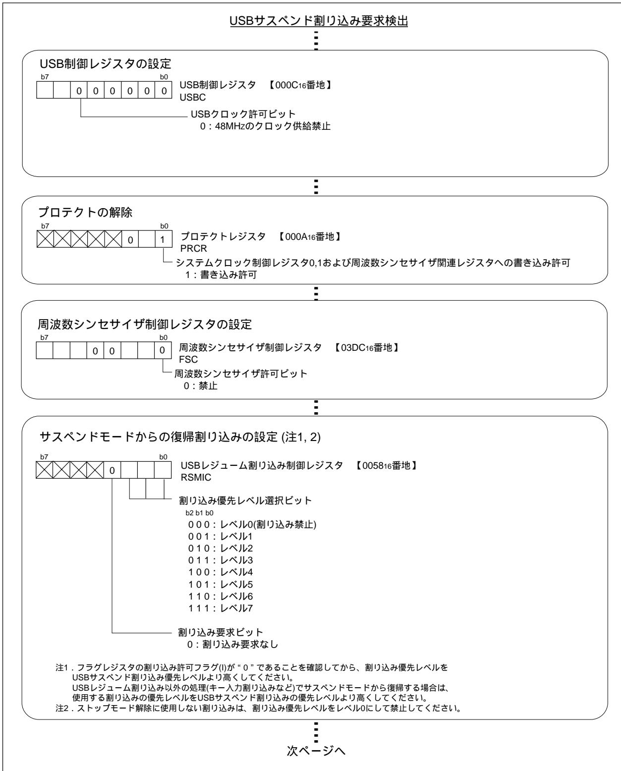
図2.8.28. USBサスPEND割り込み要求処理例(1)
