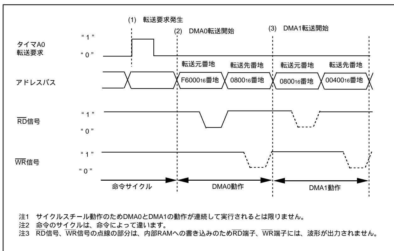
図3.5.1. メモリからメモリへのDMA転送動作タイミング
