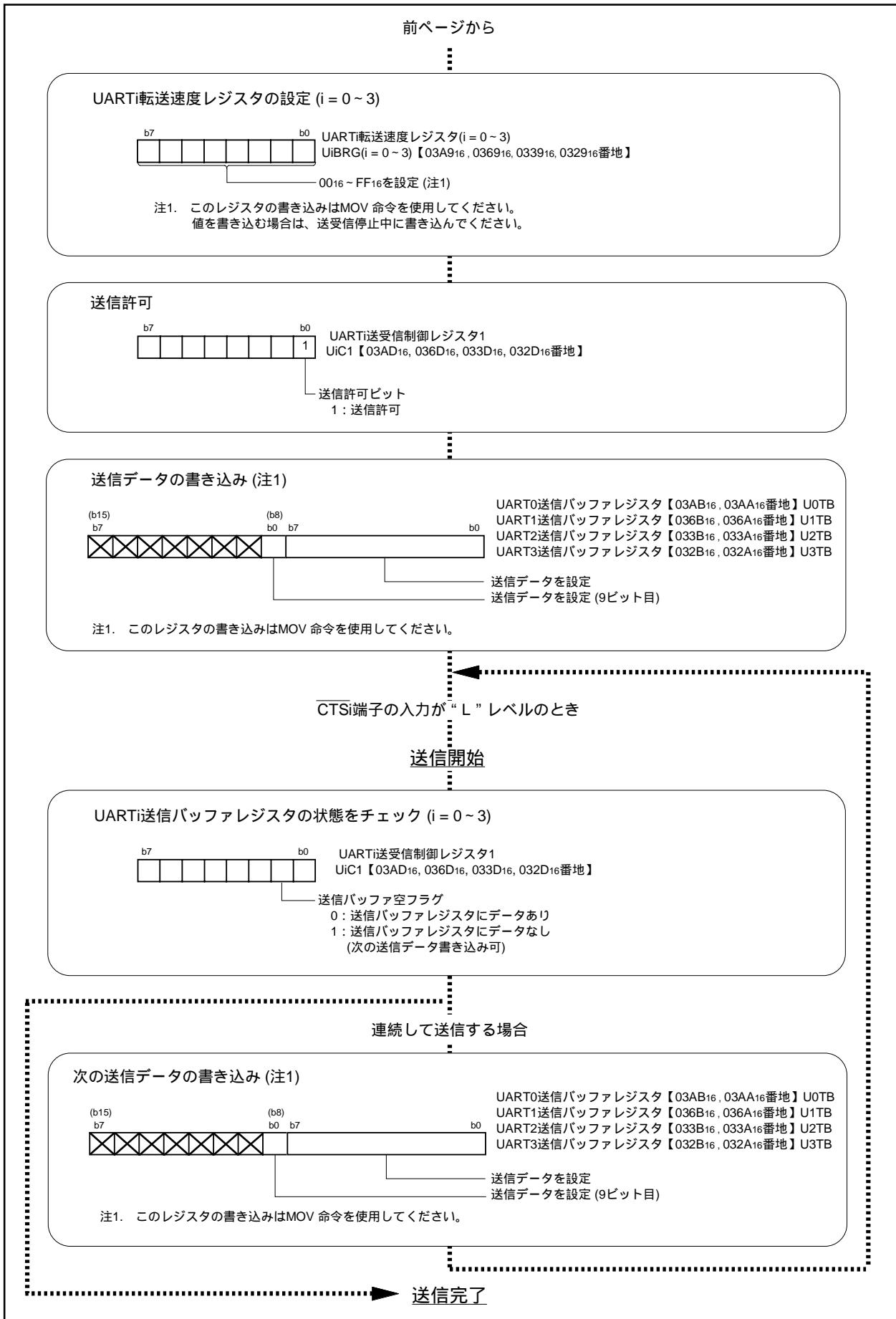
図2.3.7. クロック同期形シリアルI/Oモードの送信動作時のレジスタ設定手順(2)
