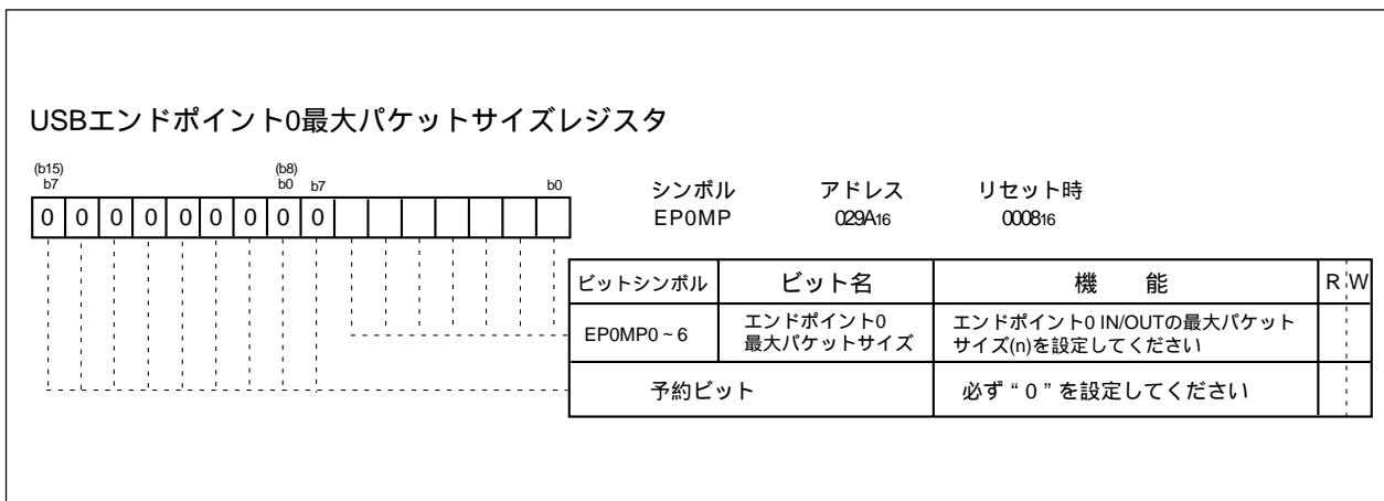
図2.8.33. USBエンドポイント0最大パケットサイズレジスタの構成
