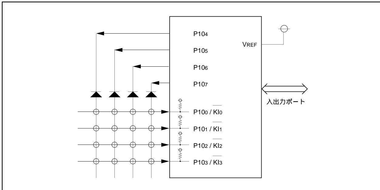
図2.14.4. キー入力割り込みに用いる回路例
