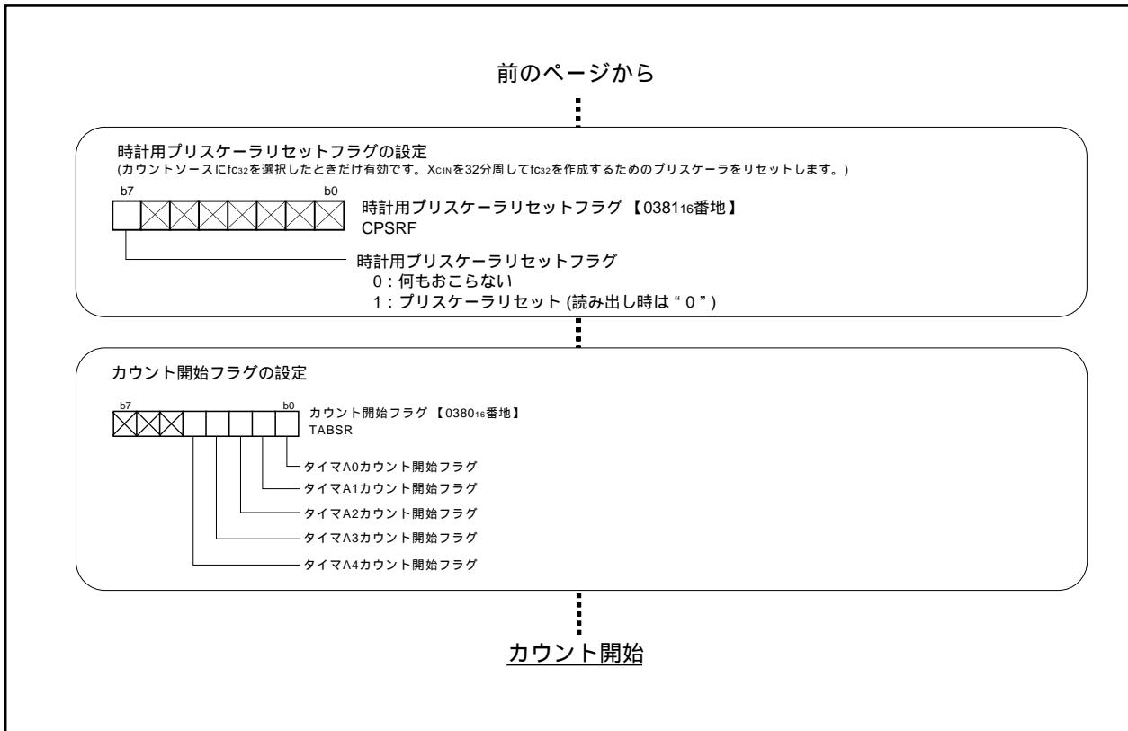
図2.2.27. パルス幅変調モード、8ビットPWMモード選択時のレジスタ設定手順(2)
