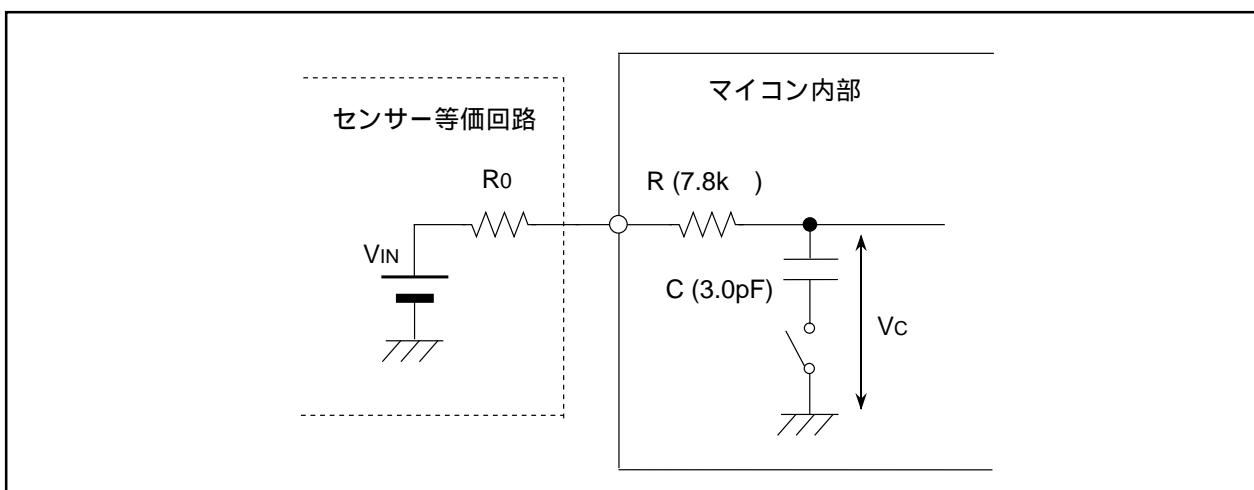
図2.9.24. A/D変換端子の等価回路
