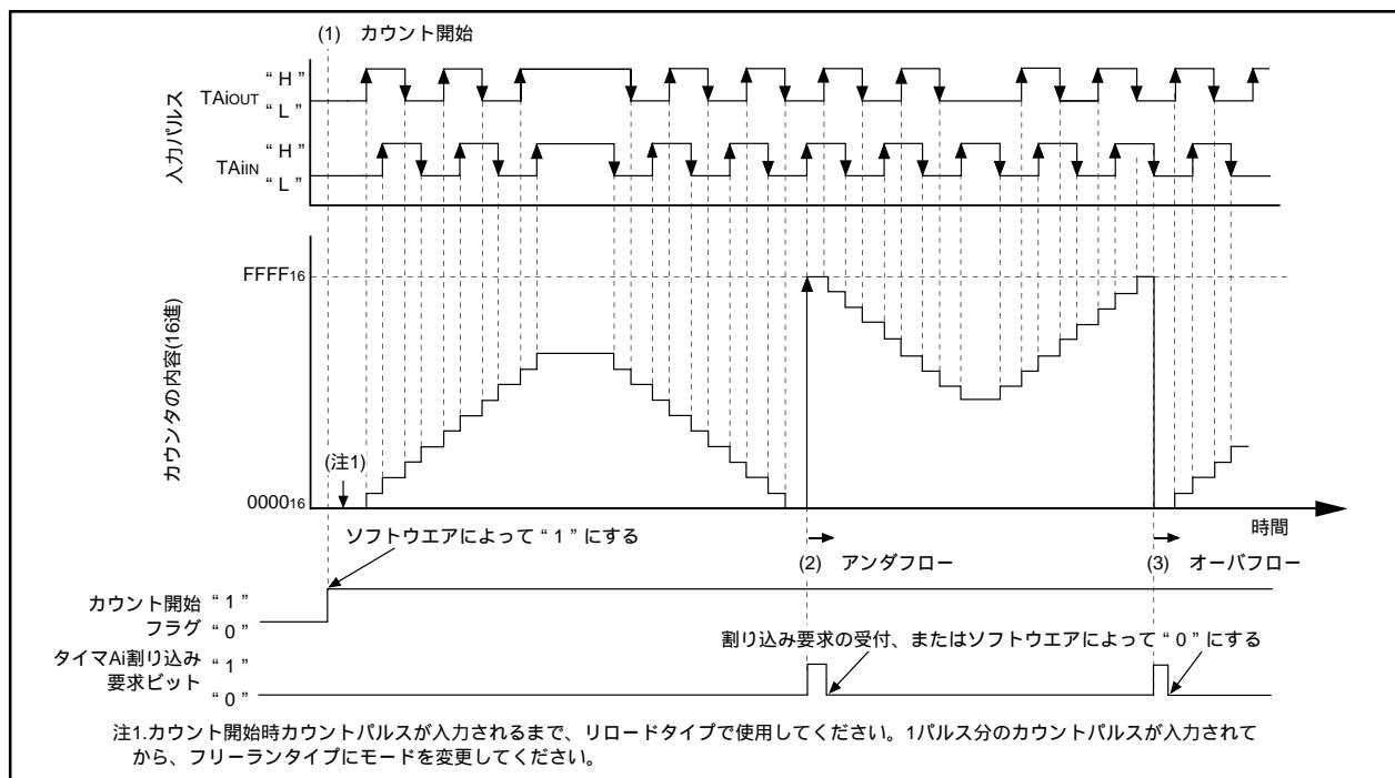
図2.2.18. イベントカウンタモード相2パルス信号処理、4倍モード選択時の動作タイミング図
