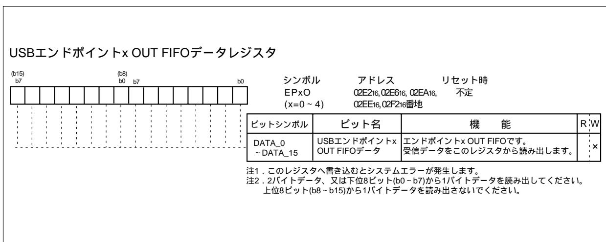
図2.8.13. USBエンドポイントx OUT FIFOデータレジスタの構成
