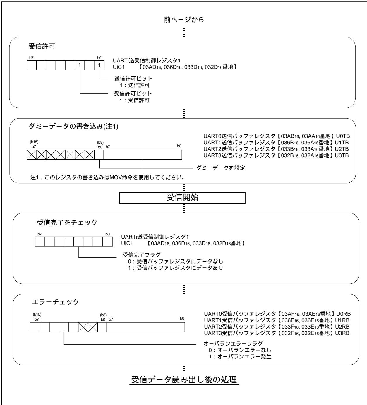
図2.3.10. クロック同期形シリアルI/Oモードの受信動作時のレジスタ設定手順(2)
