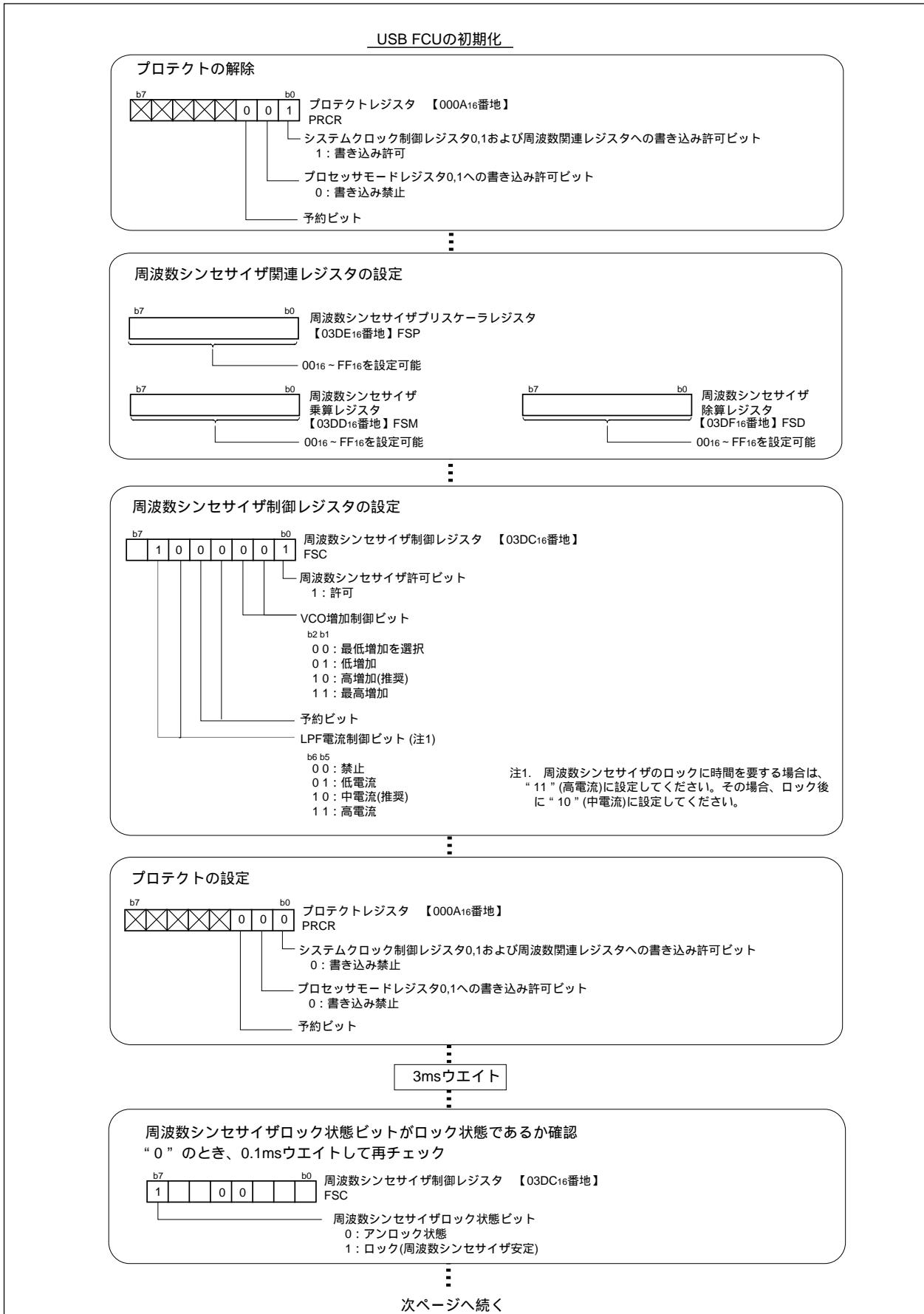
図2.8.17 周波数シンセサイザとUSBファンクション制御ユニットの初期化手順例1
