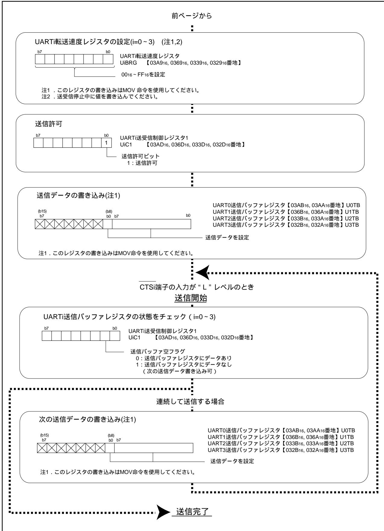
図2.4.9. クロック非同期形シリアルI/Oモードの送信時のレジスタ設定手順(2)
