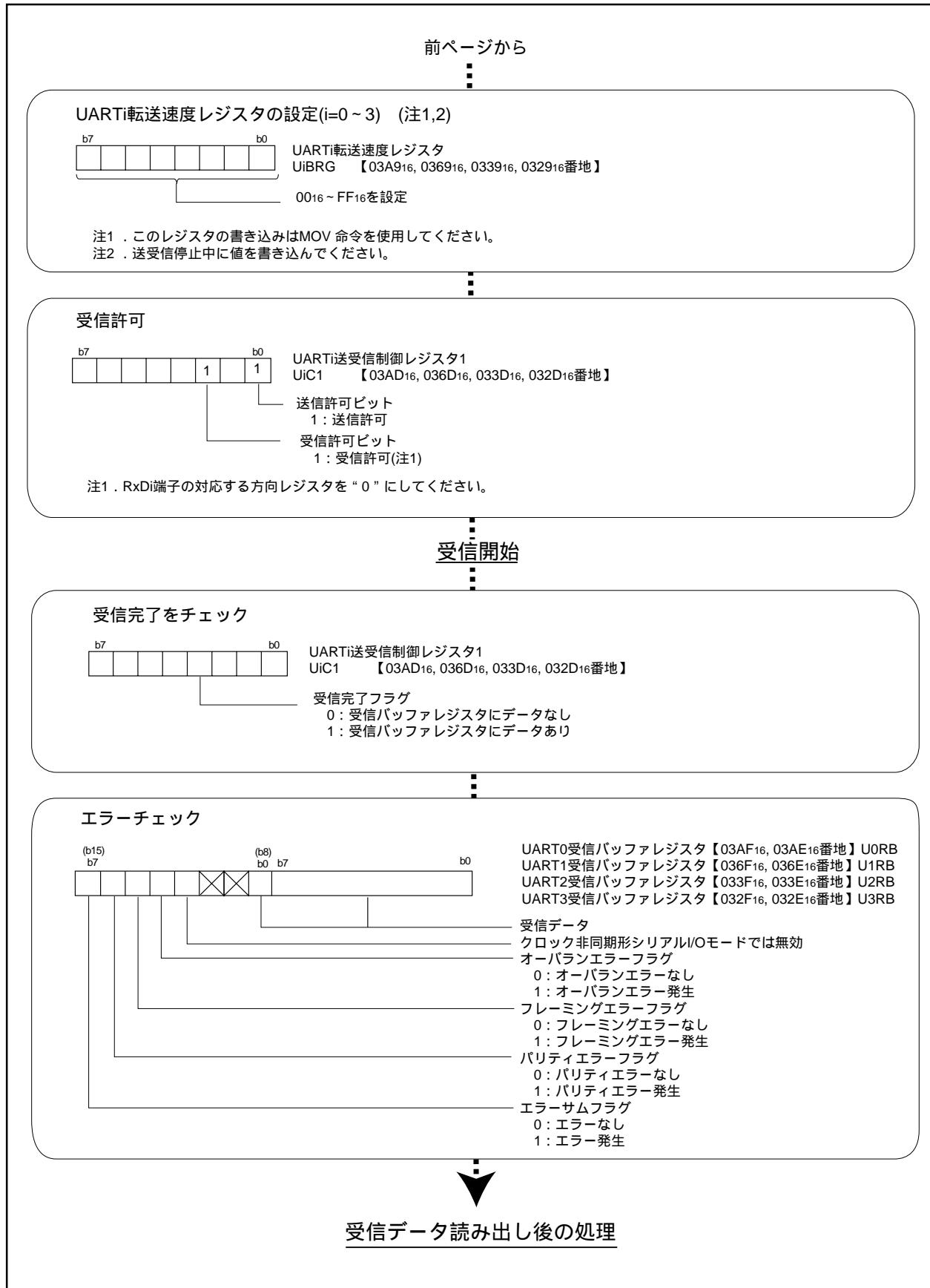
図2.4.18. クロック非同期形シリアルI/Oモード(SIMインターフェース対応時)の受信動作時のレジスタ設定手順(2)
