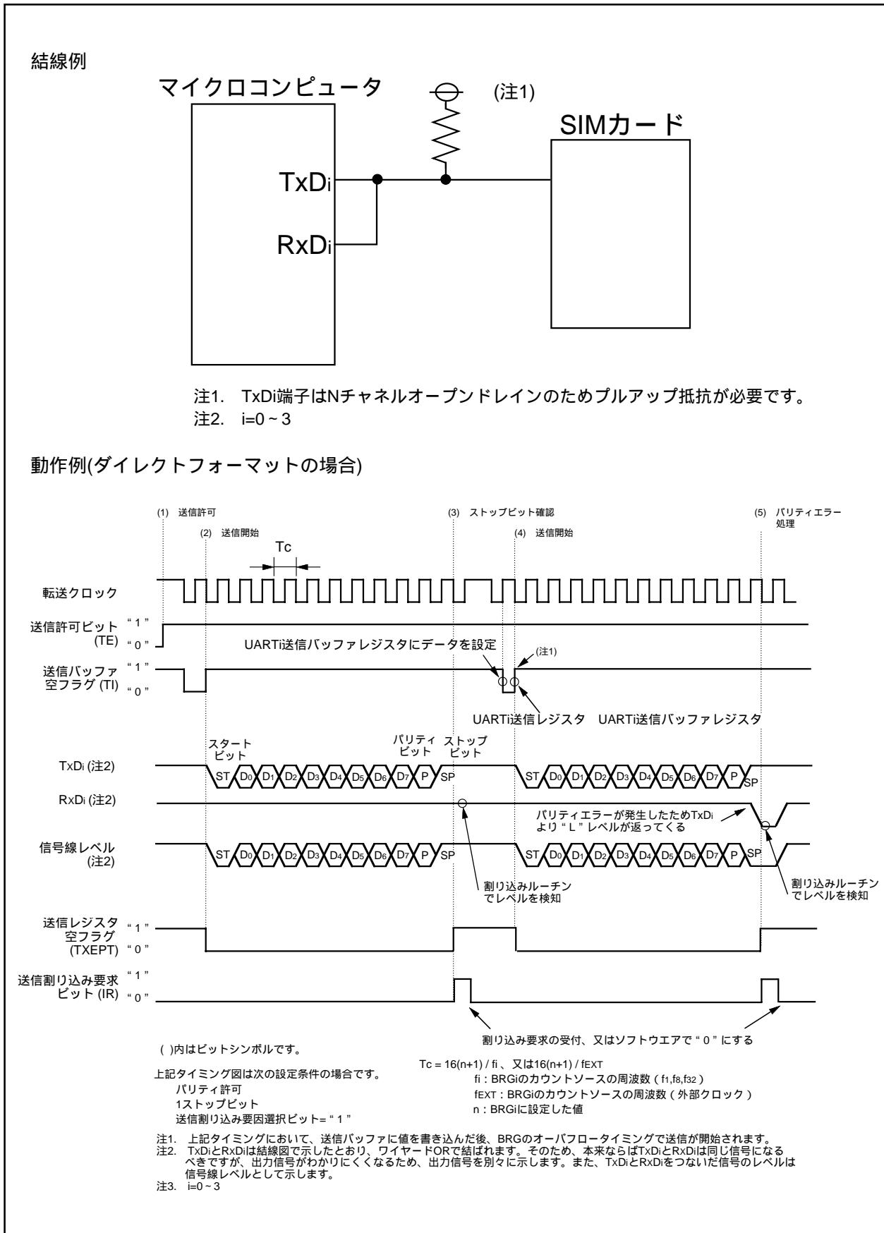
図2.4.13. クロック非同期形シリアルI/Oモード(SIMインターフェース対応)の送信動作タイミング図
