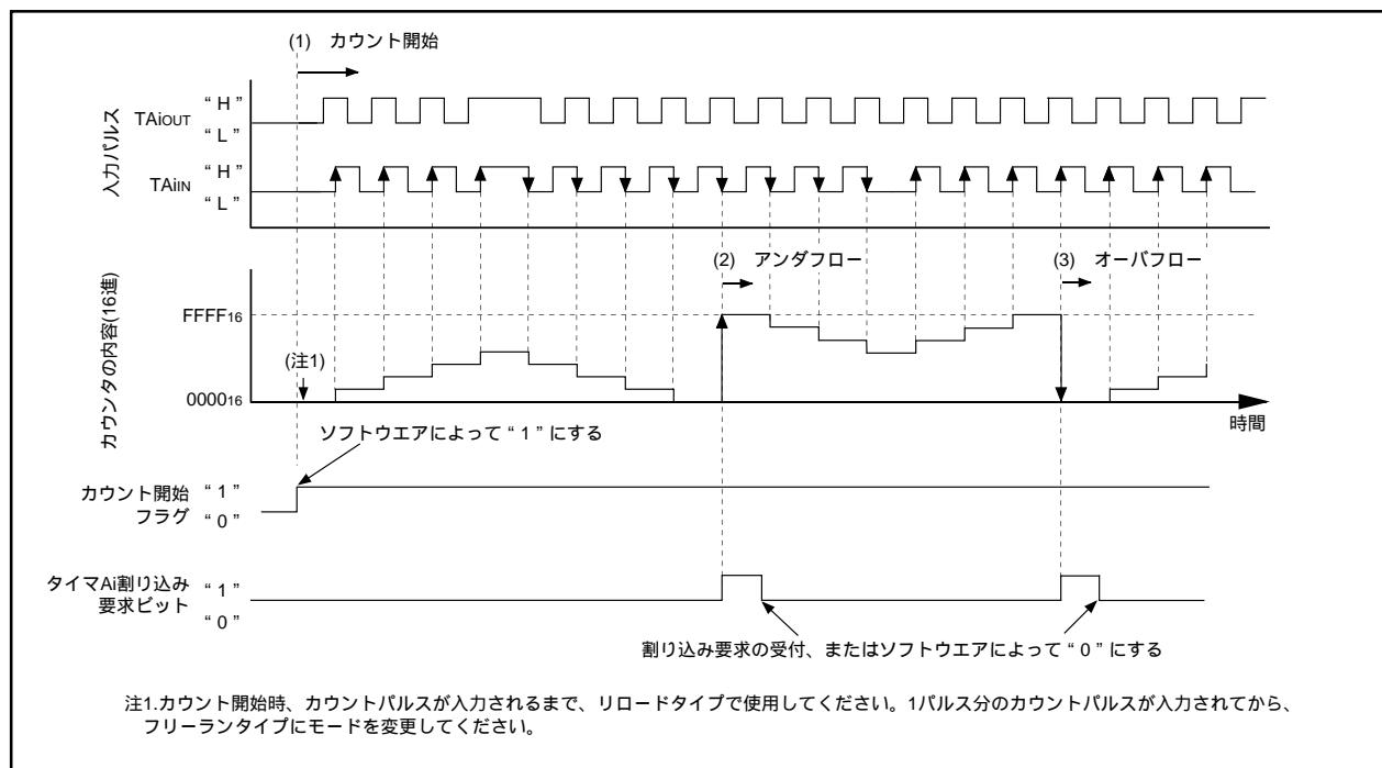
図2.2.16. イベントカウンタモード2相パルス信号処理、通常モード選択時の動作タイミング図
