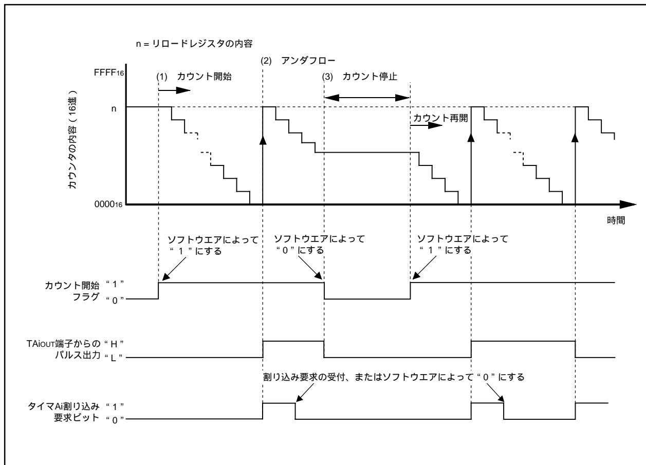
図2.2.10. タイマモード、パルス出力機能選択時の動作タイミング図
