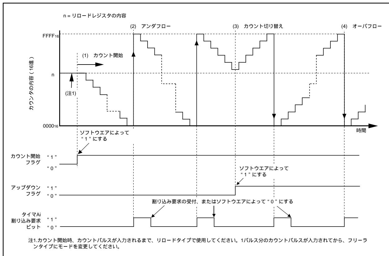
図2.2.14. イベントカウンタモード、フリーランタイプ選択時の動作タイミング図
