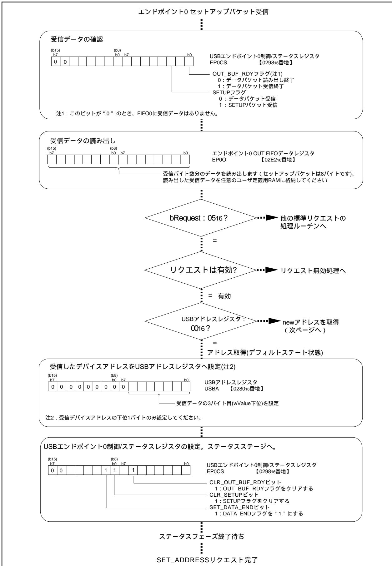
図2.8.36. SET\_ADDRESSリクエストのデバイスアドレス取得処理手順例1
