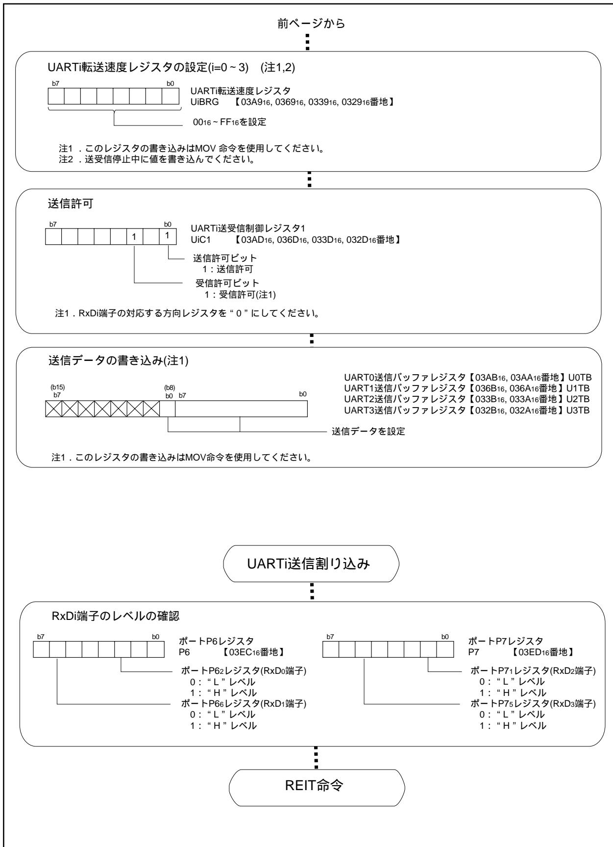
図2.4.15. クロック非同期形シリアルI/Oモード(SIMインターフェース対応)の送信動作時のレジスタ設定手順(2)
