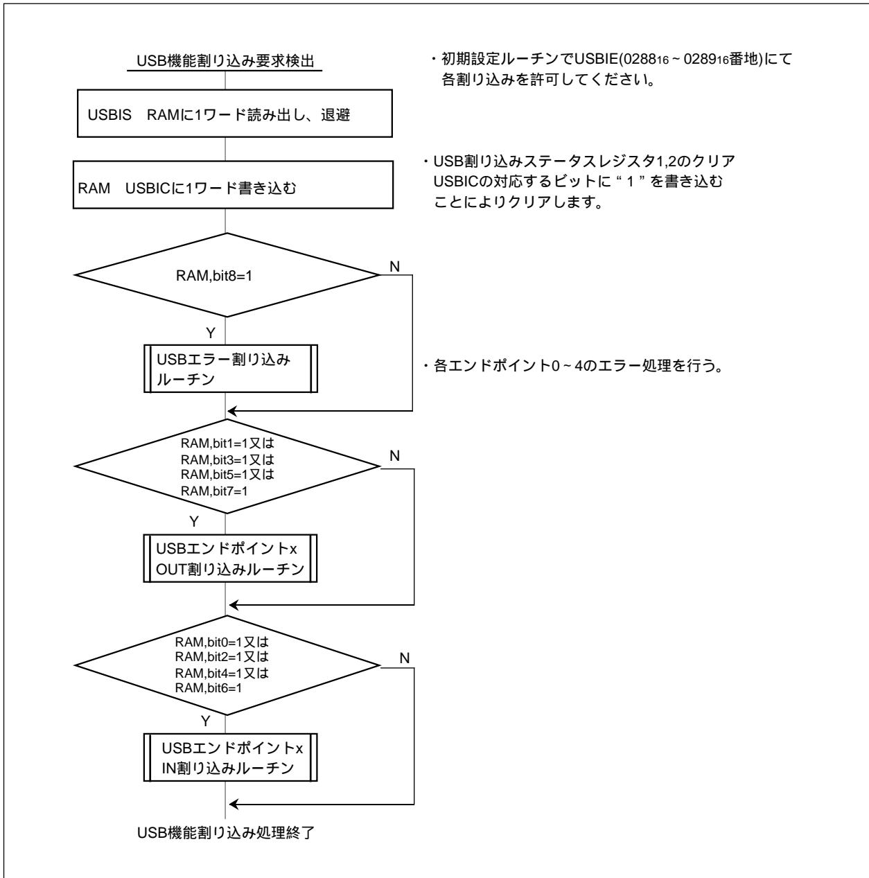
図2.8.26. USB機能割り込み処理例
