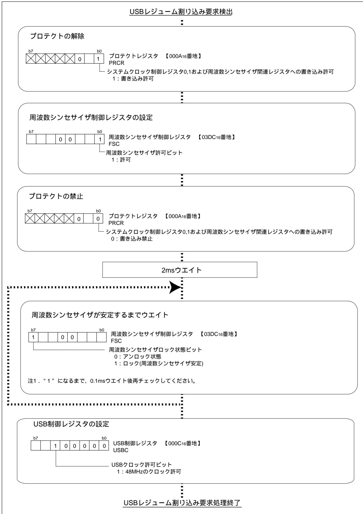
図2.8.30. USBレジューム割り込み要求処理例
