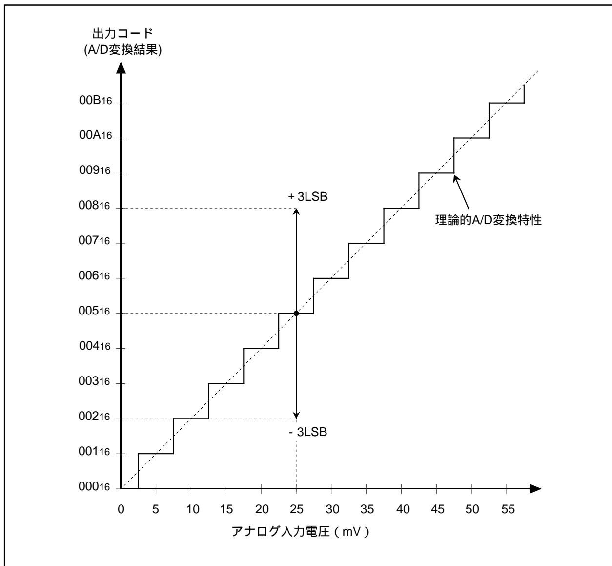
図2.9.21. 絶対精度(分解能10ビット時)
