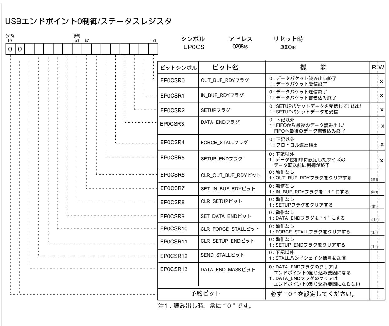
図2.8.32. USBエンドポイント0制御/ステータスレジスタの構成
