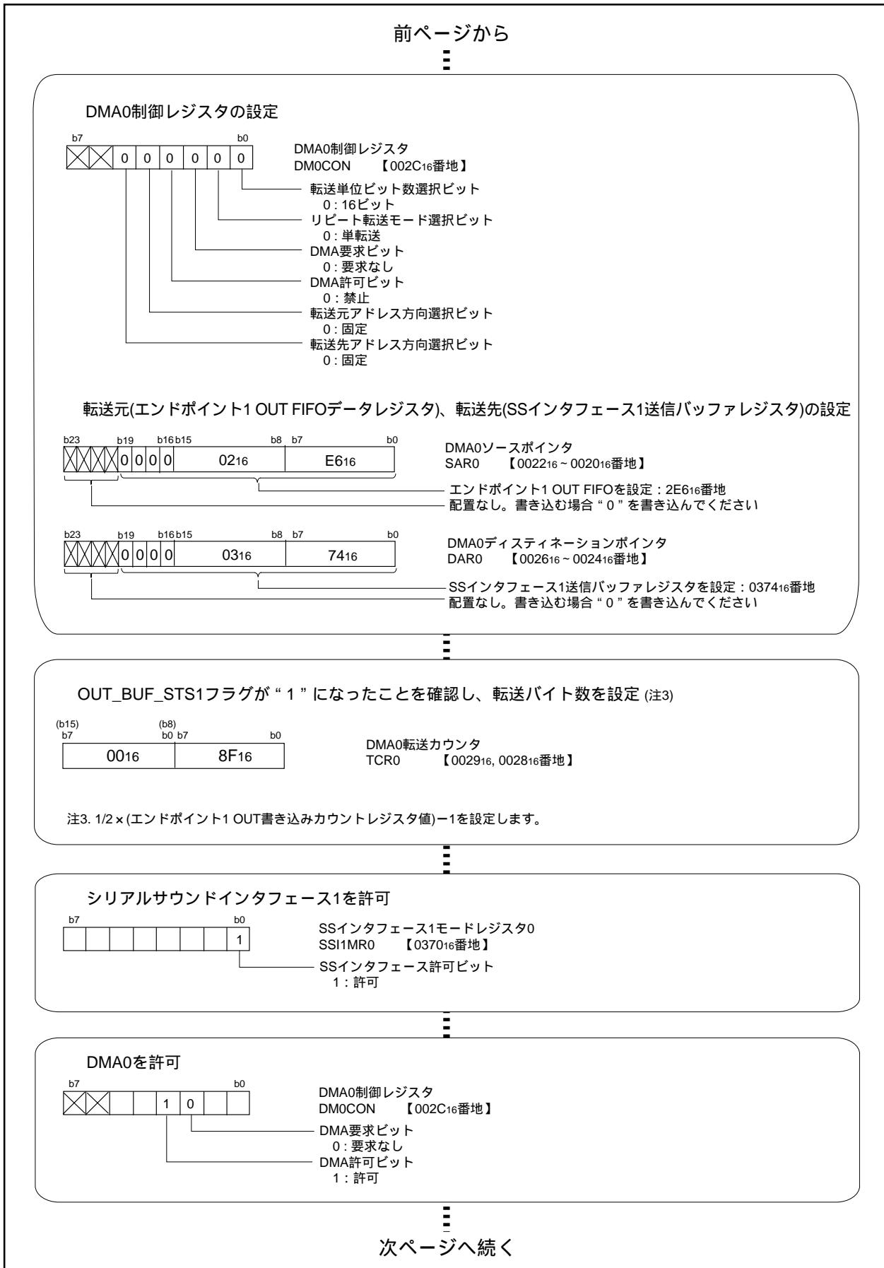
図3.7.3. USB OUT FIFOからシリアルサウンドインターフェースへのDMA転送設定手順例(2)
