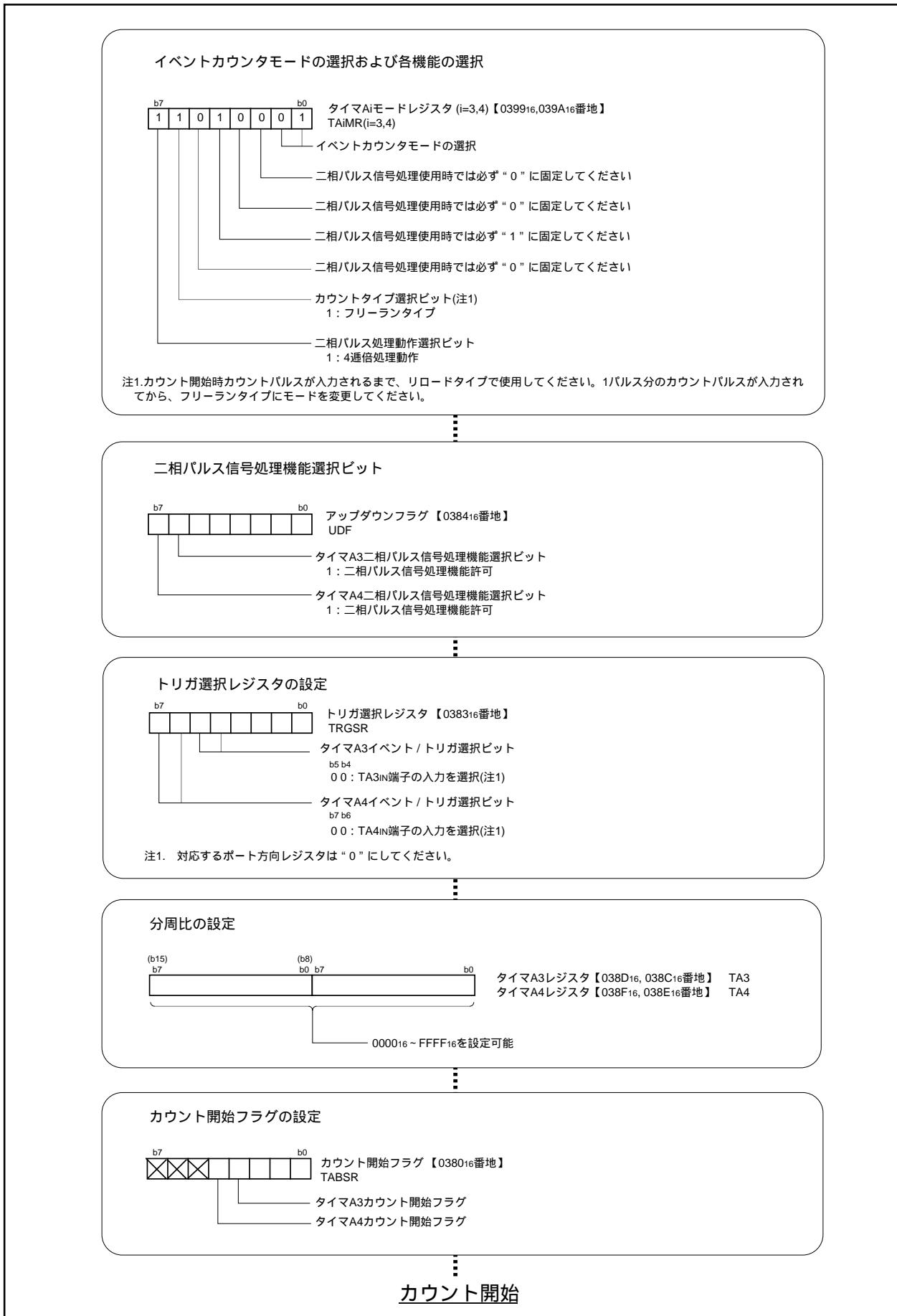
図2.2.19. イベントカウンタモード2相パルス信号処理、4倍モード選択時のレジスタ設定手順
