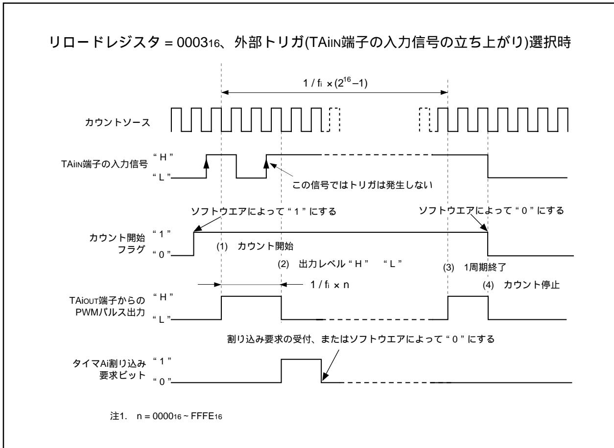
図2.2.22. パルス幅変調モード動作、16ビットPWMモード選択時のタイミング図
