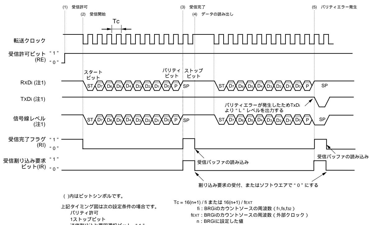
注1. TxD<sub>i</sub>とRxD<sub>i</sub>は結線図で示したとおり、ワイヤードORで結ばれます。そのため、本来ならばTxD<sub>i</sub>とRxD<sub>i</sub>は同じ信号になるべきですが、出力信号がわかりにくくなるため、出力信号を別々に示します。また、TxD<sub>i</sub>とRxD<sub>i</sub>をつないだ信号のレベルは信号線レベルとして示します。
