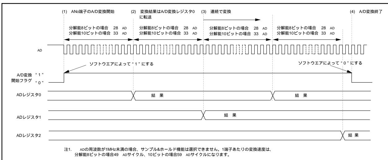
図2.9.15. 繰り返し掃引モード1動作タイミング図
