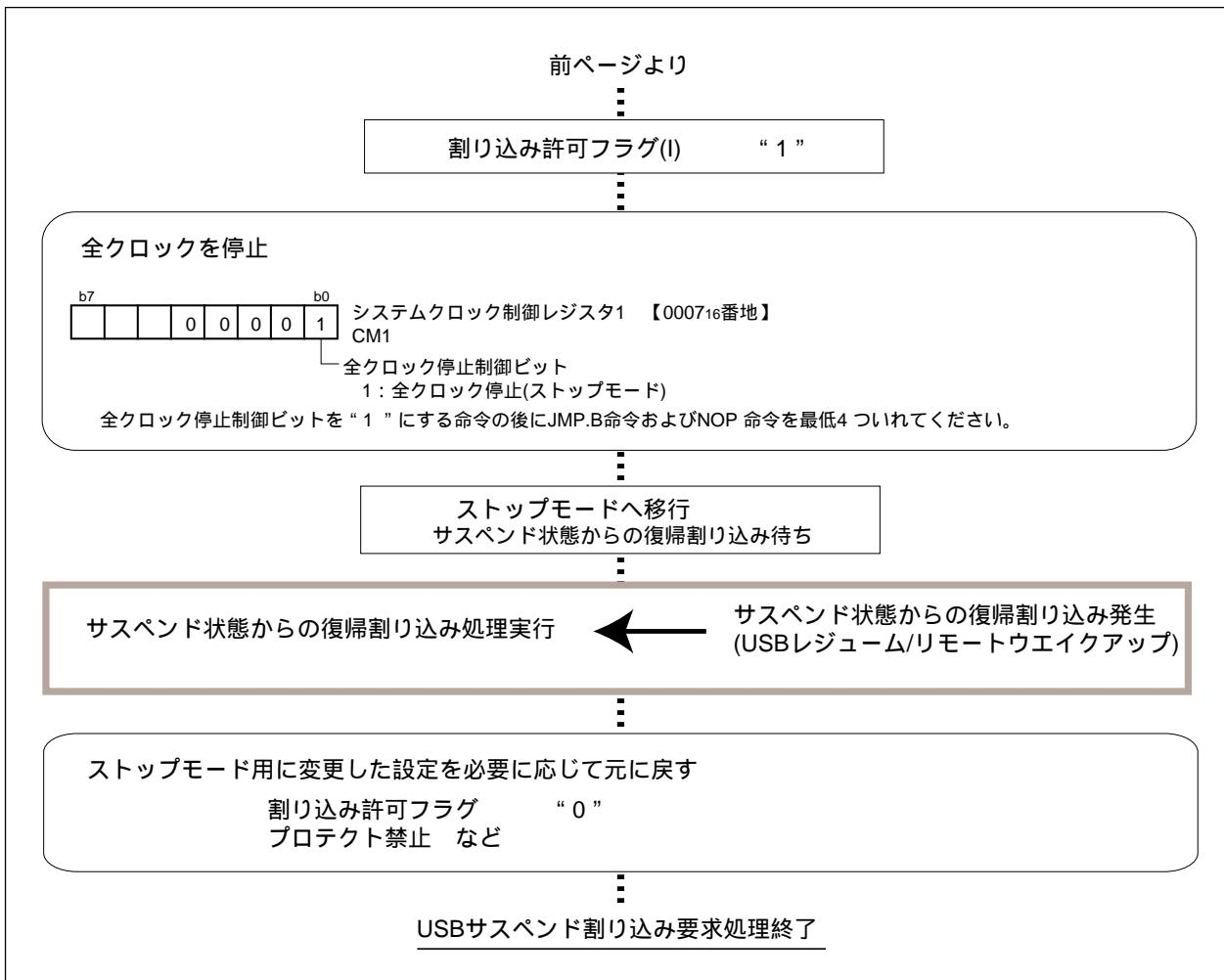
図2.8.29. USBサスペンド割り込み要求処理例(2)
