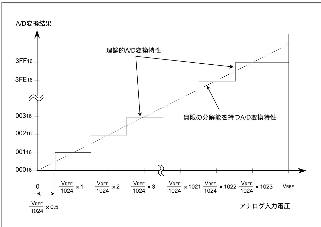
図2.9.18. 理論的A/D変換特性(10ビットモード時)
