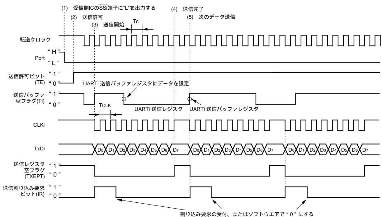
図2.5.8. シリアルインタフェース特殊機能マスタモード、クロック遅れなし送信動作タイミング図
