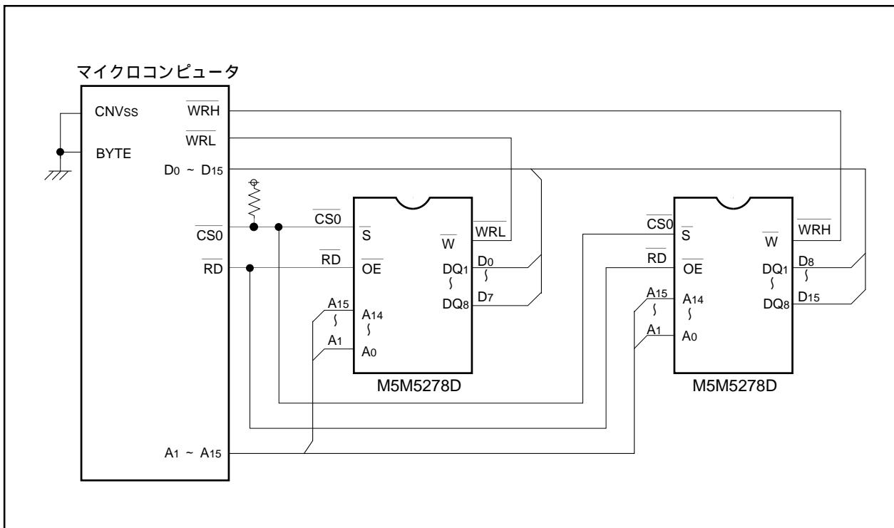
図4.3.2. M5M5278(32K×8ビット)を2個、16ビットバス幅で使用する場合の接続例
