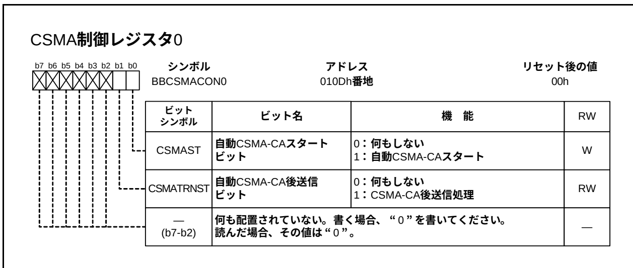
図15.23 CSMA制御レジスタ0の構成
