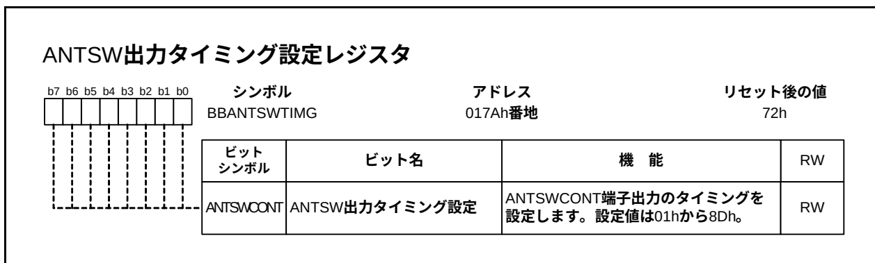
図 15.43 ANTSW 出力タイミング設定レジスタの構成
