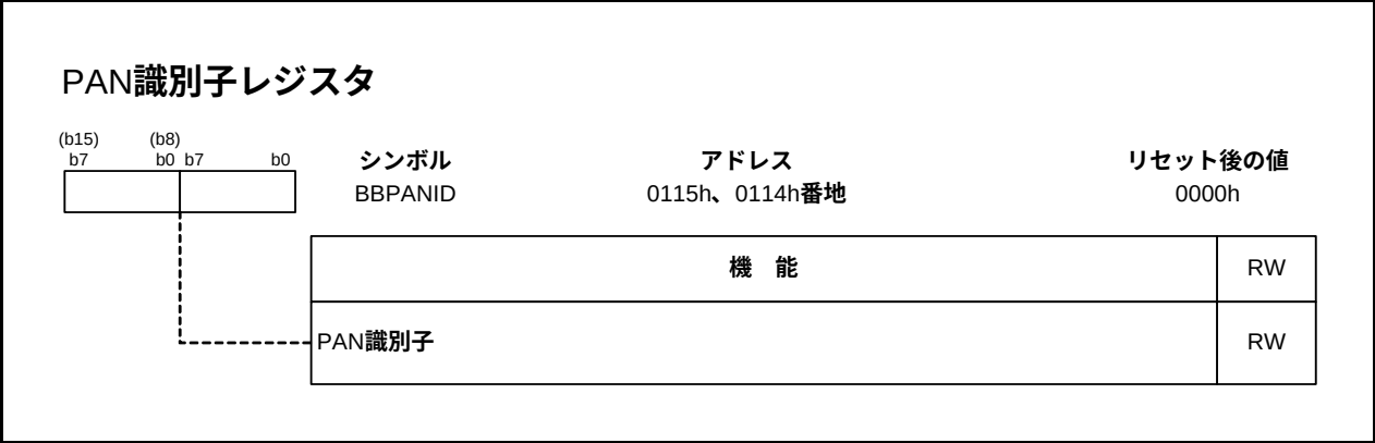
図 15.30 PAN 識別子レジスタの構成
