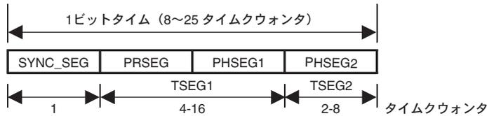
SYNC\_SEG : CAN バス上のノードの同期をするセグメント (通常のビットエッジ遷移がこのセグメントで発生します)
