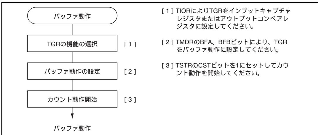
図 10.18 バッファ動作の設定手順例
