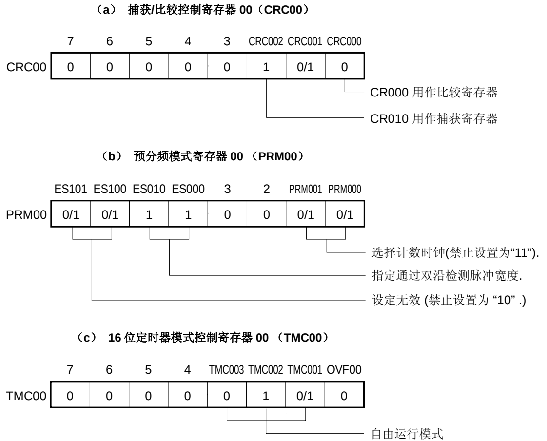
图 6-18. 通过自由运行计数器和一个捕获寄存器测量脉冲宽度的控制寄存器设置（使用 TI000 和 CR010 时）
