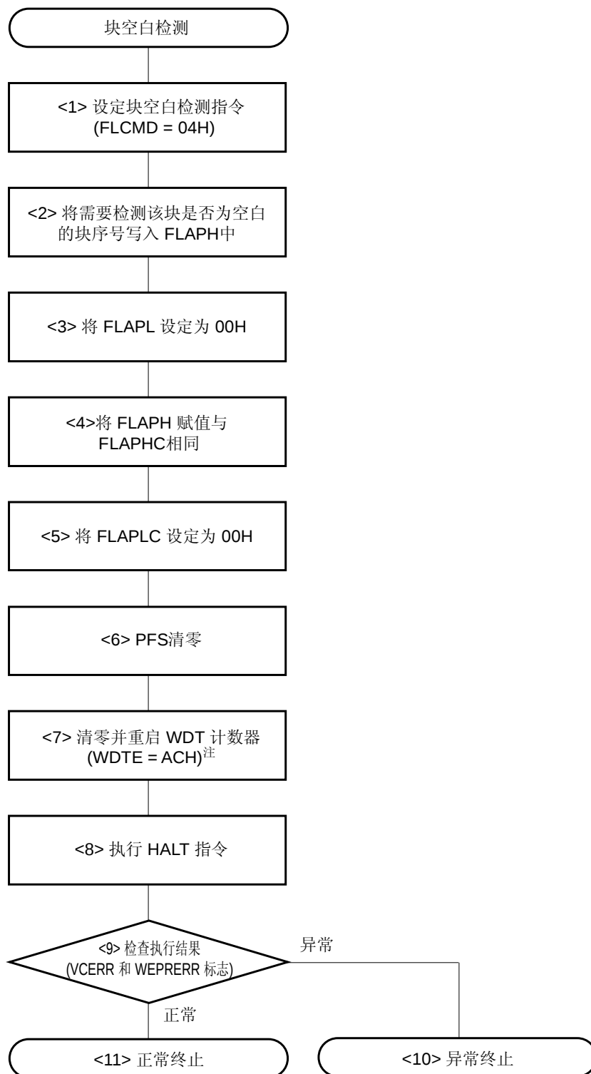
图 19-21. 在自编程模式下空白块校验操作流程
