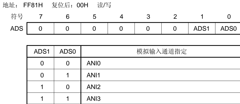
图 10-5. 模拟输入通道选择寄存器 (ADS) 的格式
