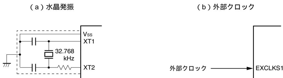
注意1. X1発振回路およびXT1発振回路を使用する場合は、配線容量などの影響を避けるために、図5 - 11, 5 - 12の破線の部分を次のように配線してください。
