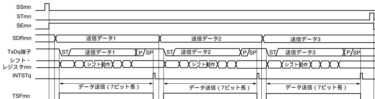
図13 - 75 UART送信 (シングル送信モード時) のタイミング・チャート
