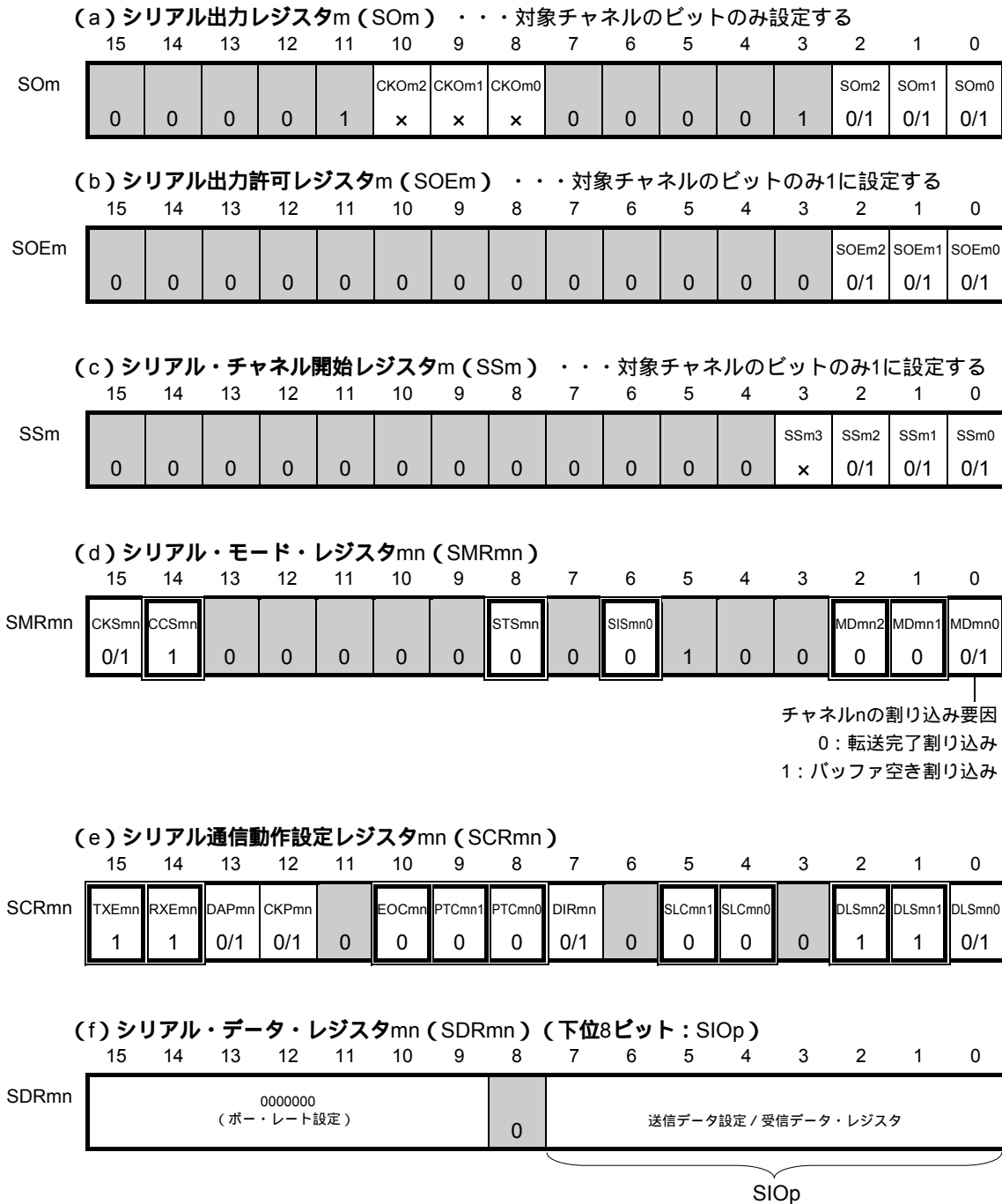
図13 - 62 3線シリアルI/O (CSI00, CSI01, CSI10, CSI20) のスレーブ送受信時のレジスタ設定内容例
