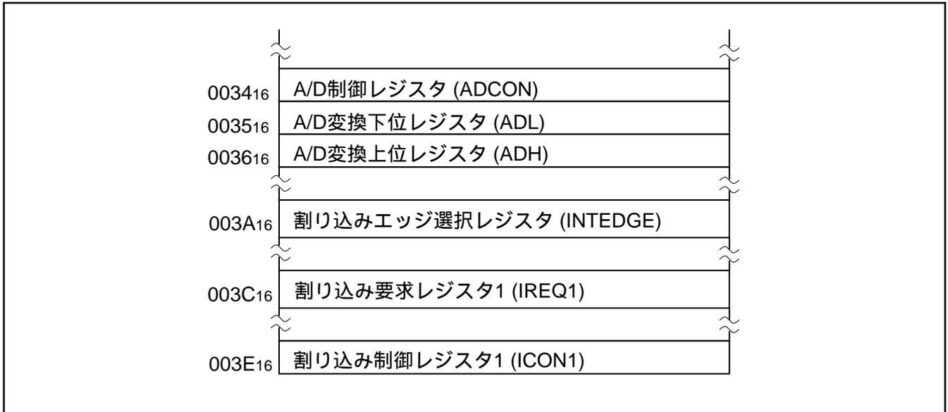
図2.5.1 A/D変換器関連レジスタのメモリ配置
