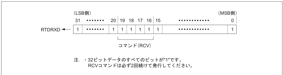
図14.3.10 RCVコマンドデータフォーマット印加
