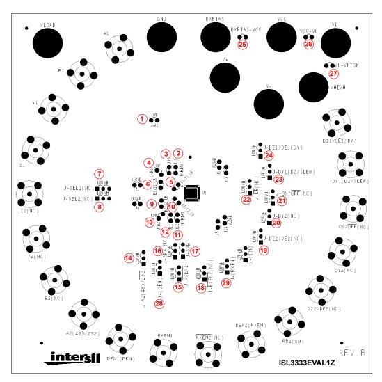
FIGURE 3. JUMPER LOCATOR DIAGRAM
