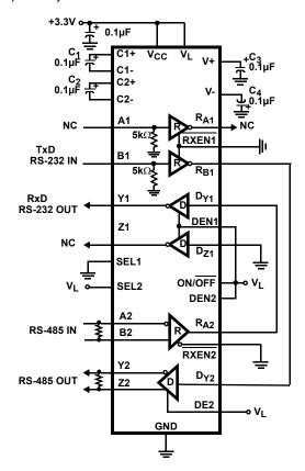
FIGURE 1. SINGLE IC RS-232 TO RS-485 CONVERTER
