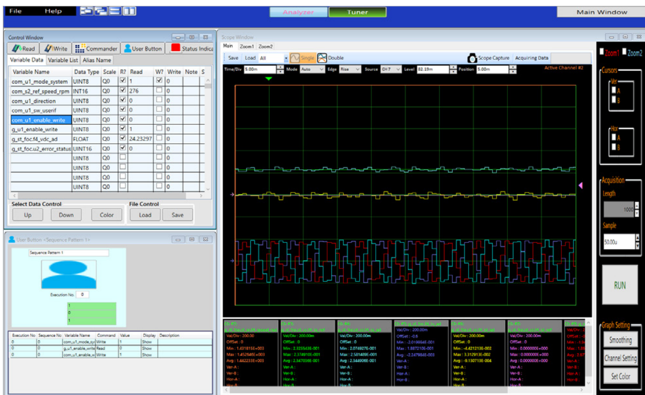
図6-3: Motor Workbench では、パラメータのオートチューニングと実行中のシステムのモニタが可能
