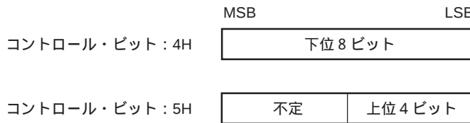
図 2 - 3 ロック・アドレスの構成
