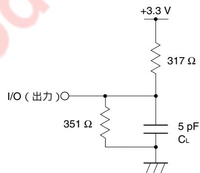
備考  $C_L$  は測定器のプロープと治具の容量, 浮遊容量を含みます。
