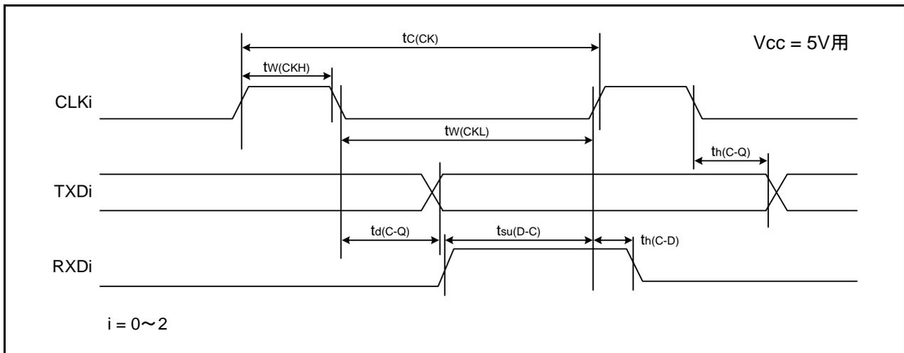
図5.6 Vcc = 5V時のシリアルインタフェースのタイミング
