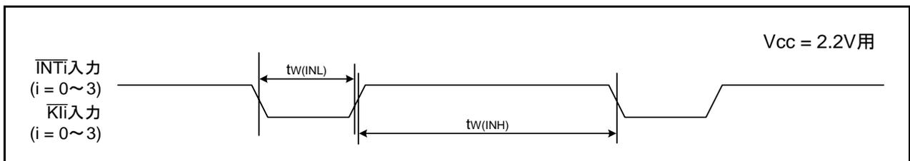
図 5.15  $V_{cc} = 2.2\text{V}$ 時の外部割り込み  $\overline{\text{INT}}_i$  およびキー入力割り込み  $\overline{\text{Kli}}$  入力のタイミング
