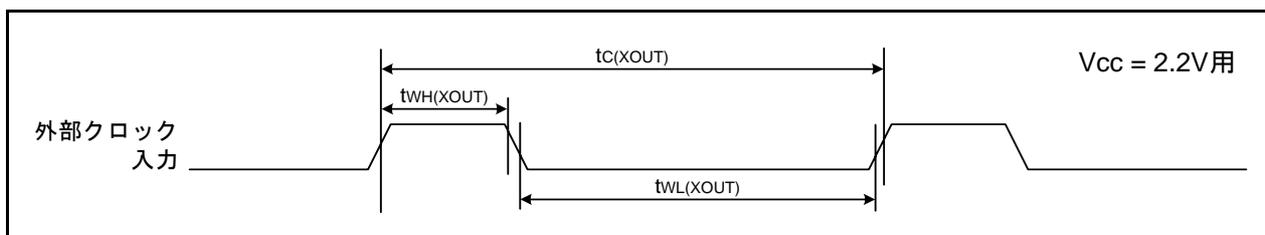
図5.12  $V_{CC} = 2.2V$ 時の外部クロック入力のタイミング
