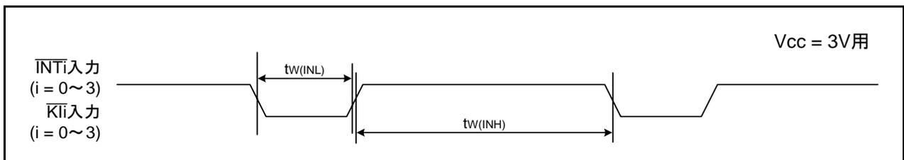
図5.11 Vcc = 3V時の外部割り込みINTiおよびキー入力割り込みKli入力のタイミング
