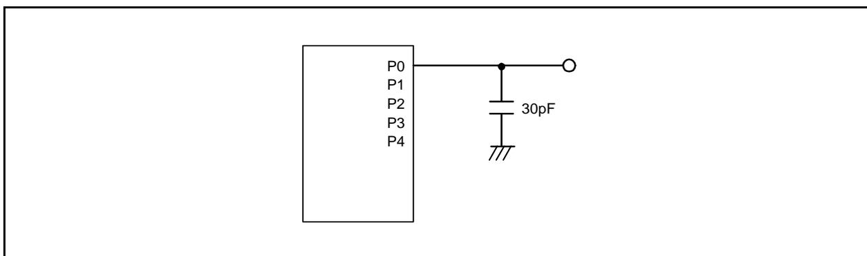
図5.1 ポートP0～P4のタイミング測定回路
