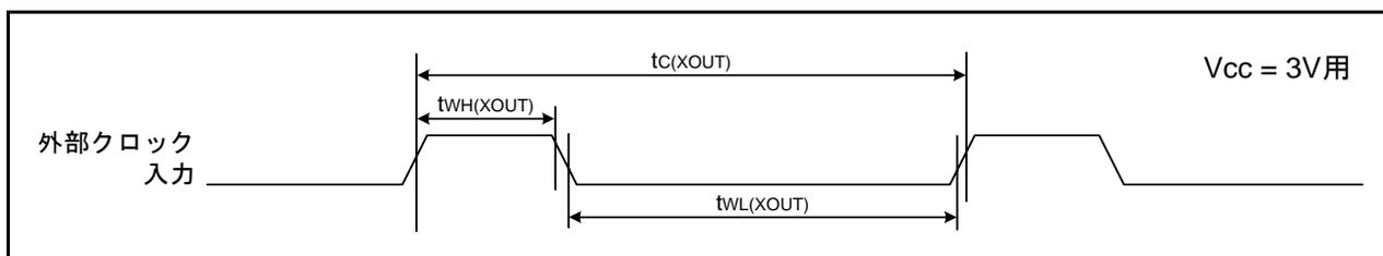
図5.8  $V_{CC} = 3V$ 時の外部クロック入力のタイミング
