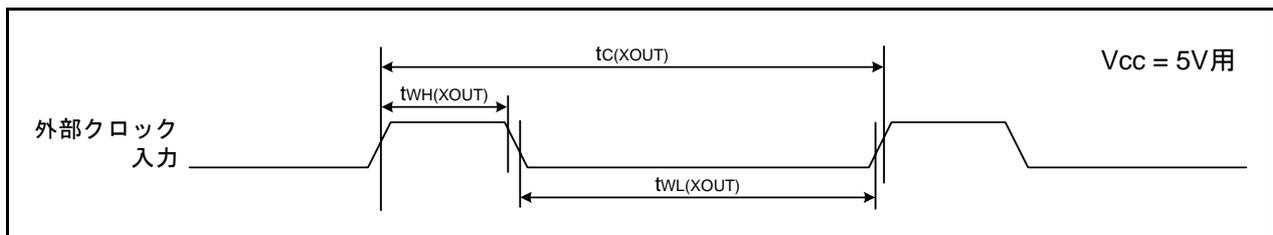
図5.4  $V_{CC} = 5V$ 時の外部クロック入力のタイミング
