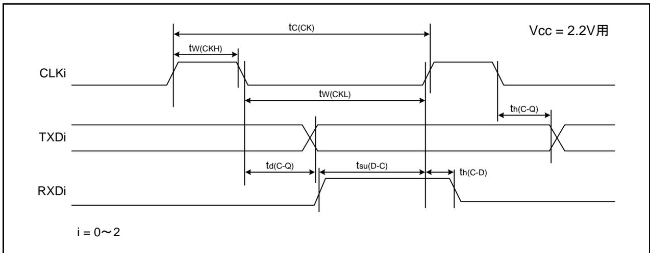
図 5.14  $V_{cc} = 2.2\text{V}$ 時のシリアルインタフェースのタイミング表 5.30 外部割り込み  $\overline{\text{INT}}_i$  入力 ( $i = 0 \sim 3$ )、キー入力割り込み  $\overline{\text{Kli}}$  ( $i = 0 \sim 3$ )
