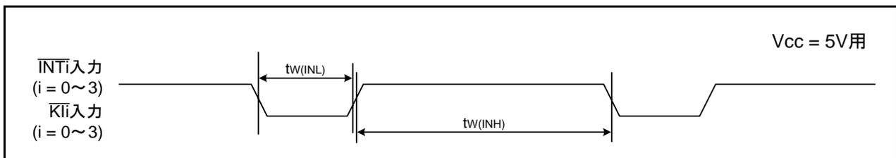
図5.7 Vcc = 5V時の外部割り込みINTiおよびキー入力割り込みKli入力のタイミング
