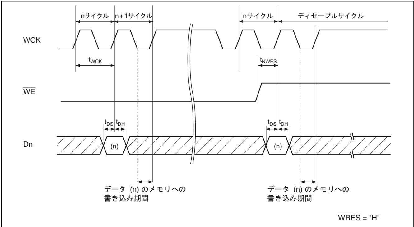
$n$  サイクルの入力データ  $D_n$  は、 $n$  サイクルの WCK のうしろの立ち上がりエッジで取り込まれ、 $n+1$  サイクルの WCK の "L" 期間で書き込み動作を開始し、 $n+1$  サイクルのうしろの立ち上がりエッジで書き込み動作を完了します。
