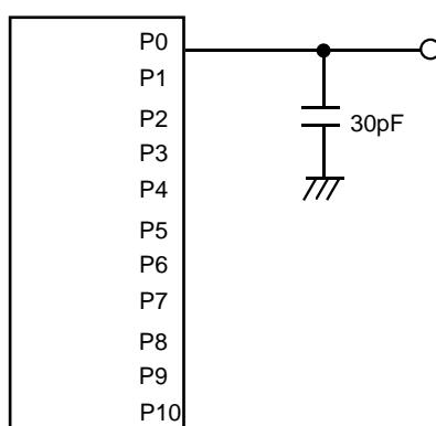
図1.23.1. ポートP0~P10の測定回路
