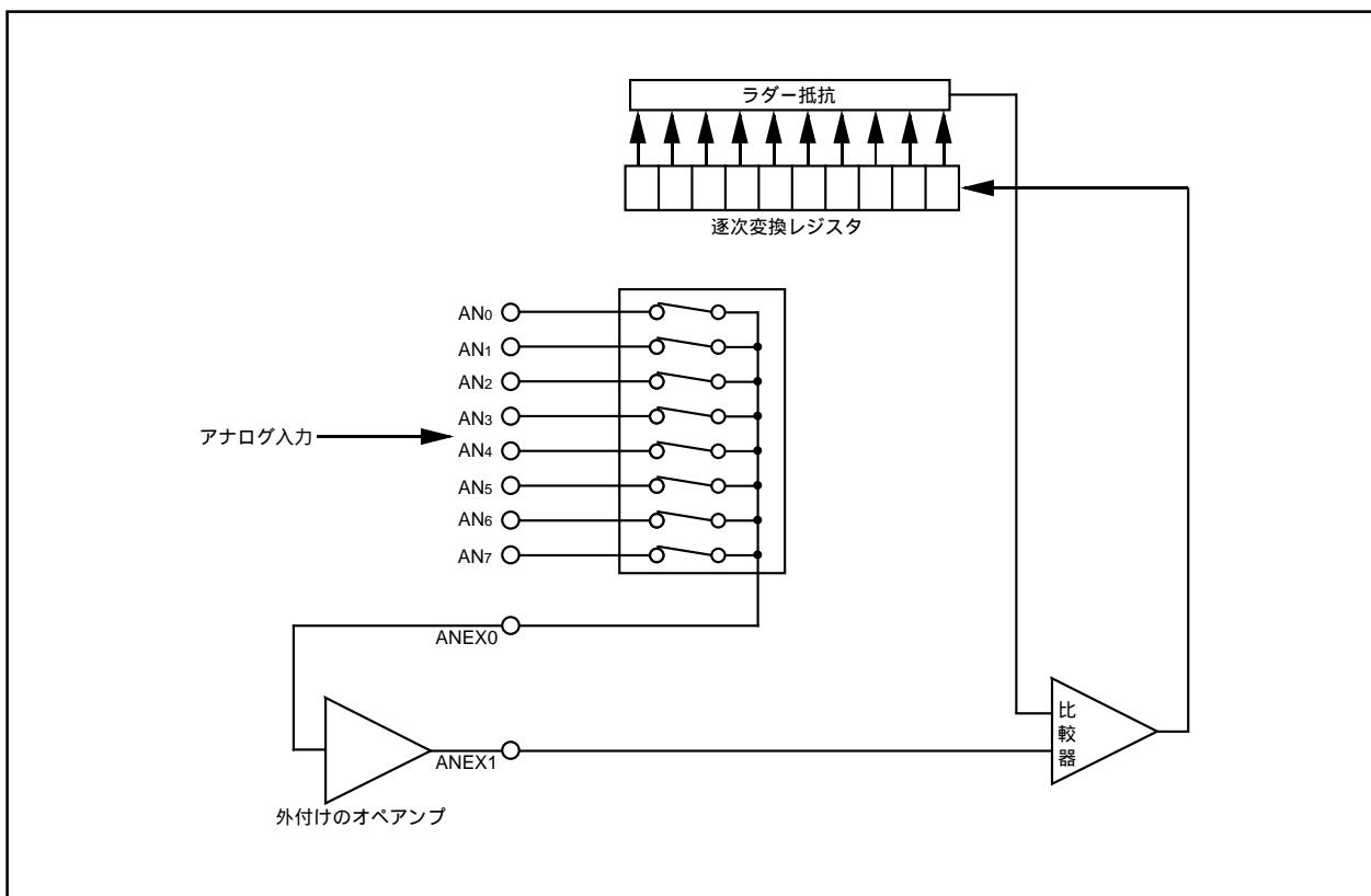
図1.17.9. 外部オペアンプ接続モードの接続例
