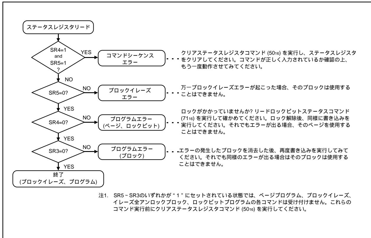
図1.26.8. フルステータスチェックフローチャートおよび各エラー発生時の対処方法
