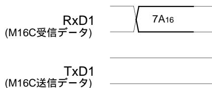
図1.29.31. ロックビット有効コマンド時のタイミング
