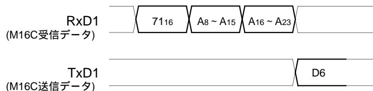
図1.29.30. リードロックビットステータスコマンド時のタイミング
