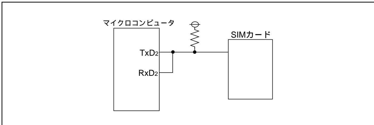
図1.16.25. SIMインターフェース接続例
