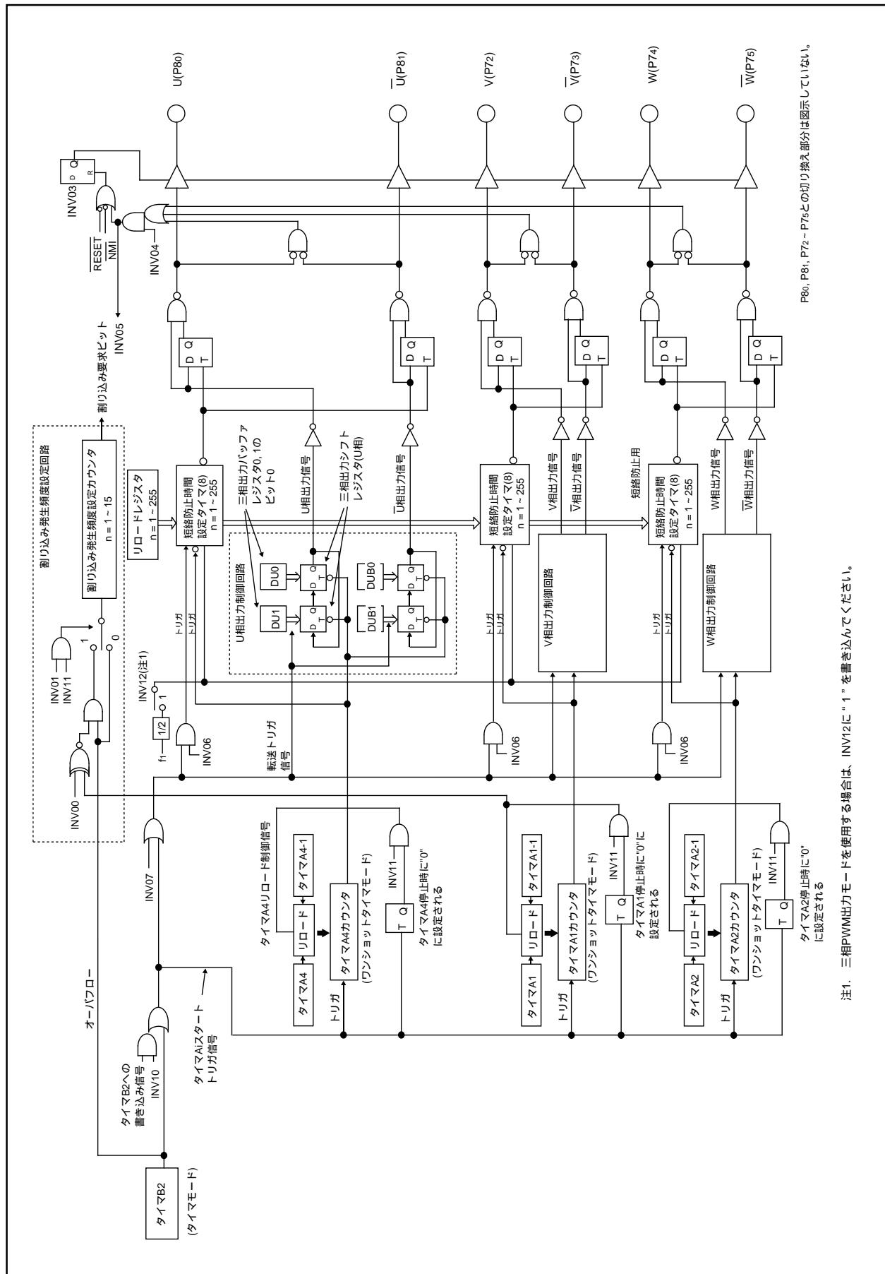
図1.15.5. 三相PWM出力モードのブロック図
