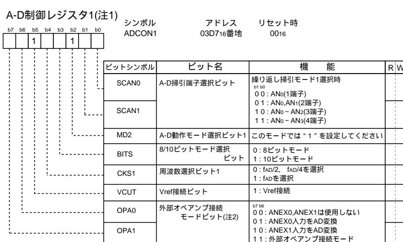
図1.17.8. 繰り返し掃引モード1時のA-D制御レジスタ
