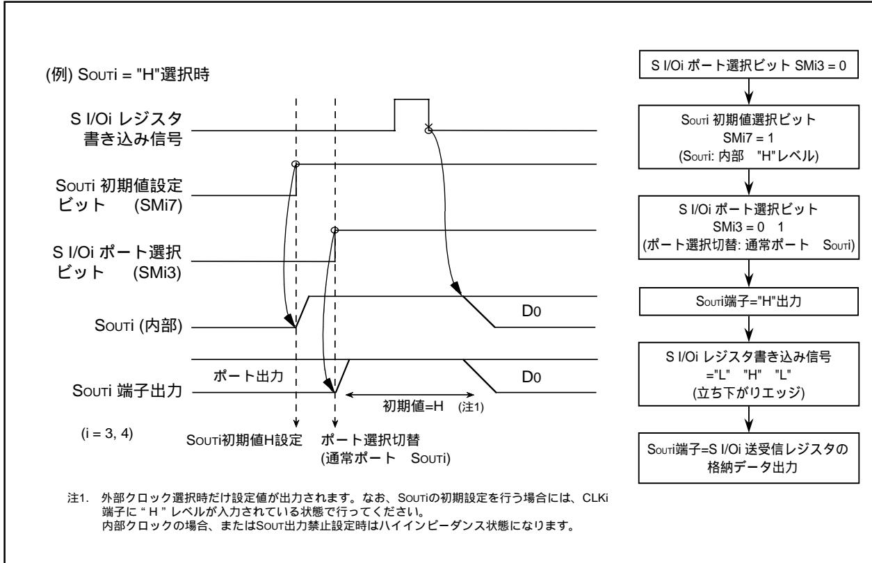
図1.16.33. SOUT<sub>i</sub>初期値設定時のタイミング図および設定方法
