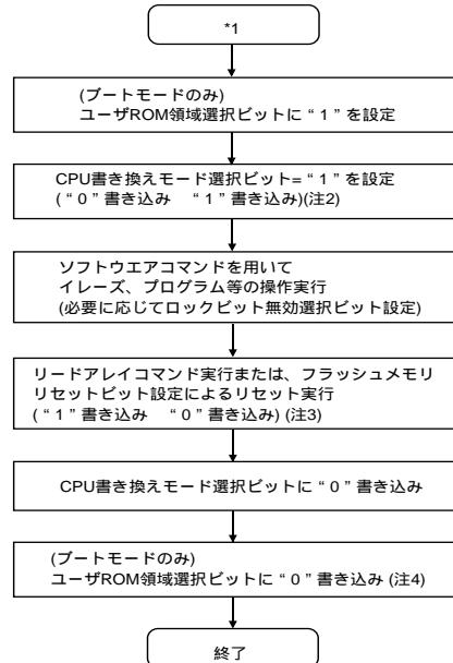
図1.26.2. CPU書き換えモードの設定/解除フローチャート
