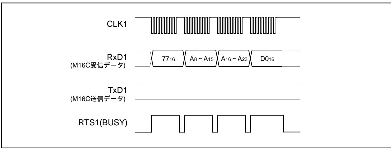
図1.29.9. ロックビットプログラムコマンド時のタイミング
