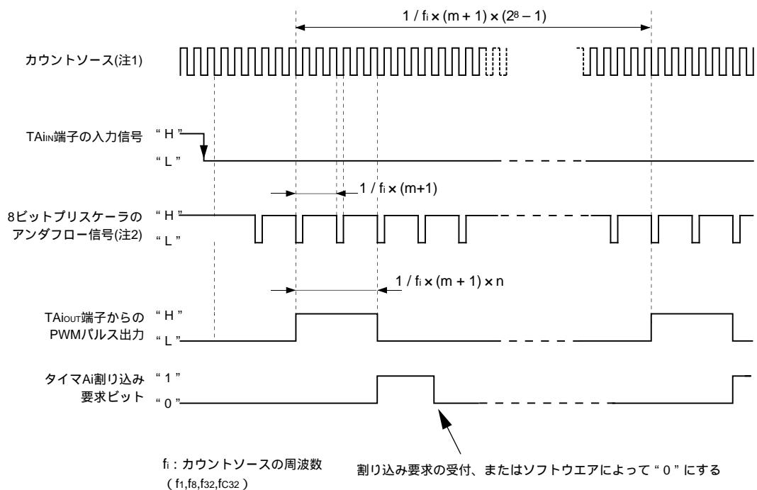
図1.14.13. 8ビットパルス幅変調器の動作例
