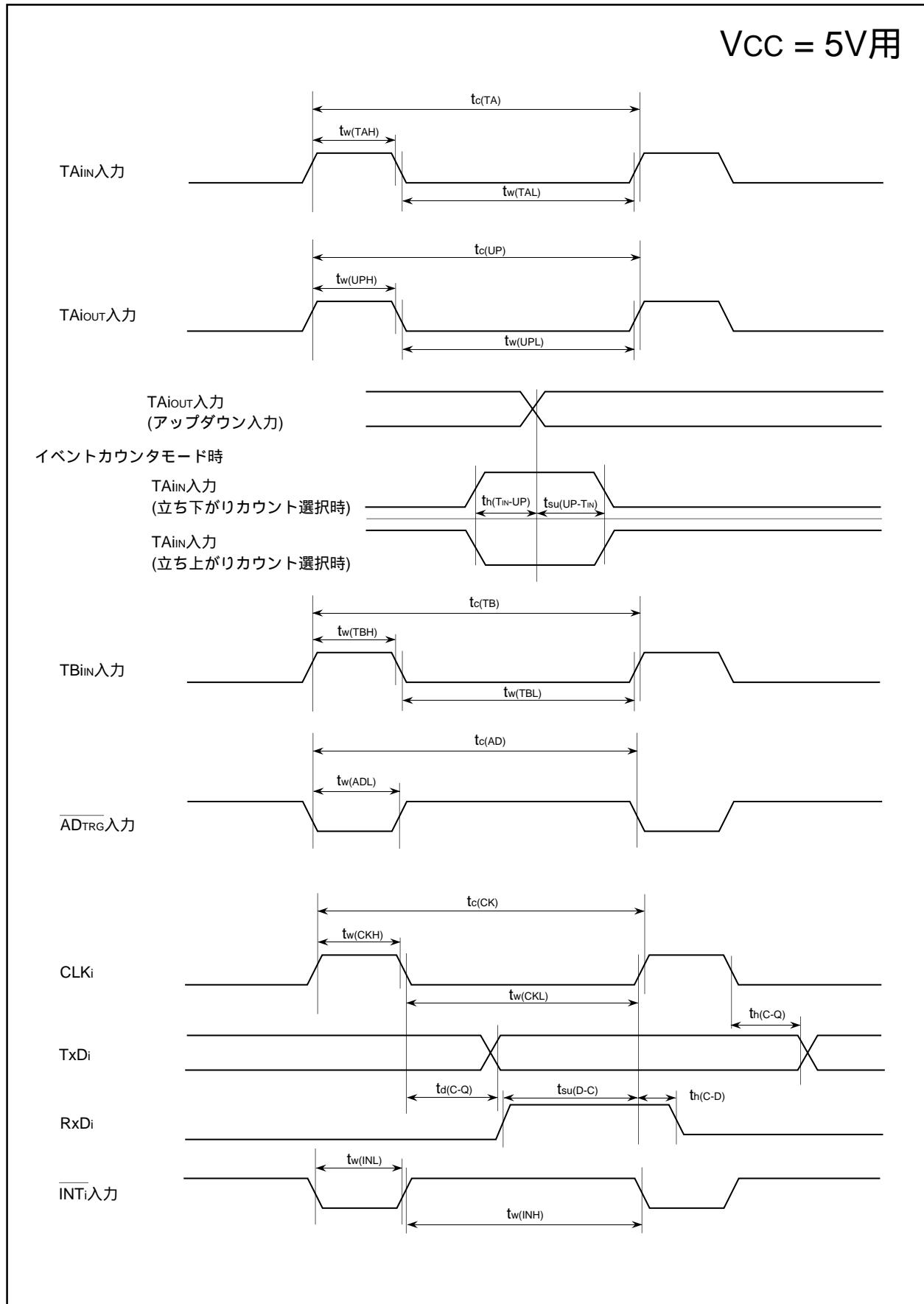
図1.23.2.  $V_{CC}=5V$ 用タイミング図(1)
