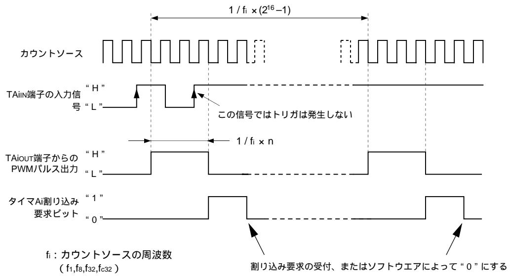
図1.14.12. 16ビットパルス幅変調器の動作例
