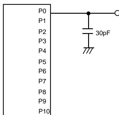
図1.23.7. ポートP0~P10の測定回路
