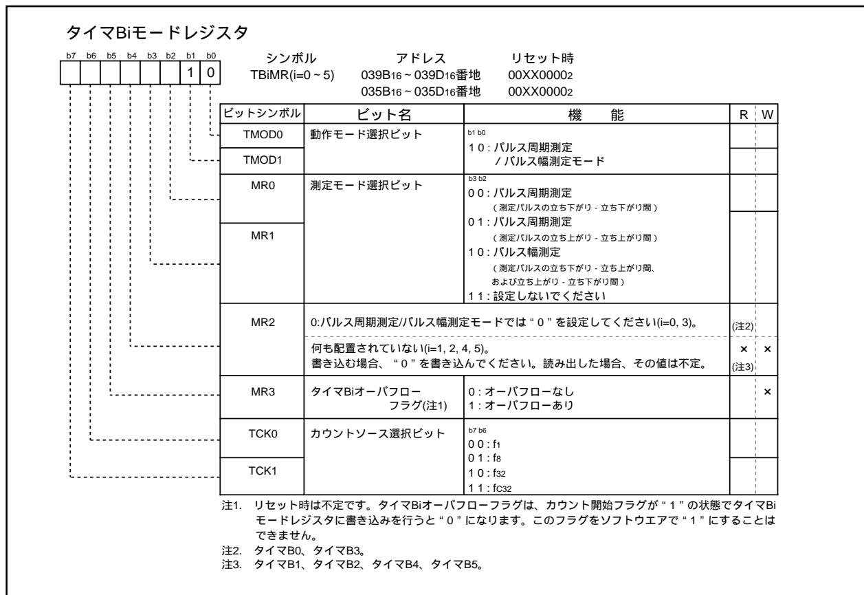
図1.14.19. パルス周期測定 / パルス幅測定モード時のタイマBiモードレジスタの構成
