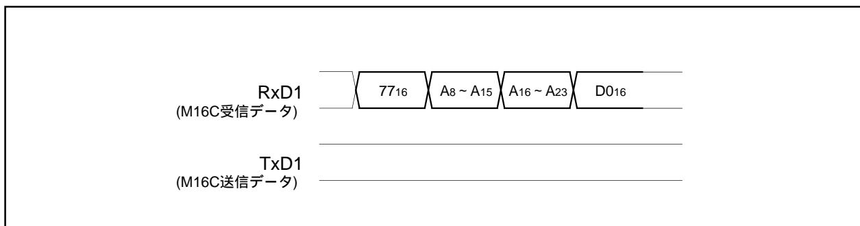
図1.29.29. ロックビットプログラムコマンド時のタイミング
