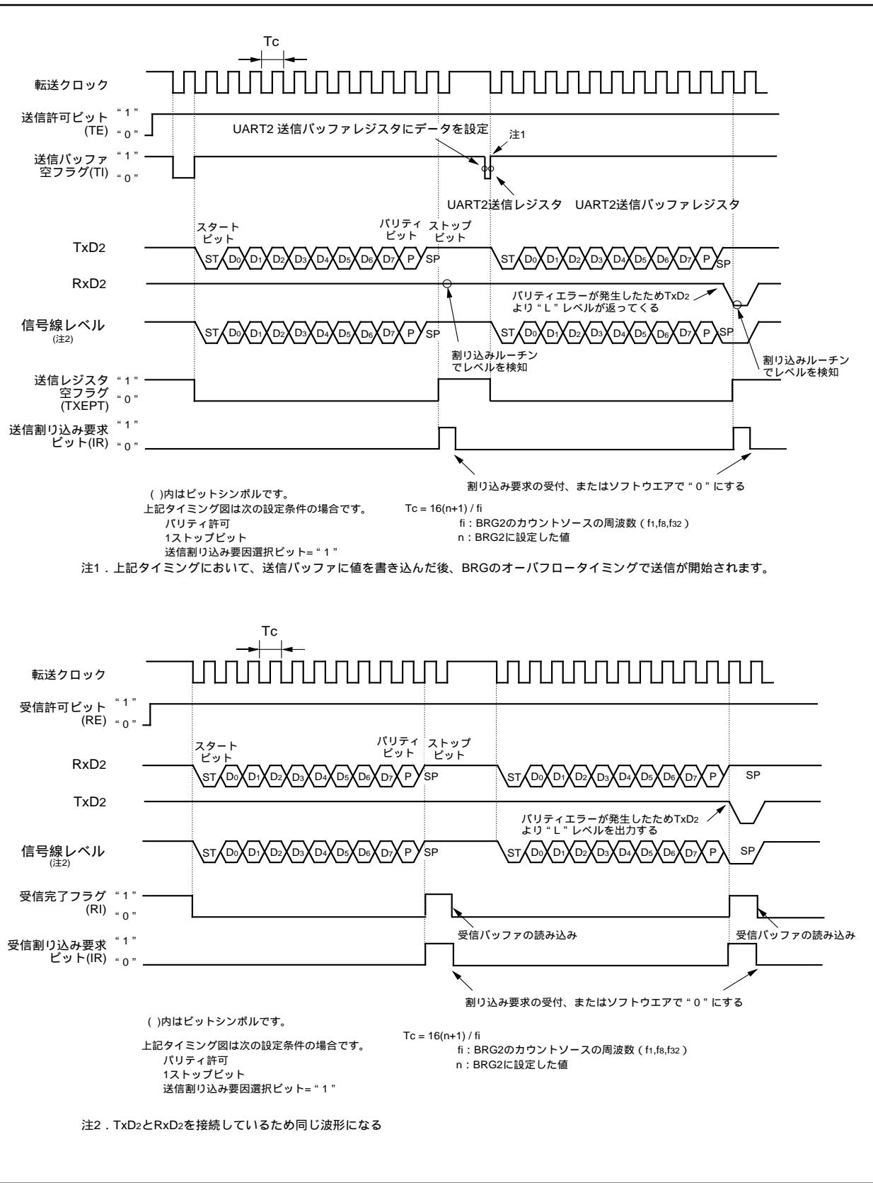
図1.16.22. UARTモード(SIMインターフェース対応)の送受信タイミング例
