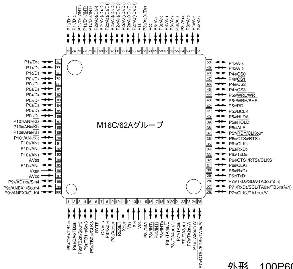
図1.1.2. ピン接続図(上面図)
