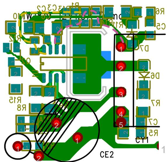
Figure 10.10b : V<sub>SENSE</sub> Feedback Layout Path
