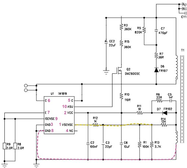
Figure 10.10a : V<sub>SENSE</sub> Feedback Path
