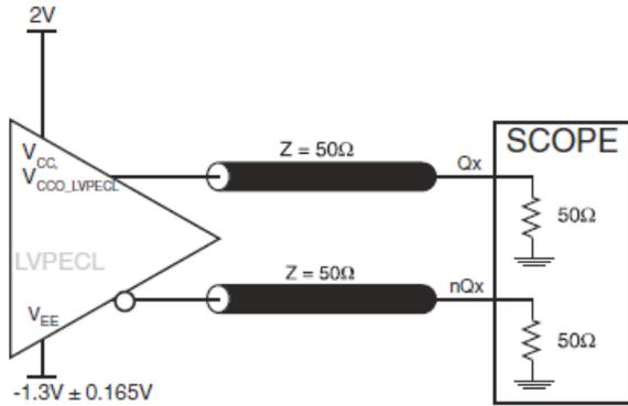
3.3V LVPECL OUTPUT LOAD AC TEST CIRCUIT
