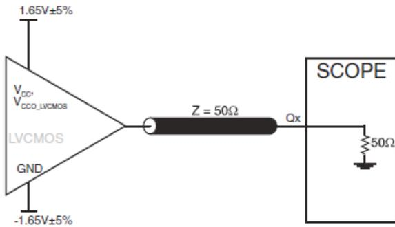
3.3V LVCMOS OUTPUT LOAD AC TEST CIRCUIT
