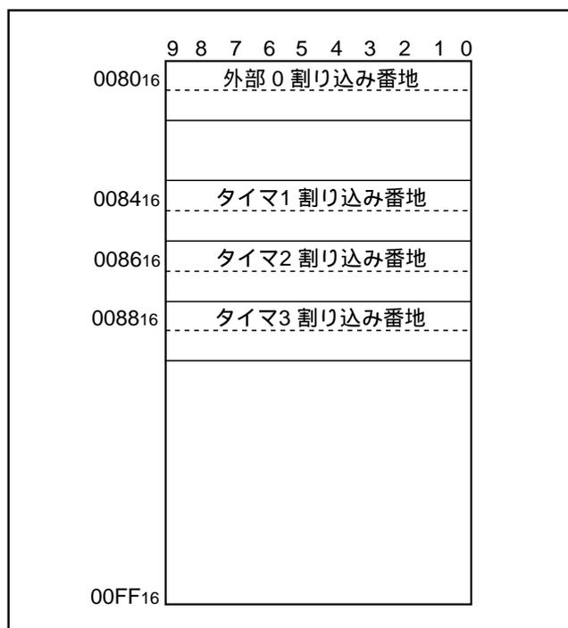
図BC-2 . 割り込み番地ページ(0080<sub>16</sub>~00FF<sub>16</sub>)の構成
