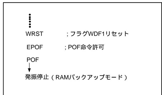
図FB-5. ウォッチドッグタイマ使用時におけるRAMバックアップモードへの移行プログラム例
