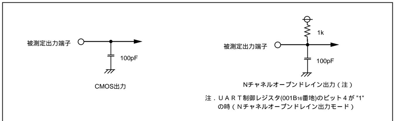
図69．出力スイッチング特性の測定回路図
