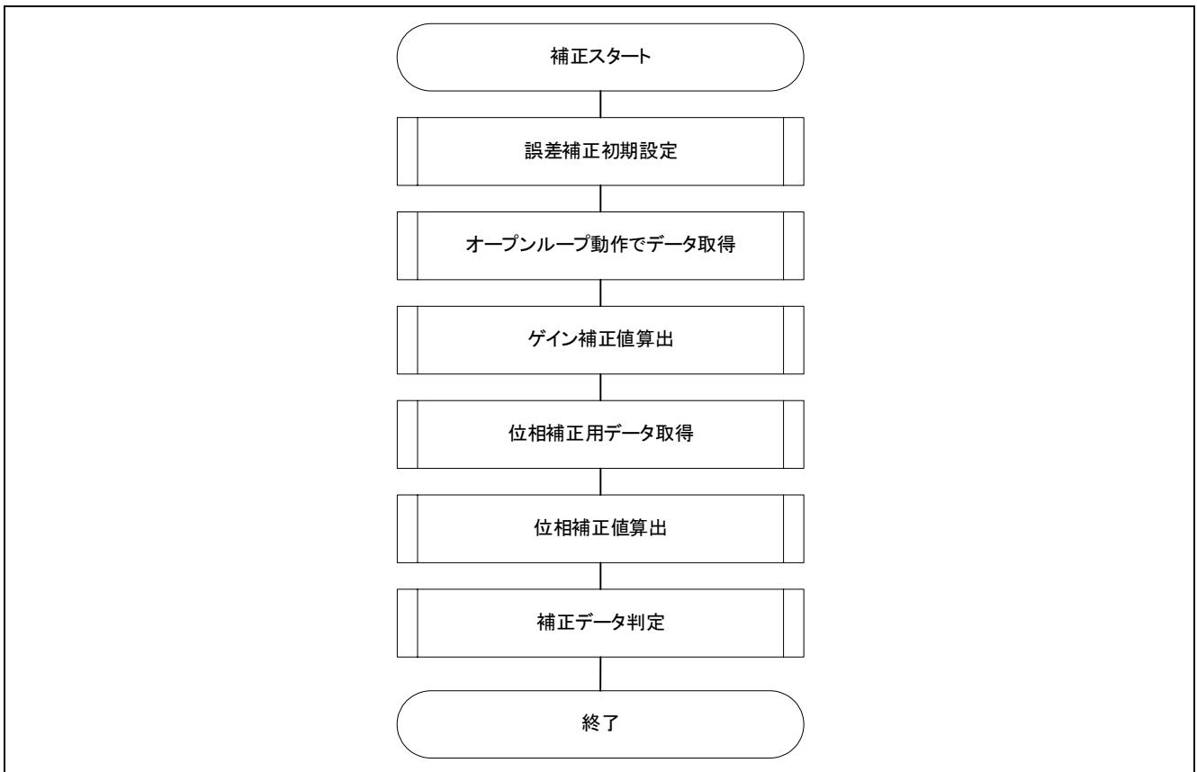
図 5-20 誤差補正処理フローチャート
