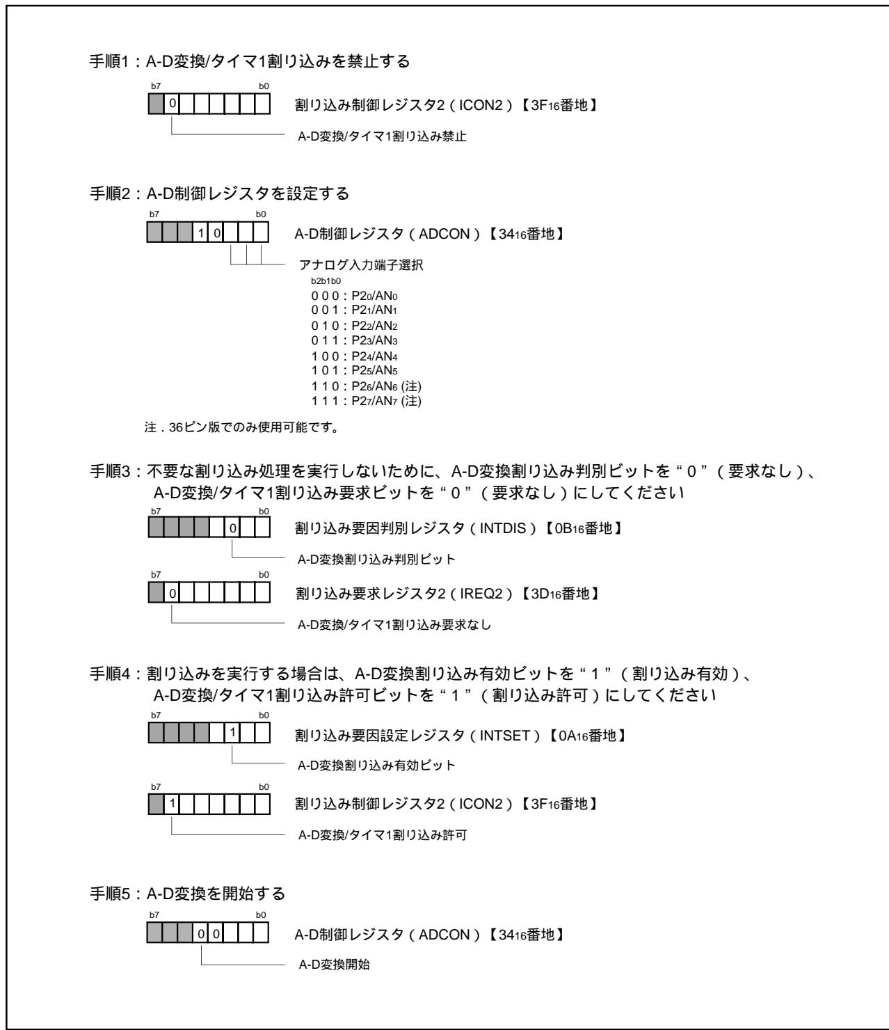
図1 . A-D変換器の設定方法
