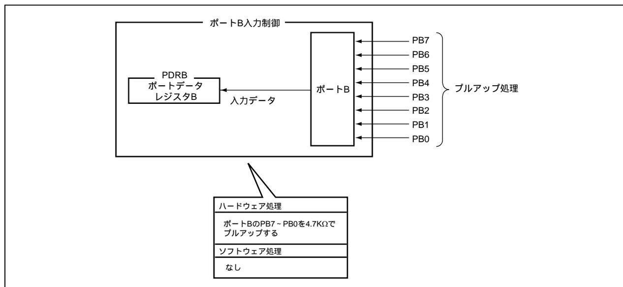
図 3.3 入力専用端子（例：ポート B）空き端子処理動作説明
