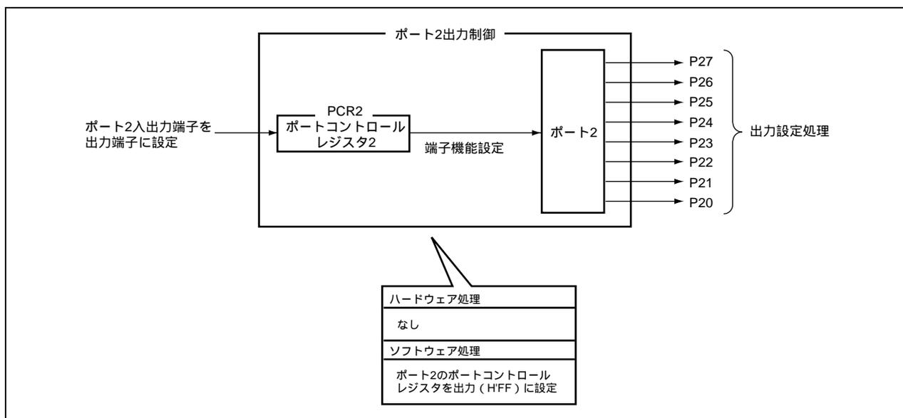
図 3.2 汎用入出力端子（例：ポート 2）空き端子処理動作説明
