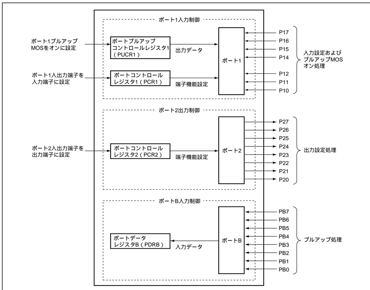
図 2.1 ポート 1、ポート 2 およびポート B 空き端子処理設定ブロック図
