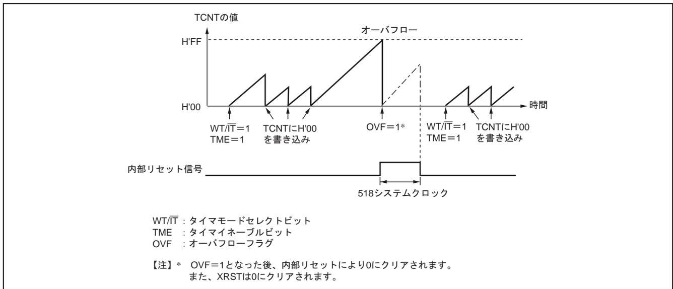
図2 ウォッチドッグタイマモード時 ( $\overline{RST}/\overline{NMI}=1$ ) の動作
