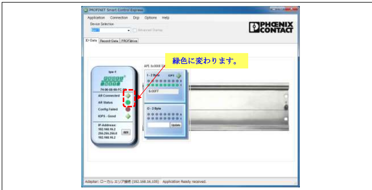
図 12.2.4 PROFINET Smart Control Express の立ち上げ 4
