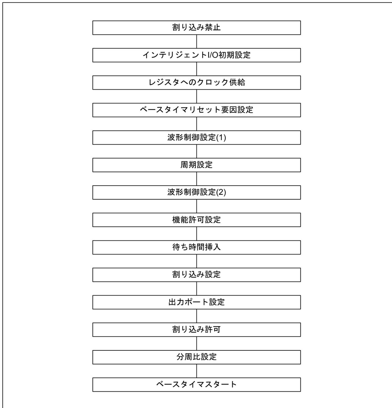
図2. インテリジェントI/O設定(単相波形出力)の概略フロー
