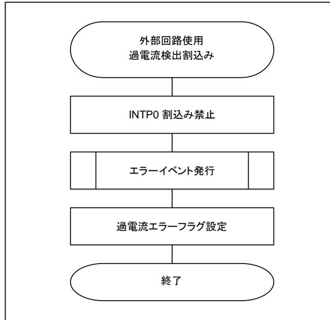
図 3-10 過電流検出割り込み処理フローチャート（外部回路使用時）
