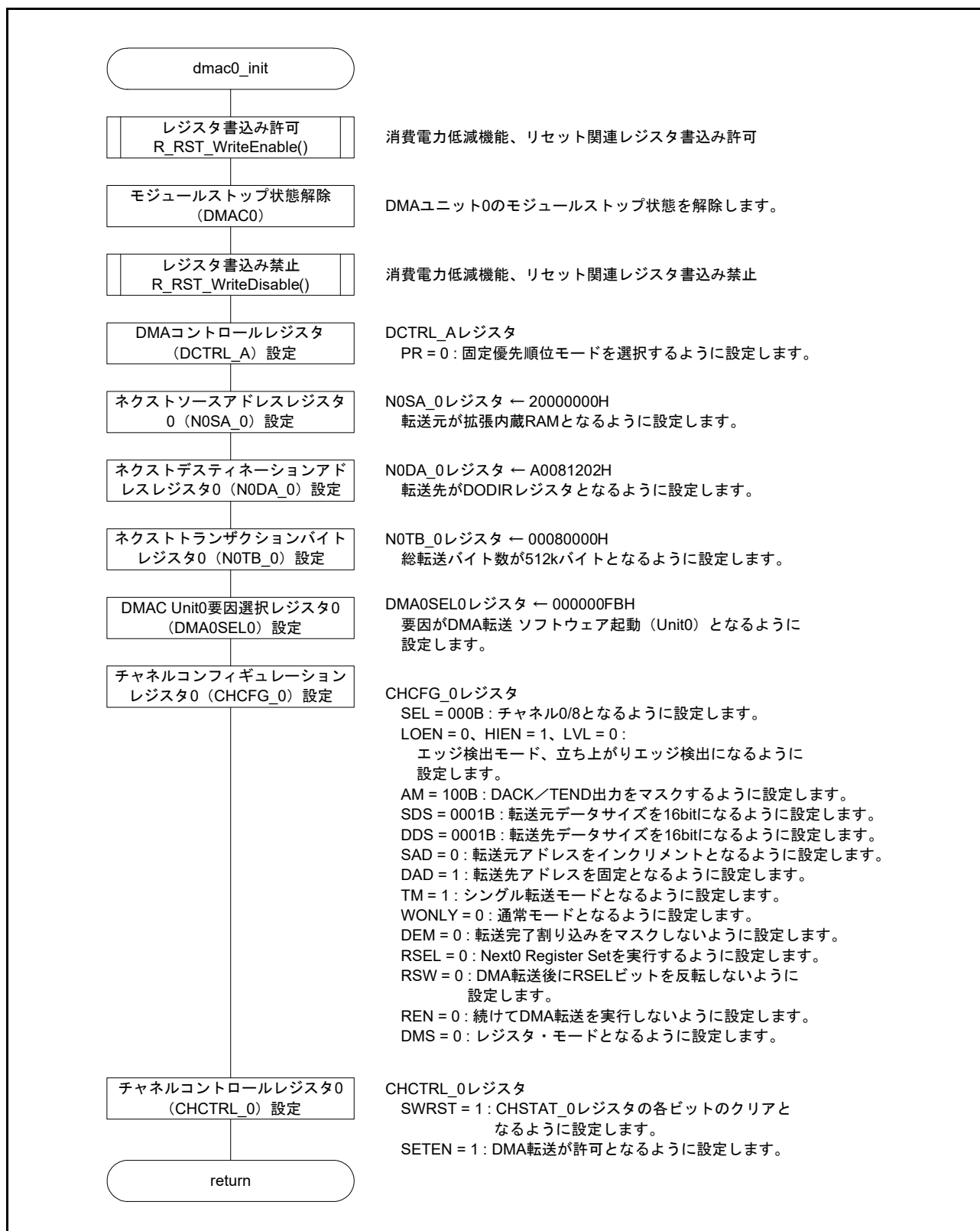
図 6.8 DMA コントローラ初期化処理
