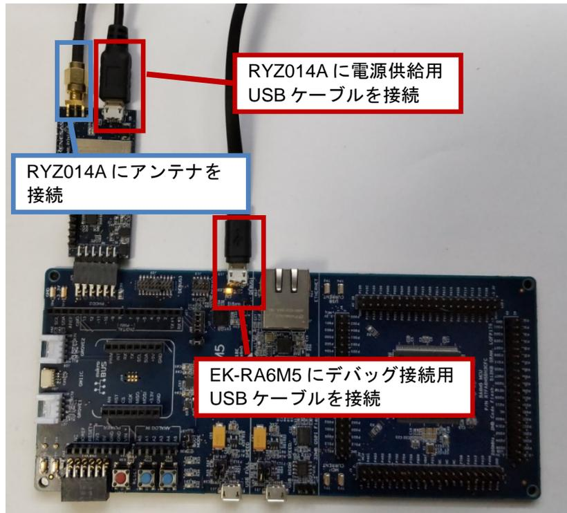
図 2.2 USB ケーブルとアンテナの接続
