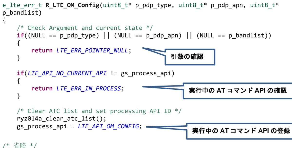
図 4.4 R\_LTE\_OM\_Config の引数確認・実行中の AT コマンド API の確認 (r\_lte\_ryz014a.c)
