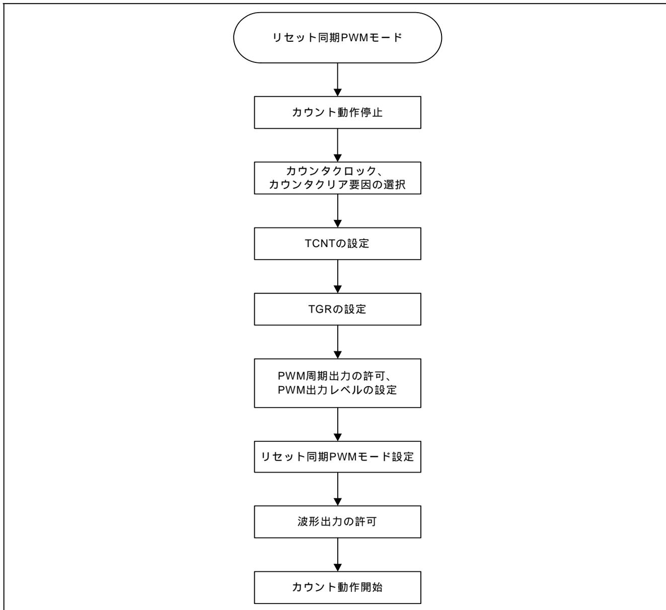
図2.2 リセット同期 PWM モードの設定手順の例
