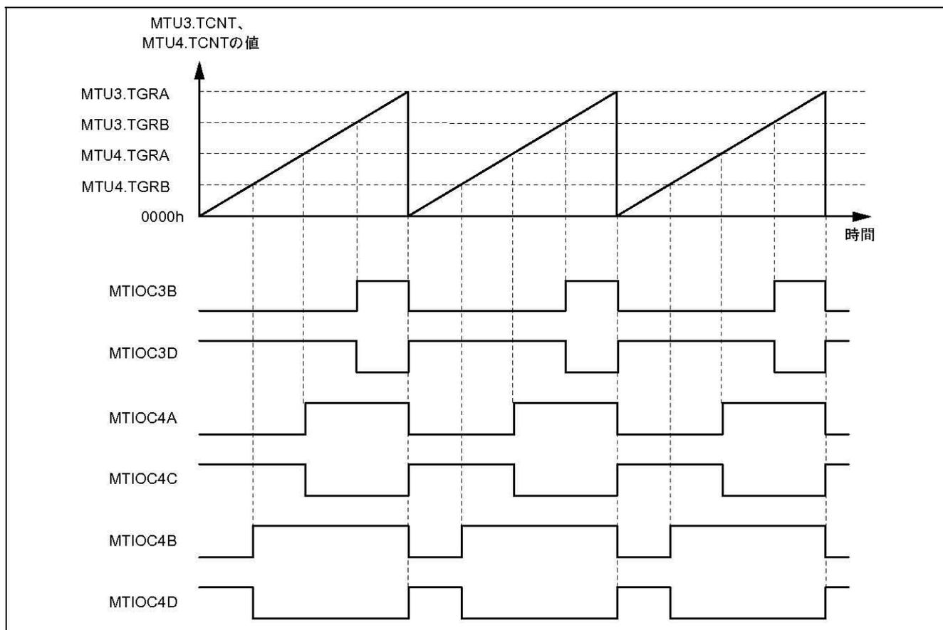
図2.1 リセット同期 PWM モードの動作例
