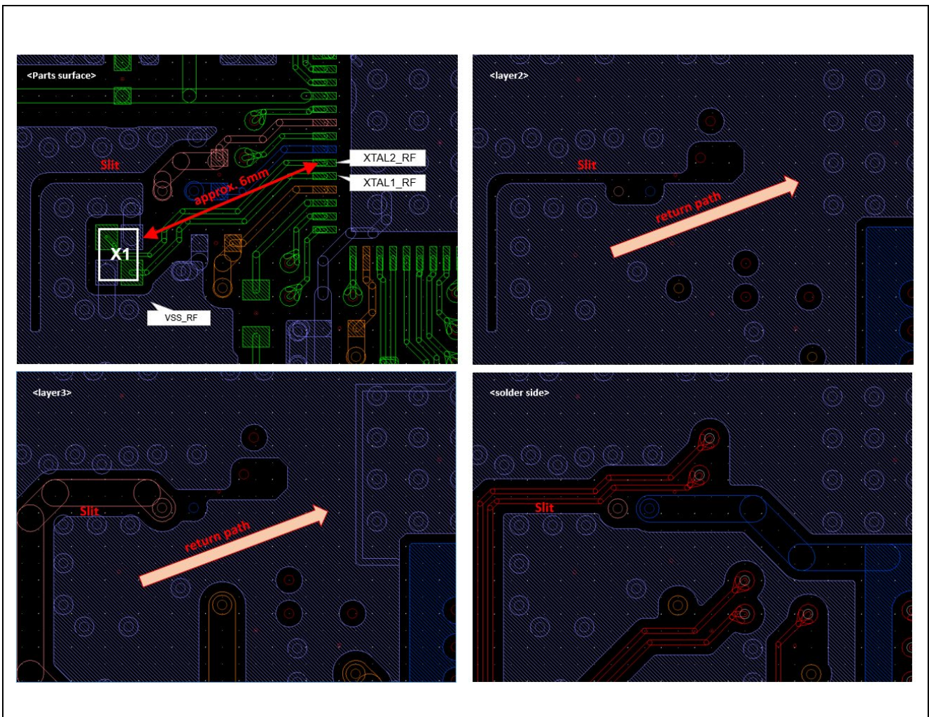
図 2-2 水晶振動子周辺のパターン例
